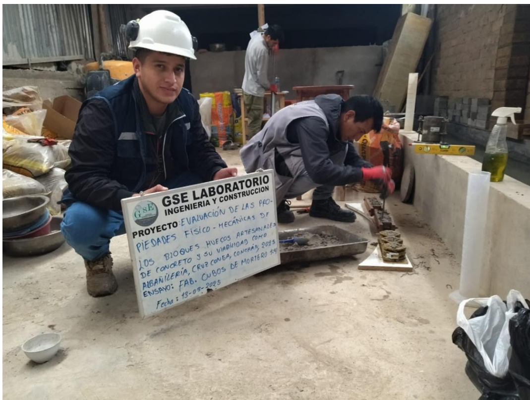
Fotografía 24. Elaboración de los cubos de mortero.
