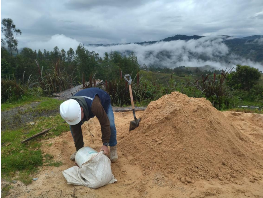
Fotografía 2. Recolección de muestra en la cantera de confitillo
