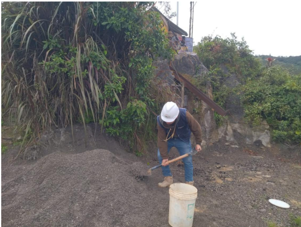
Fotografía 2. Recolección de muestra en la cantera de confitillo
