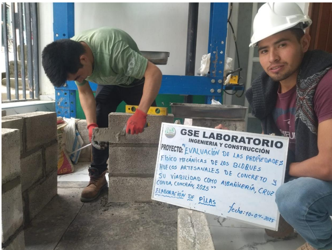
Fotografía 30. Elaboración de pilas.
