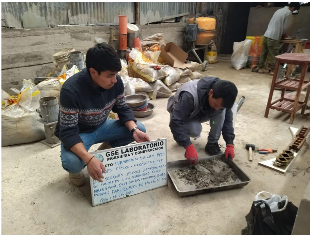
Fotografía 24. Elaboración de los cubos de mortero.
