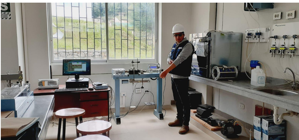
Fotografía 23. Preparación del equipo de corte directo
