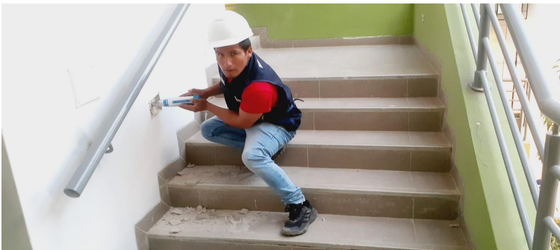
Fotografía 11. Tesistas realizando el ensayo de esclerometría en el edificio de contabilidad
