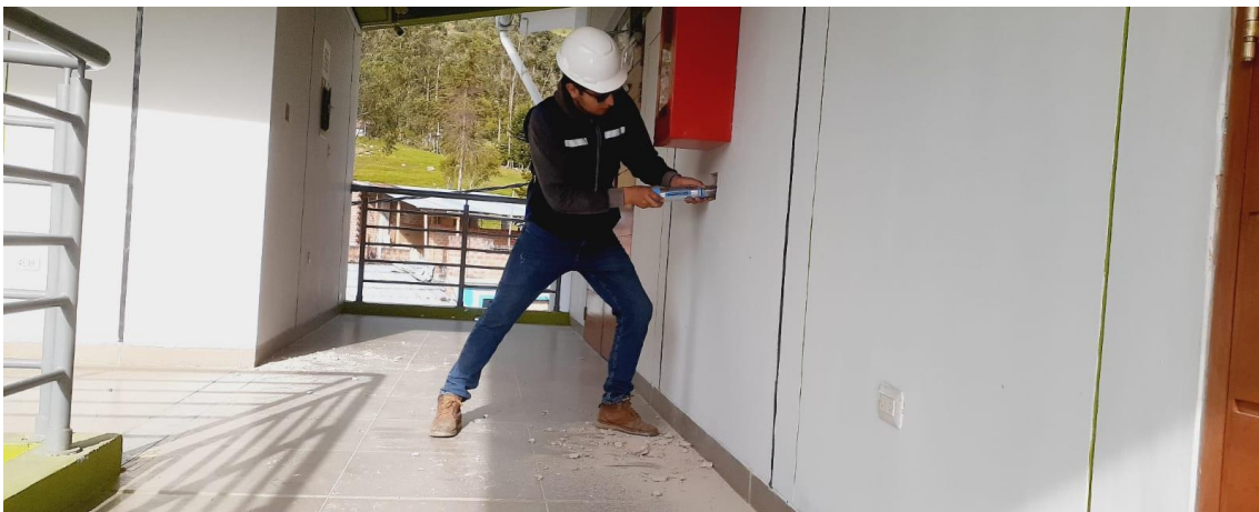
Fotografía 8. Ensayo de esclerometría en la escalera del pabellón de contabilidad
