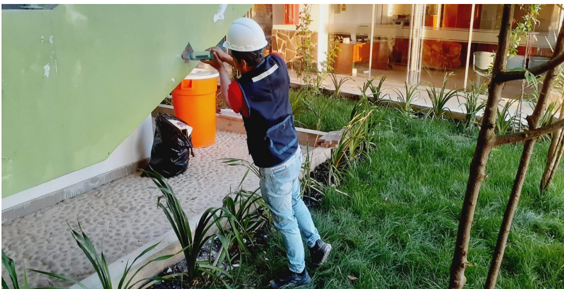
Fotografía 8. Ensayo de esclerometría en la escalera del pabellón de contabilidad
