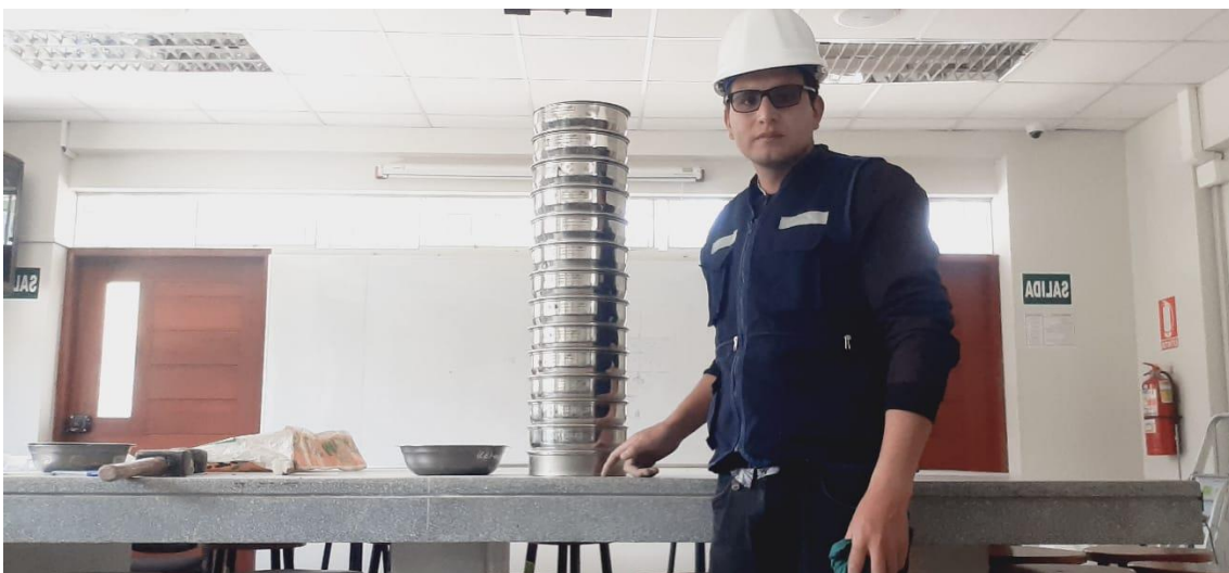
Fotografía 17. Realización del análisis granulométrico
