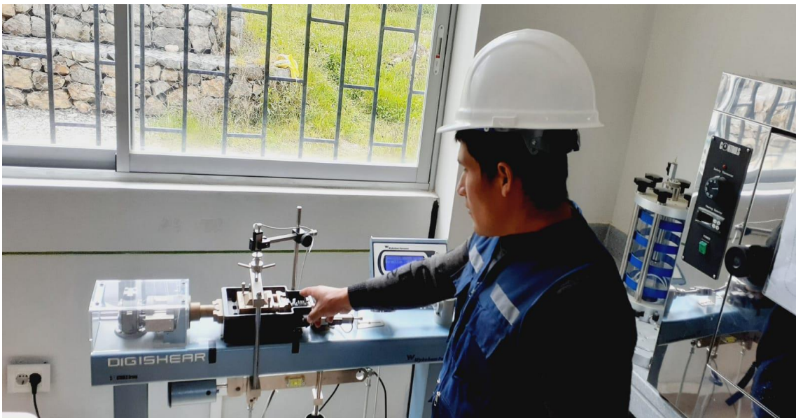
Fotografía 25. Vista de la muestra del ensayo de corte directo
