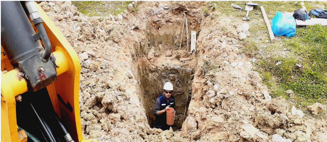
Fotografía 13. Testistas en la Calicata para Estudio de mecánica de suelos
