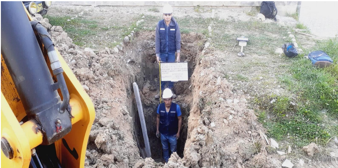
Fotografía 14. Toma de muestras de suelo de una cubica en la calicata de estudio
