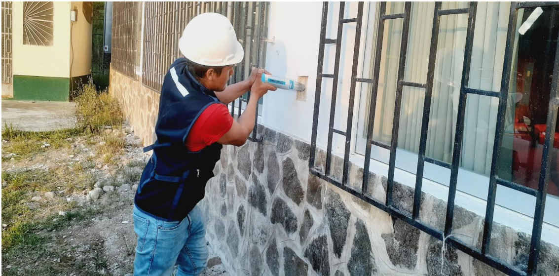
Fotografía 10. Ensayo de esclerometría en la escalera el pabellón de contabilidad
