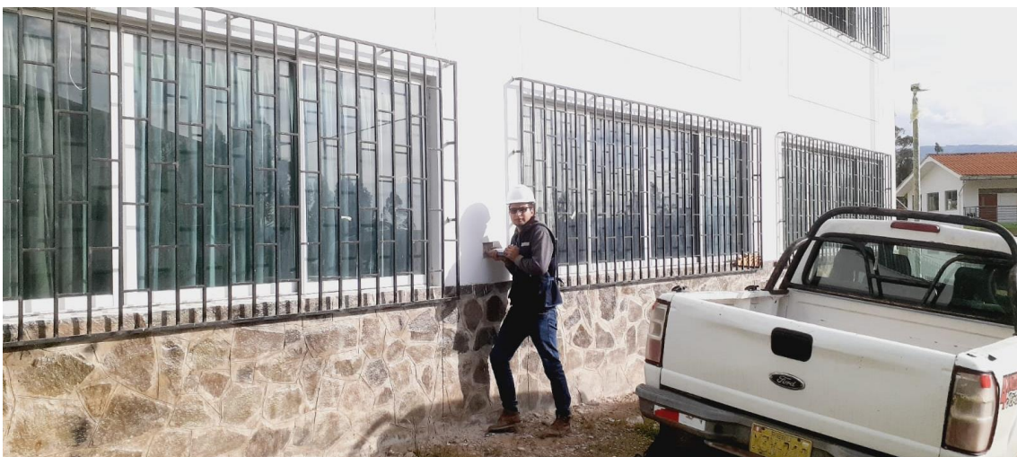
Fotografía 5. Ensayo de esclerometría en la viga del pabellón de contabilidad
