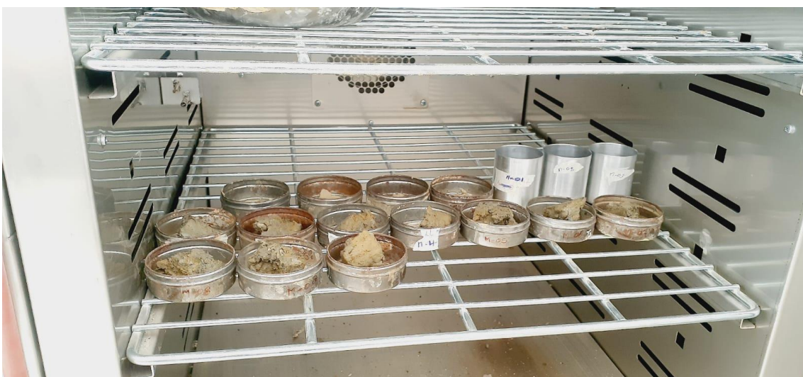
Fotografía 20. Colocación de muestras de suelo al horno para determinar su humedad
