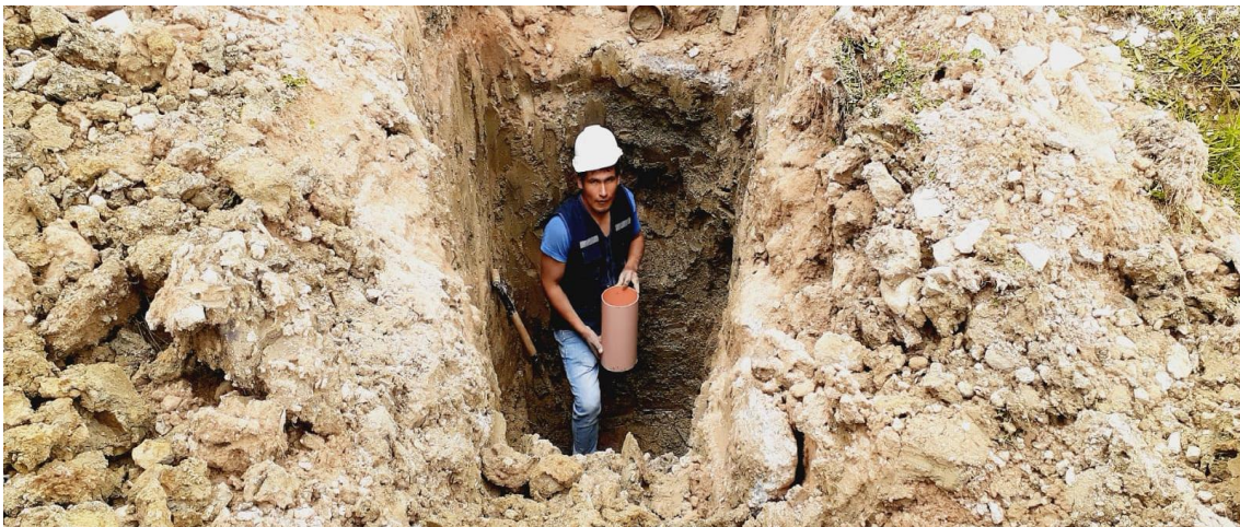
Fotografía 14. Toma de muestras de suelo de una cubica en la calicata de estudio
