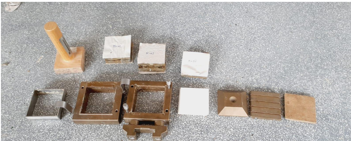
Fotografía 23. Preparación del equipo de corte directo
