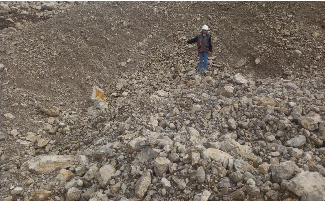
Fotografía 3. Tesista recolectando las muestras de suelo alterado en sacos para su traslado al laboratorio
