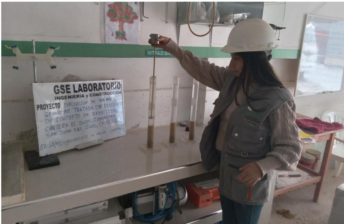
Fotografía 9. Ensayos de límites de consistencia en el suelo natural
