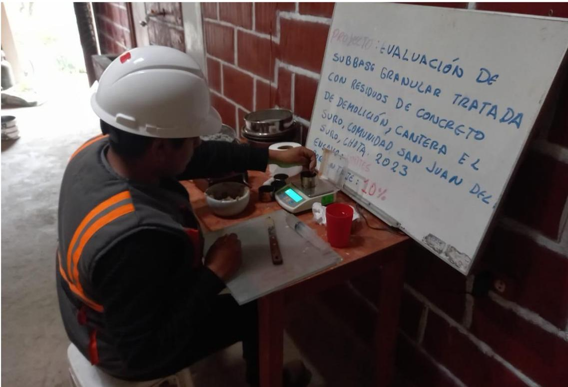
Fotografía 11. Ensayo de límite líquido del suelo con residuos de concreto
