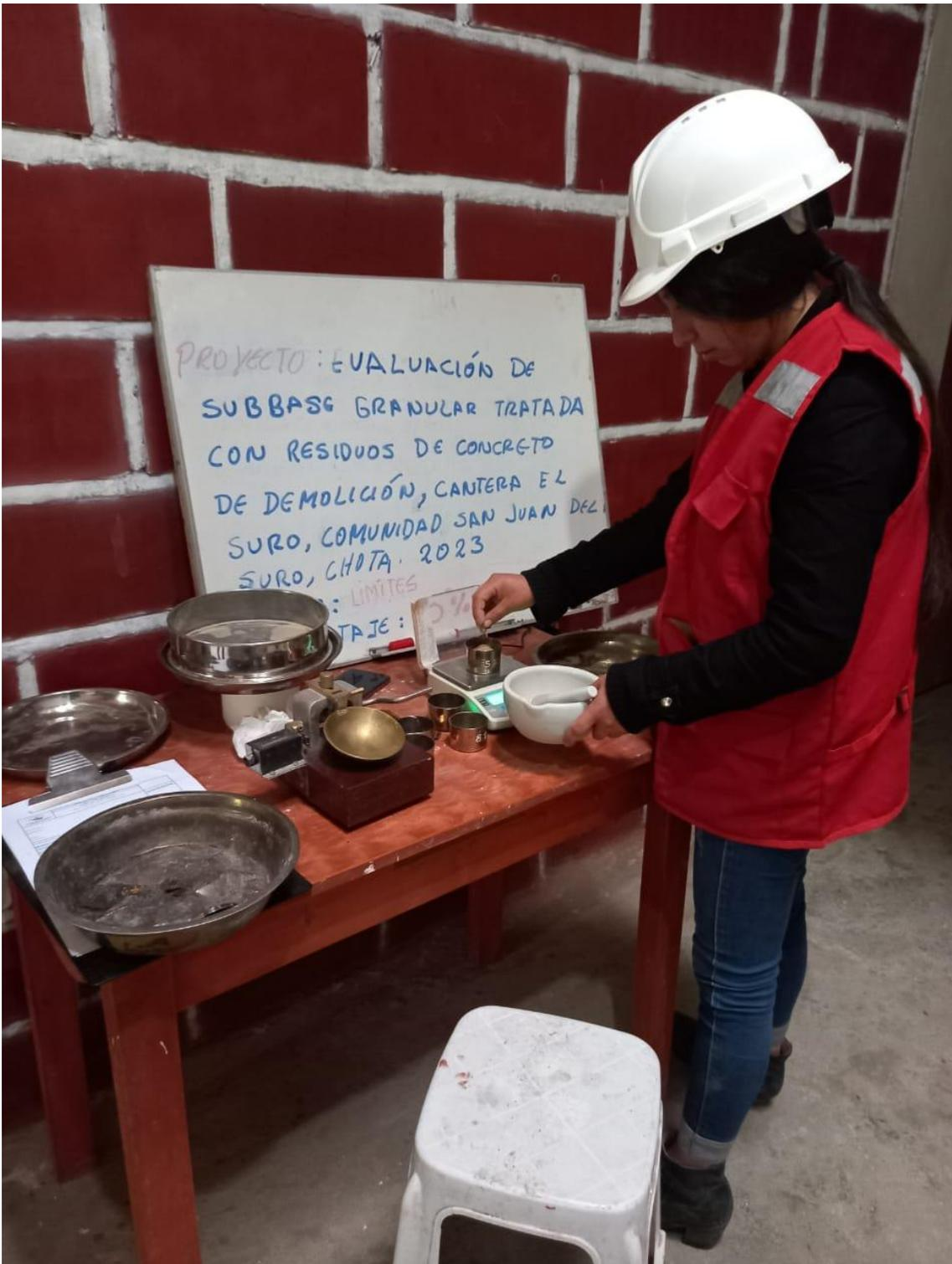
Fotografía 10. Ensayo de límite plástico del suelo con residuos de concreto
