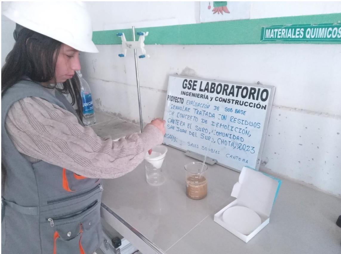
Fotografía 8. Ensayo de equivalente de arena en el suelo de la cantera
