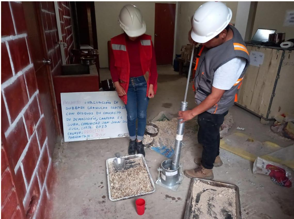
Fotografía 18. Ensayo de CBR al suelo de la cantera con residuos de concreto
