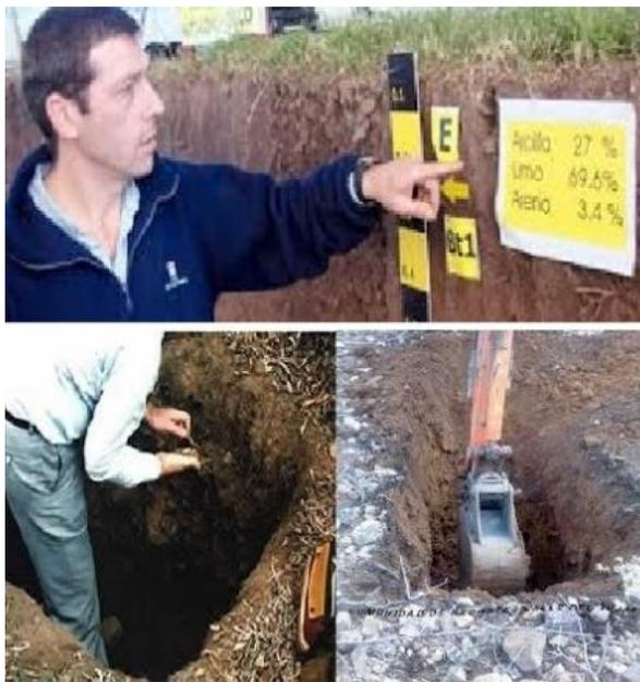
Nota: En la parte superior se muestra el perfil estratigráfico, en la inferior izquierda la toma de muestra y a la derecha se observa la excavación con maquinaria de la calicata (Ticlla, 2021).
