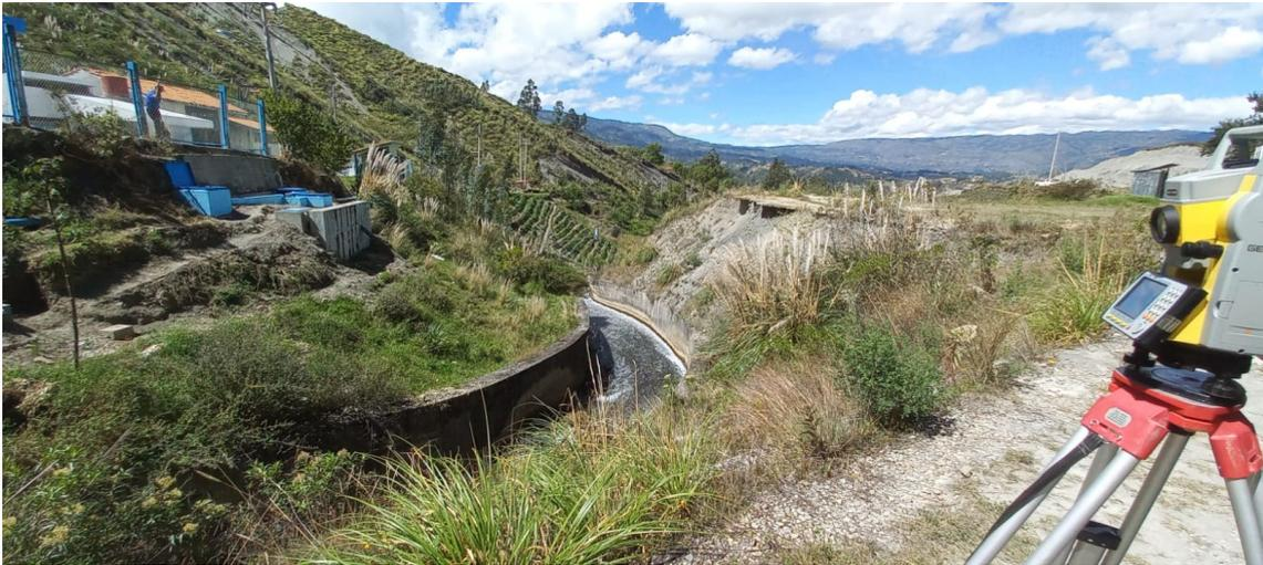
Fotografía 6 Toma de puntos topográfico en el emplazamiento de la rápida hidráulica por parte de los tesistas durante el levantamiento topográfico
