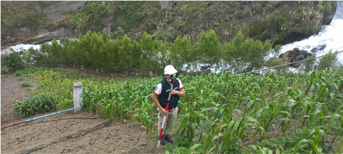
Fotografía 15 Registro de puntos topográfico con la estación total en la rápida hidráulica
