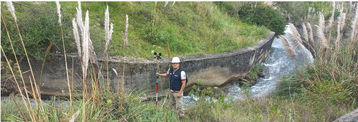
Fotografía 7 Toma de puntos topográficos en el inicio de la rápida hidráulica por parte de los tesistas durante el levantamiento topográfico
