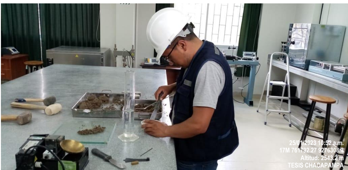
25/01/2023 Tesistas en el laboratorio de suelos de la UNACH, realizando ensayos de limites
