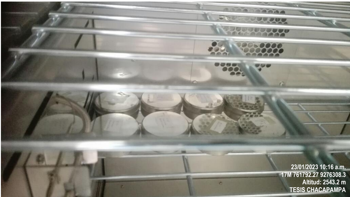
23/01/2023 Tesistas en el laboratorio de suelos de la UNACH, realizando ensayos de contenido de humedad
