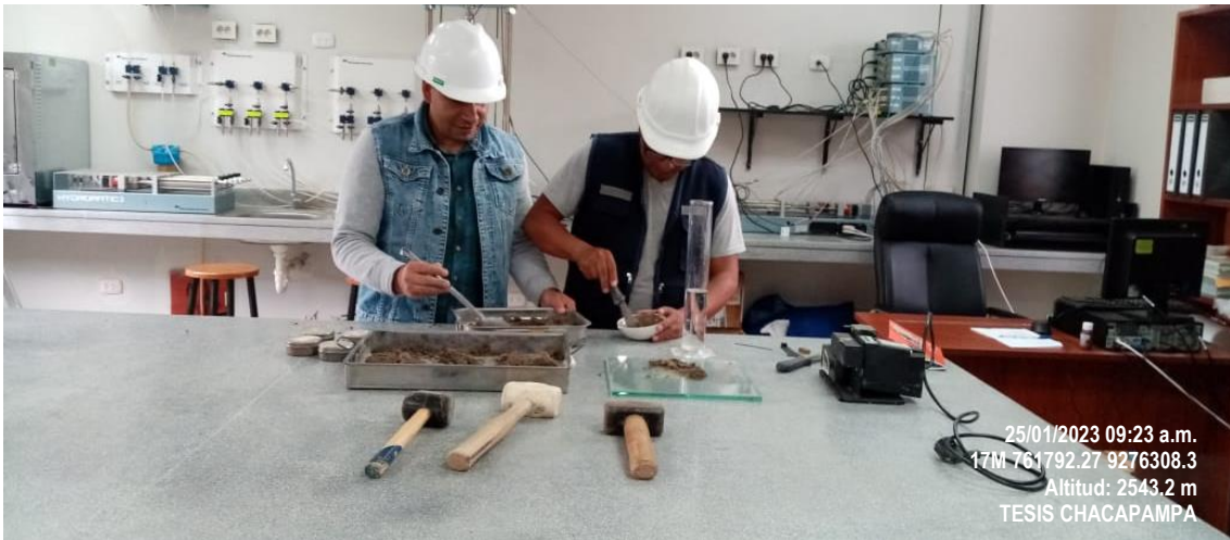
25/01/2023 Tesistas en el laboratorio de suelos de la UNACH, realizando ensayos de limites
