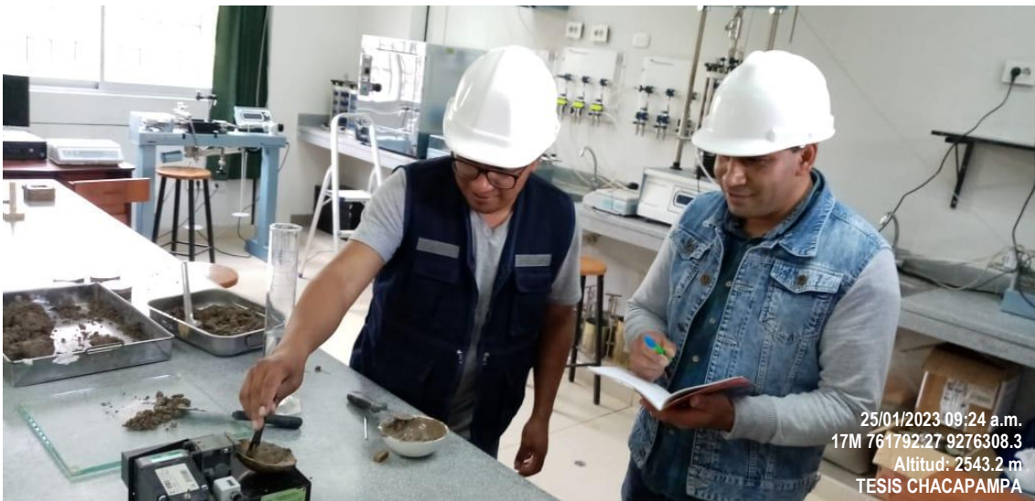
25/01/2023 Tesistas en el laboratorio de suelos de la UNACH, realizando ensayos de limites
