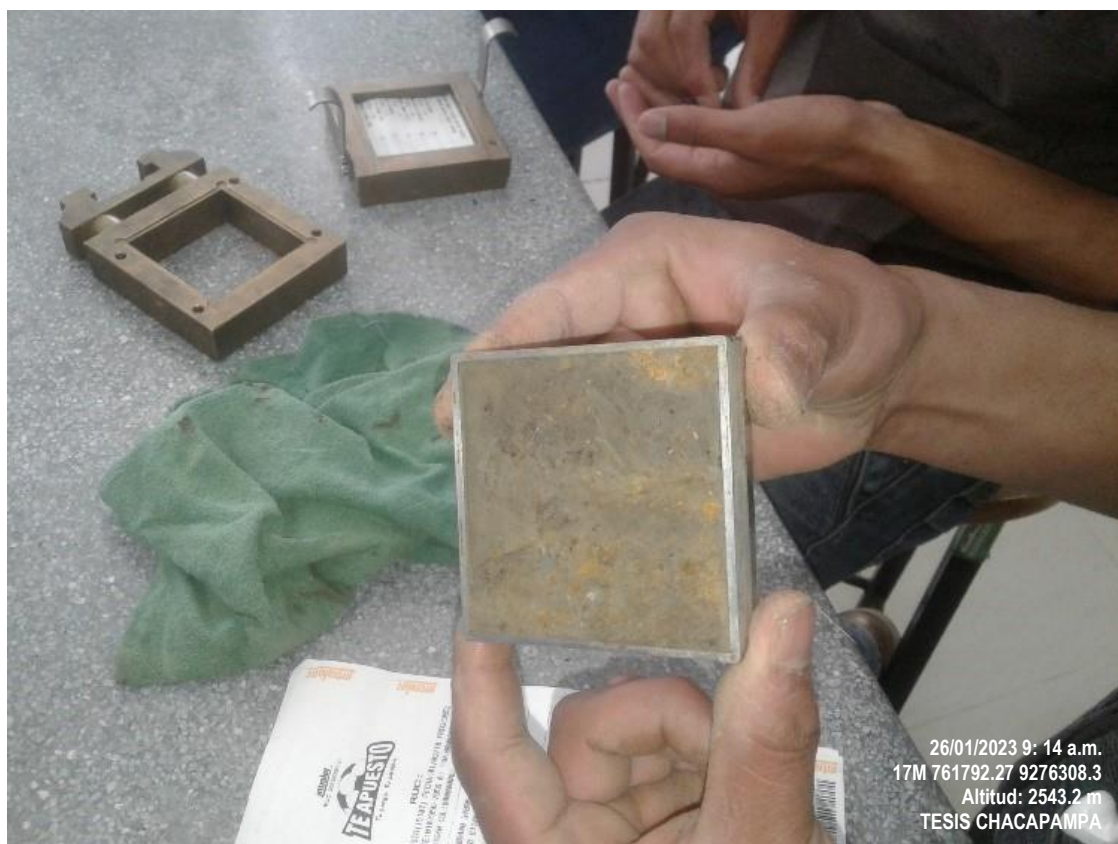
26/01/2023 Tesistas en el laboratorio de suelos de la UNACH, realizando ensayos de corte directo
