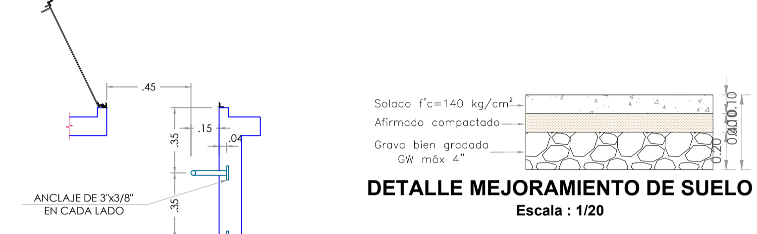
DETALLE MEJORAMIENTO DE SUELO Escala: 1/20
