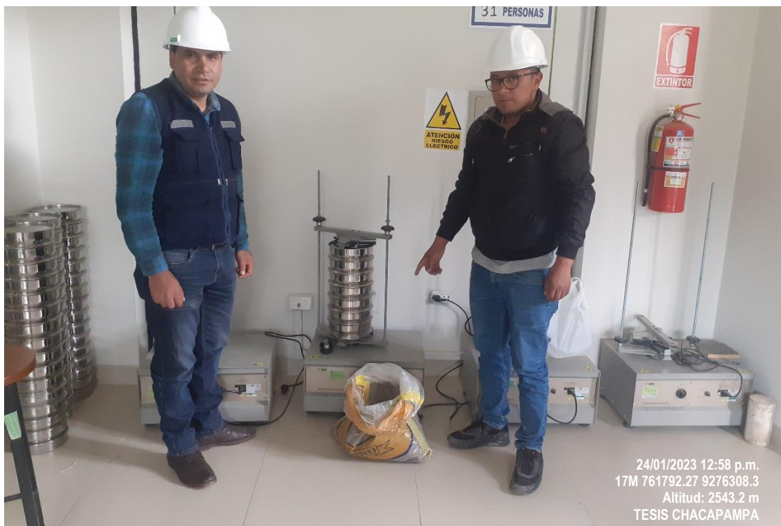
24/01/2023 Tesistas en el laboratorio de suelos de la UNACH, realizando ensayos de granulometría
