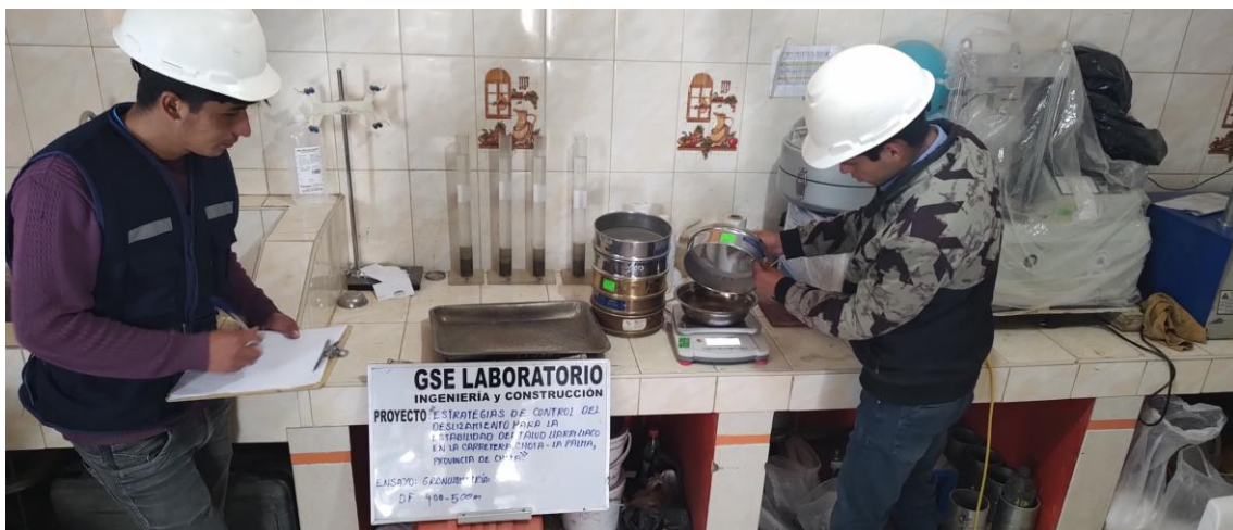
Fotografía 14 Pesado de la muestra de suelo retenida en cada tamiz
