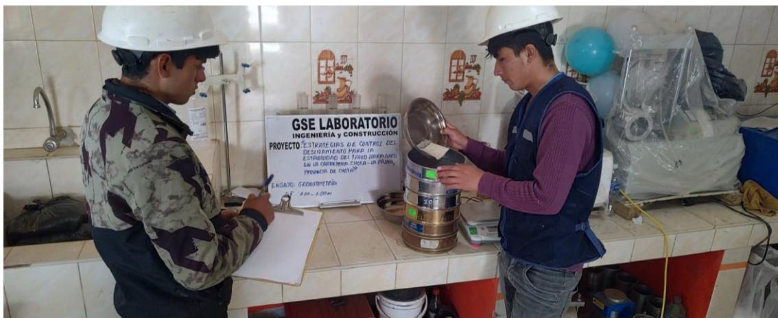
Fotografía 14 Pesado de la muestra de suelo retenida en cada tamiz
