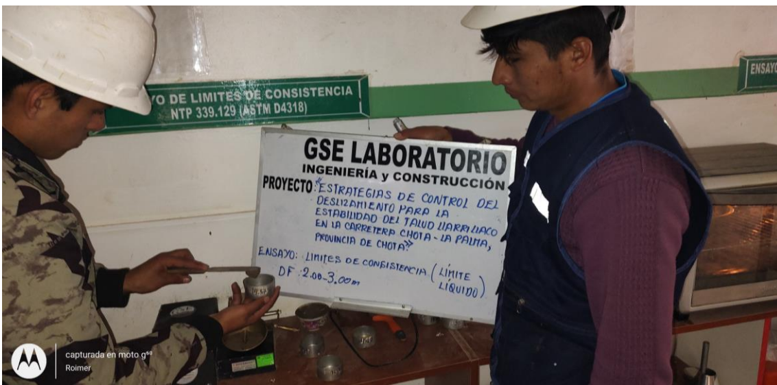
Fotografía 17 Pesado de la muestra de suelo que se ha unido en la copa Casagrande
