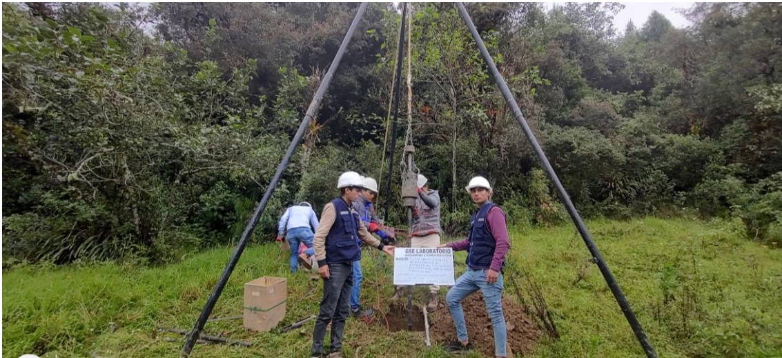
Fotografía 5 Toma de muestras por estrato del ensayo SPT
