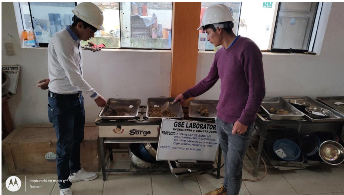
Fotografía 8 Lavado de la muestra por el tamiz N° 200 para ensayo granulométrico
