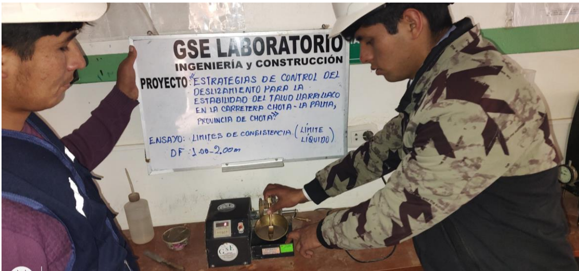
Fotografía 16 Recolección de la fracción que se unió en el ensayo de la copa Casagrande
