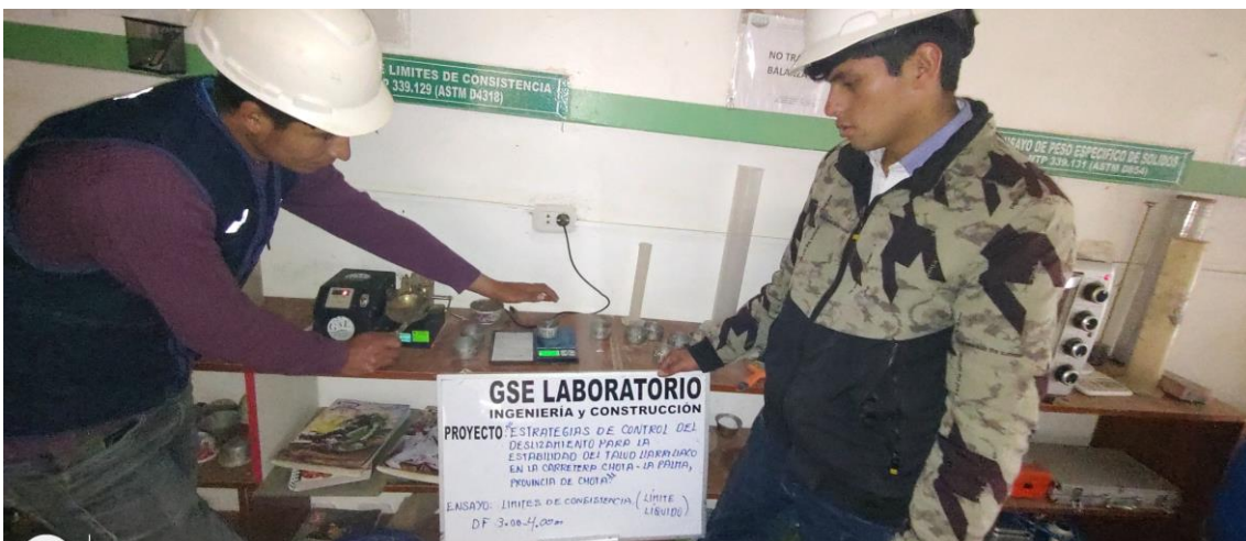
Fotografía 17 Pesado de la muestra de suelo que se ha unido en la copa Casagrande
