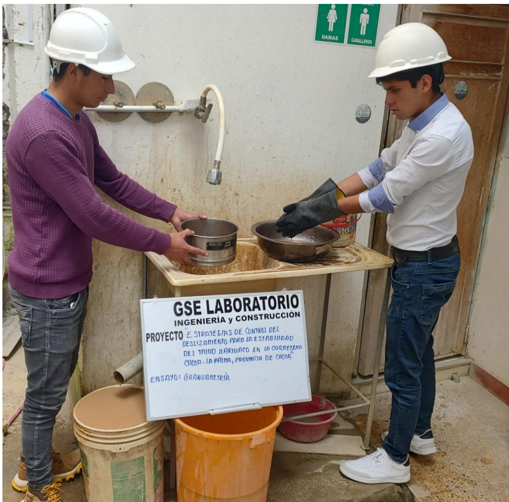
Fotografía 8 Lavado de la muestra por el tamiz N° 200 para ensayo granulométrico
