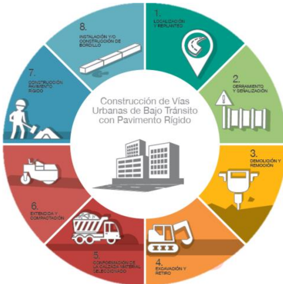
Figura 4 Proceso Constructivo de un Pavimento de Concreto
