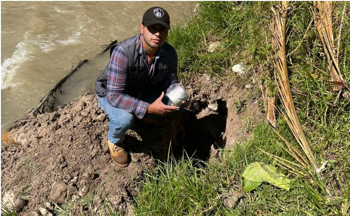
Fotografía 22. Muestreo de suelos en la Calicata 6 del trayecto del río Chotano
