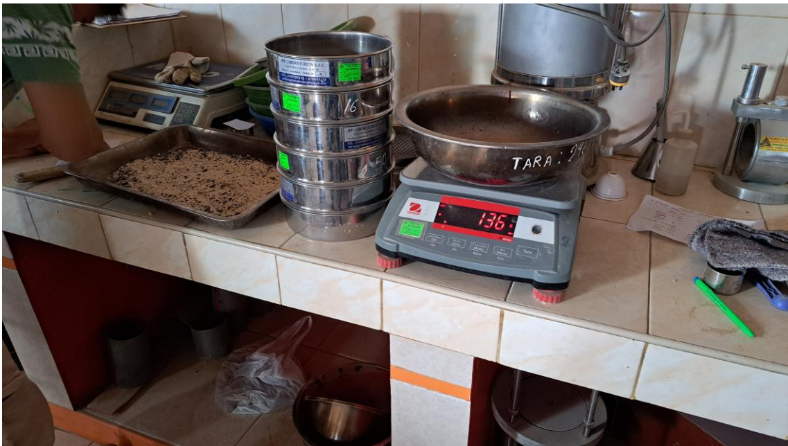
Fotografía 29. Ensayos de laboratorio de mecánica de suelos: Prueba de Granulometría
