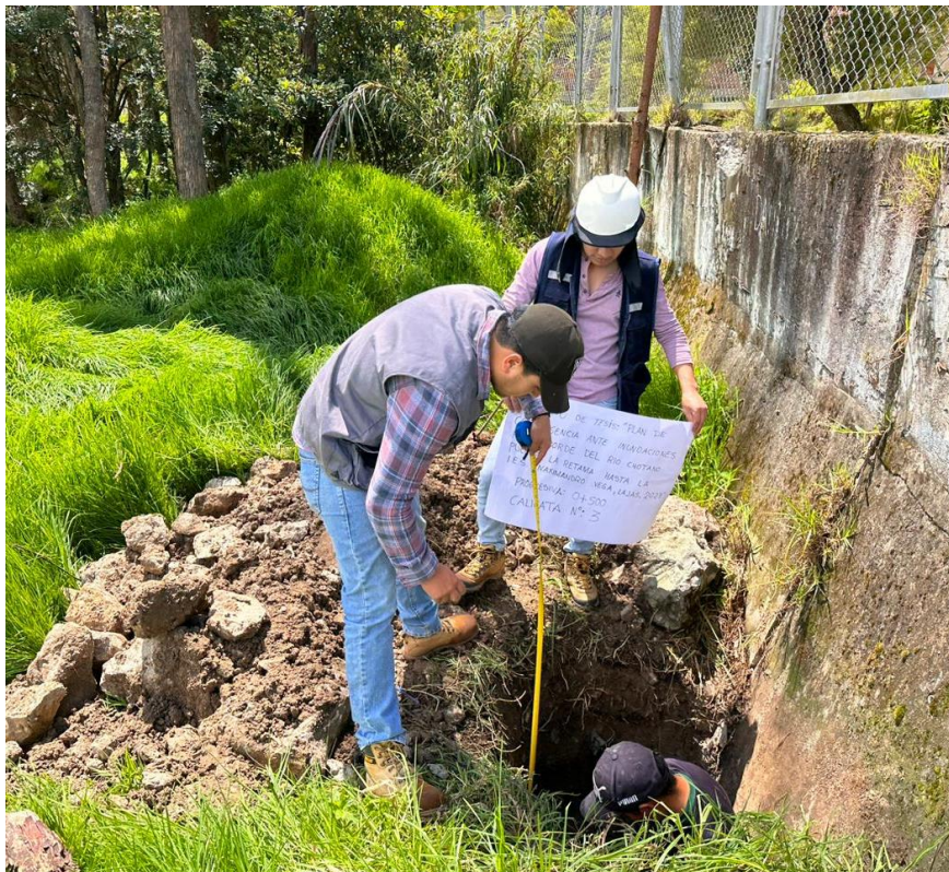
Figura 51 Excavación de la Calicata 10 en la Progresiva 2+000 km
