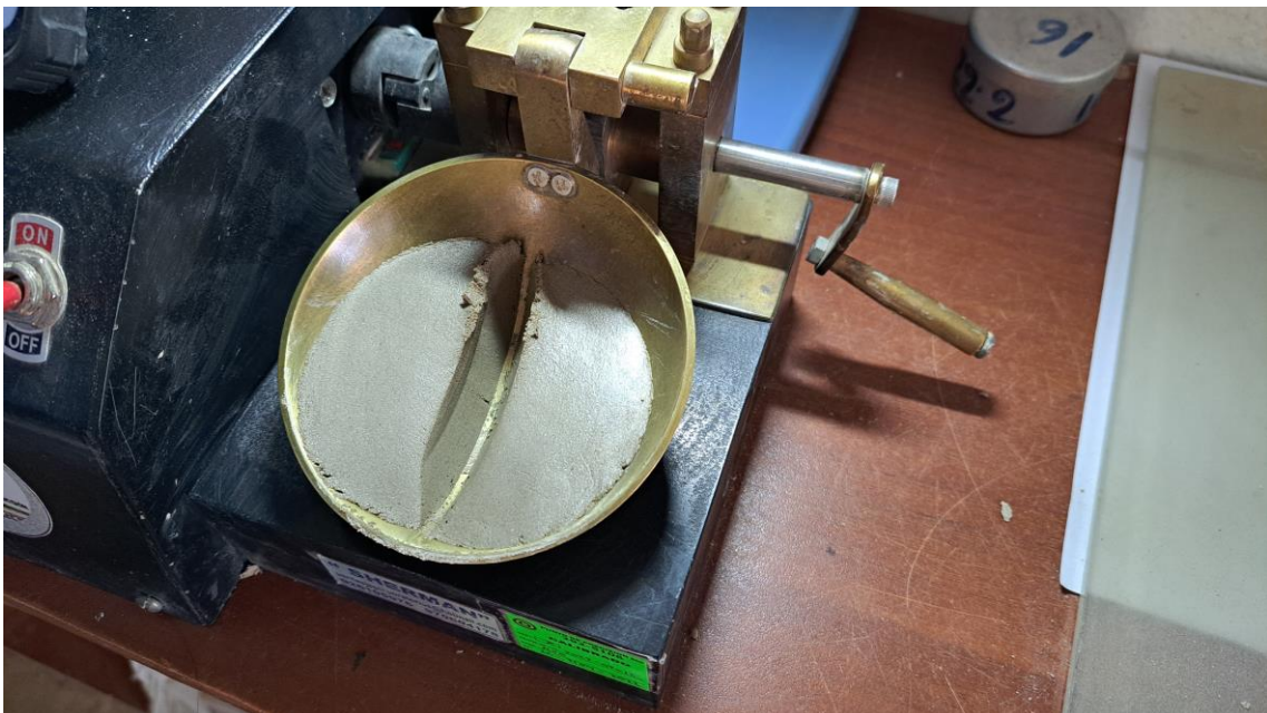
Fotografía 30. Ensayos de laboratorio de mecánica de suelos: Prueba de límites de consistencia
