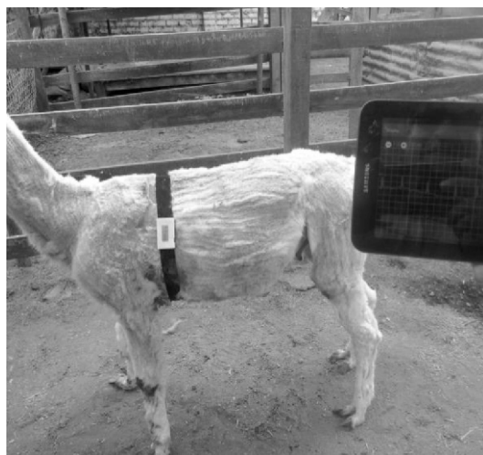
Figura 1. Monitorización de una alpaca con el MOSIVILLE, cuya señal cardiaca se puede observar en una tableta en tiempo real
