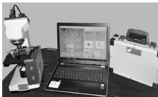
Figura 3. MEDULOMETRO y software para evaluación de fibras según tipo de medulación.
