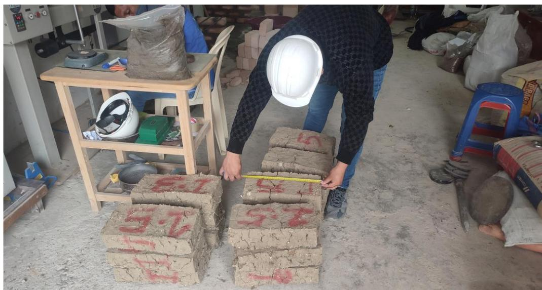
**Figura 51** *Ensayo a Flexión en Adobes con Hojas Aciculares*
