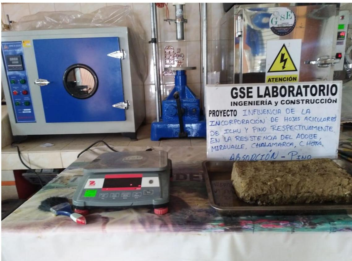
Fotografía 23. Pesado de bloques de adobe para ensayos a compresión
