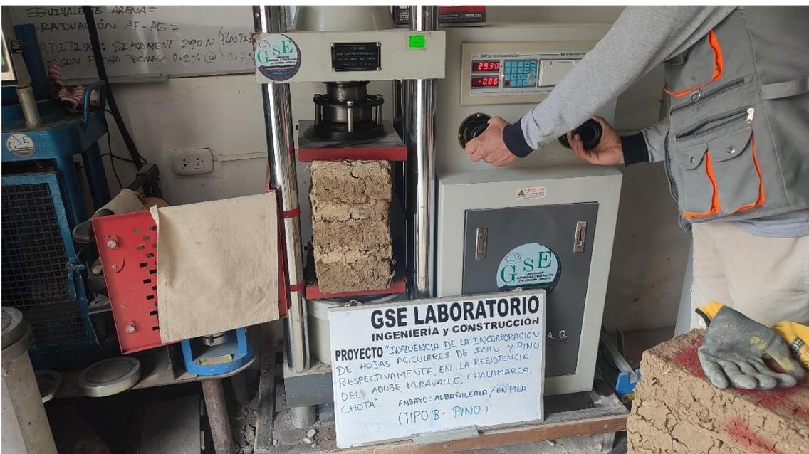
Fotografía 29. Colocación del murete al equipo para realizar el ensayo de corte diagonal
