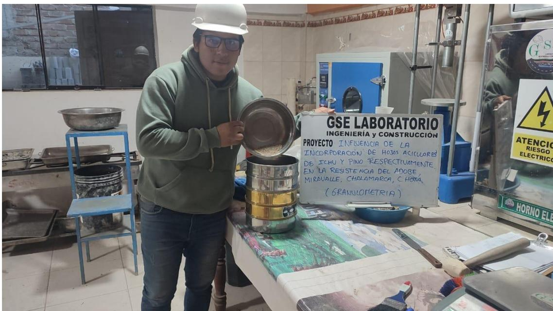
Fotografía 6. Ensayo de contenido de humedad del suelo
