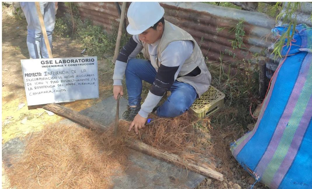
**Mezcla del suelo con las hojas:** Se añaden las hojas de pino desmenuzadas o las hojas de ichu secas al suelo preparado, y se mezclan bien hasta que las hojas queden distribuidas de manera homogénea en la masa de tierra. La proporción de hojas es de 0.5%, 1.5% y 3% con respecto al volumen del suelo.
