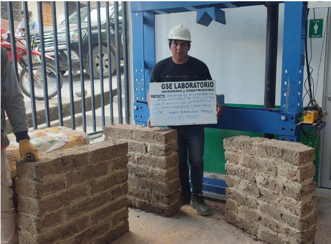
Fotografía 28. Prueba de compresión axial en pilas
