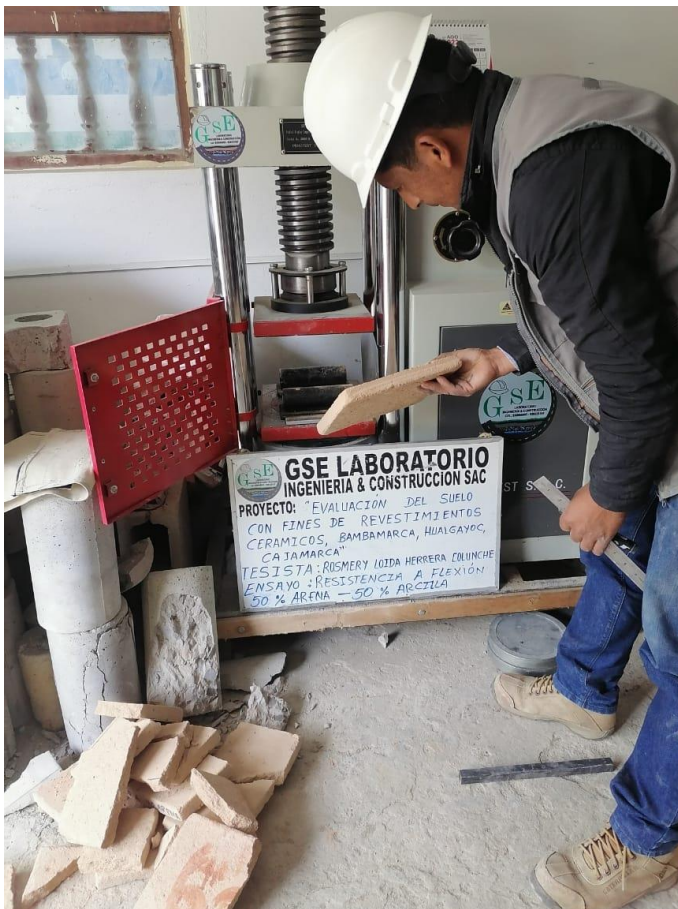
Fotografía 24. Ensayo de resistencia a la flexión
