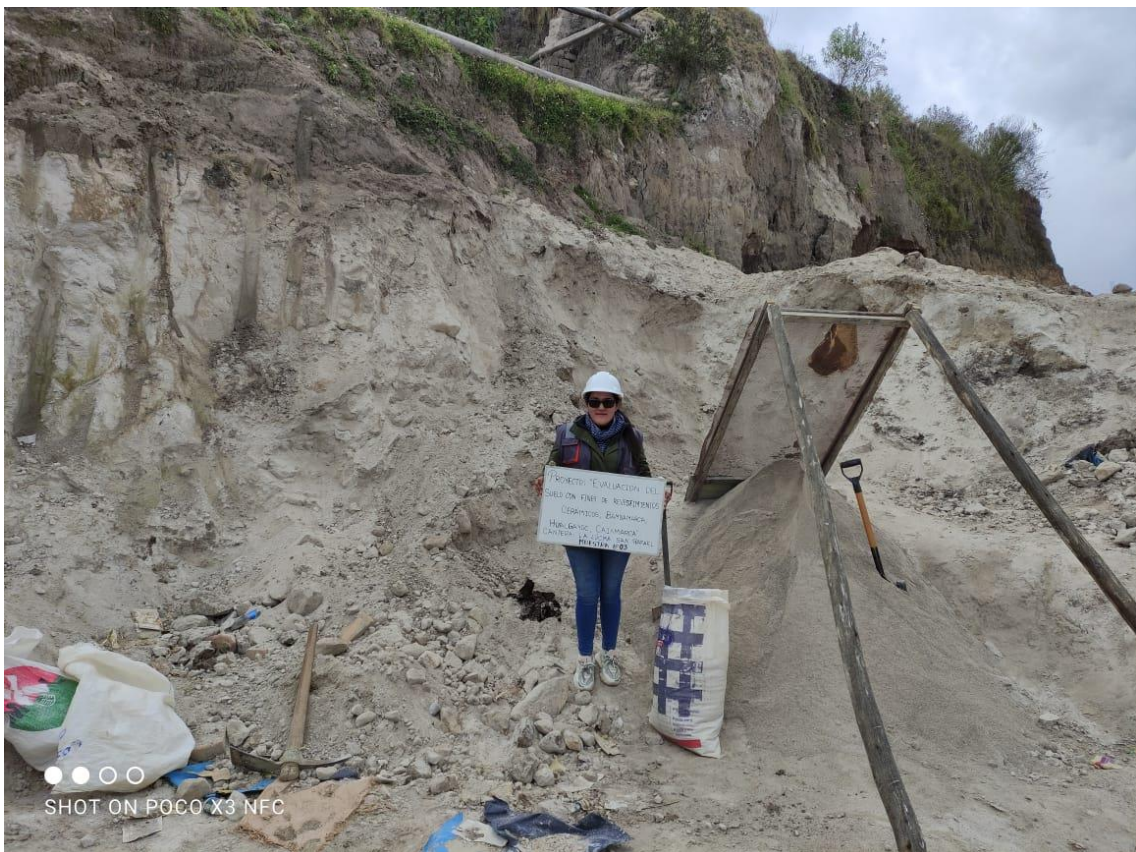
Fotografía 6. Toma de muestras de suelo en la cantera La Lucma San Rafael
