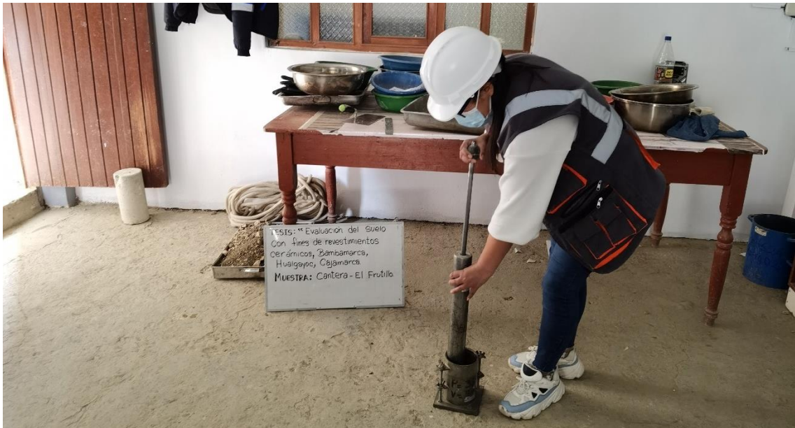
Fotografía 10. Enrasado de la muestra de Proctor modificado
