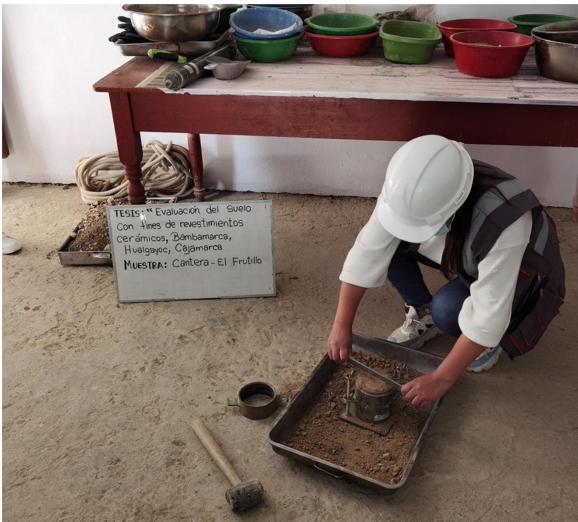
Fotografía 10. Enrasado de la muestra de Proctor modificado
