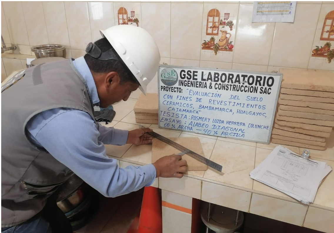
Fotografía 22. Ensayo de rectitud de lados en baldosas
