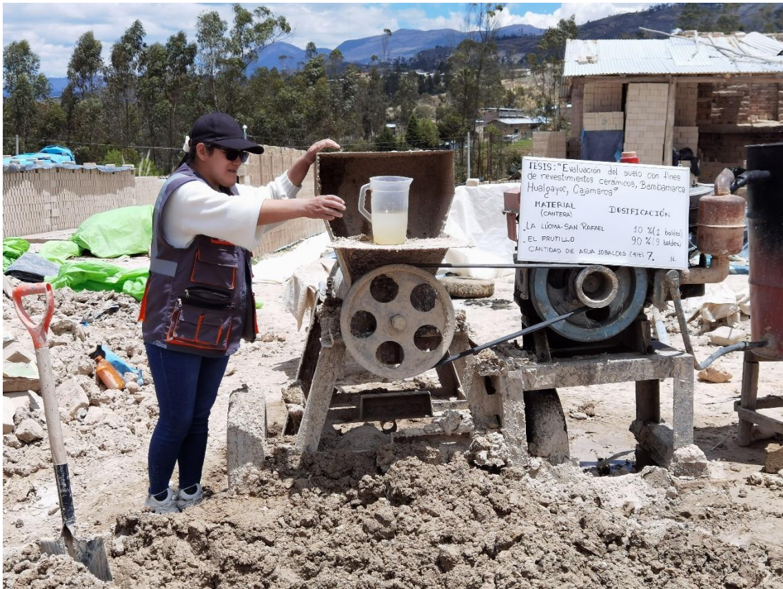
Fotografía 17. Molienda y amasado del material
