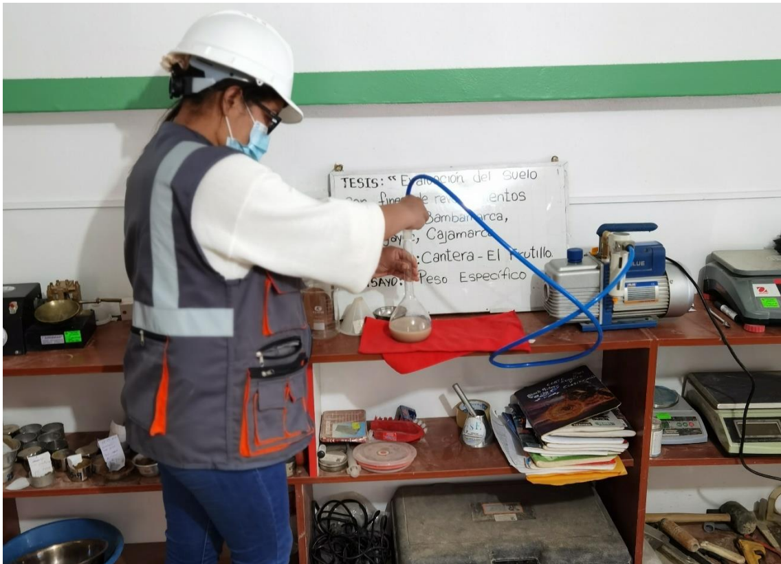
Fotografía 16. Mezcla de las proporciones de suelo
