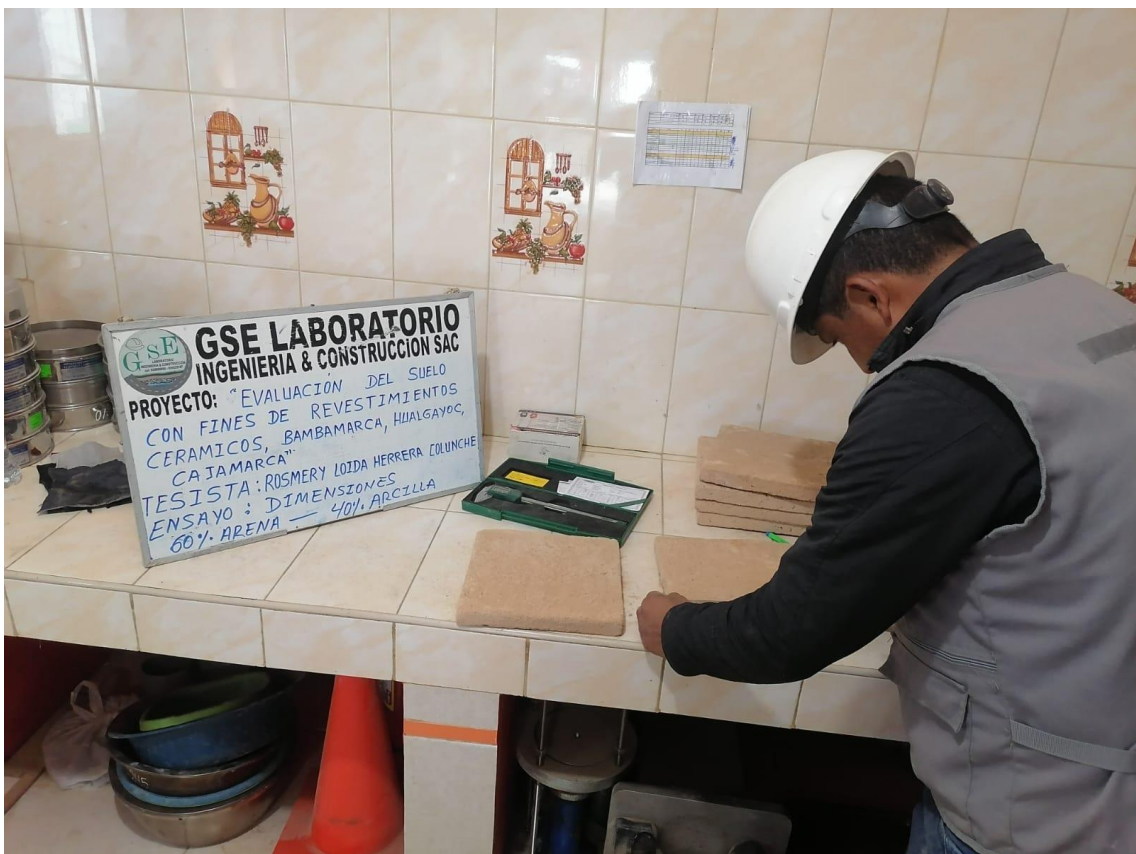
Fotografía 22. Ensayo de rectitud de lados en baldosas
