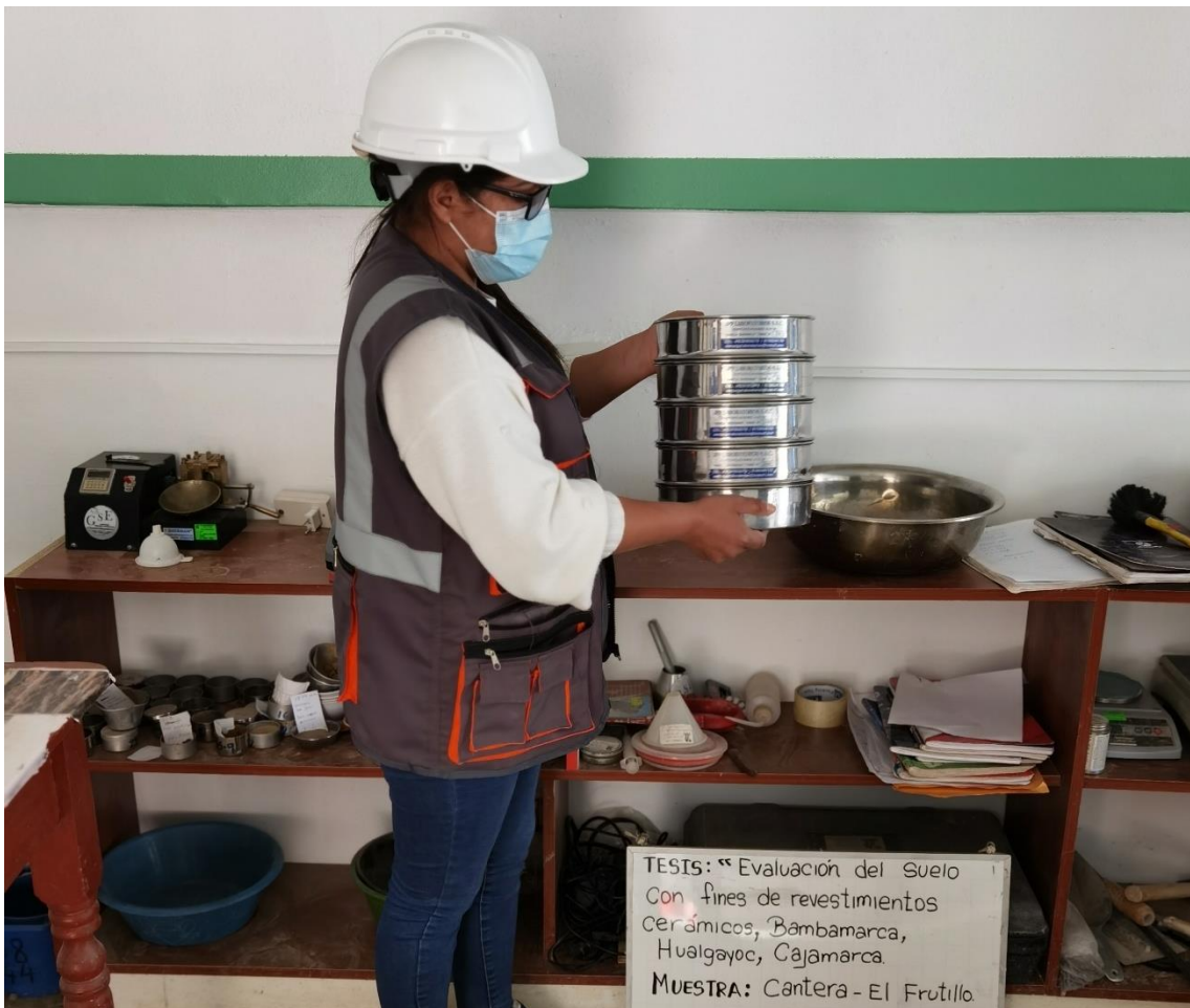
Fotografía 12. Realización del ensayo de granulometría
