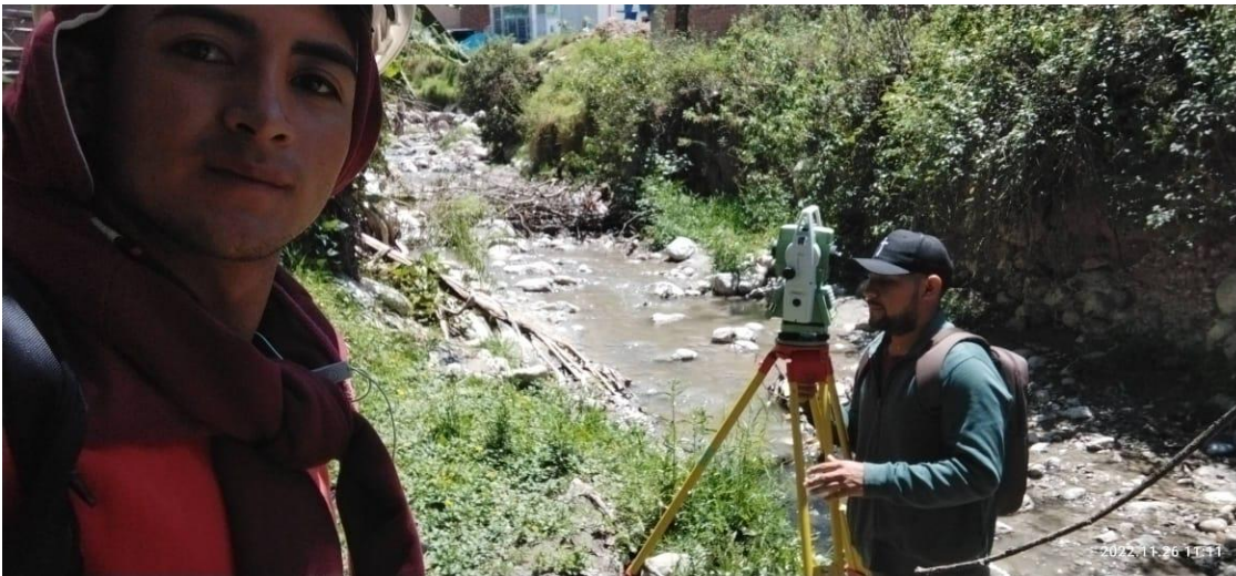
Fotografía 8 Levantamiento topográfico coordenada y altitud del BM-04.
