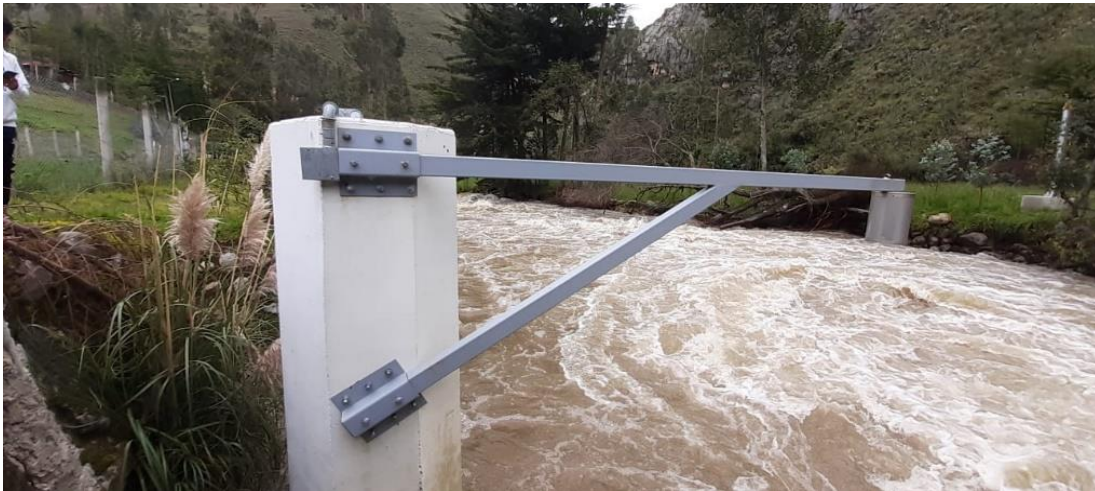
Fotografía 28 Mira para visualizar el nivel del agua.
