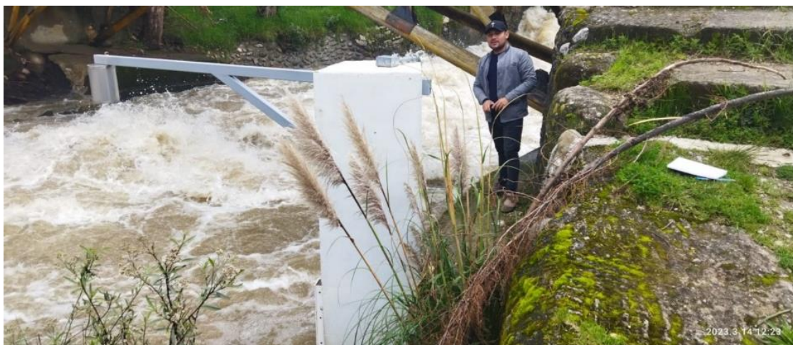
Fotografía 26 Columna para los sensores de nivel y/o calidad del agua en el río Chonta.
