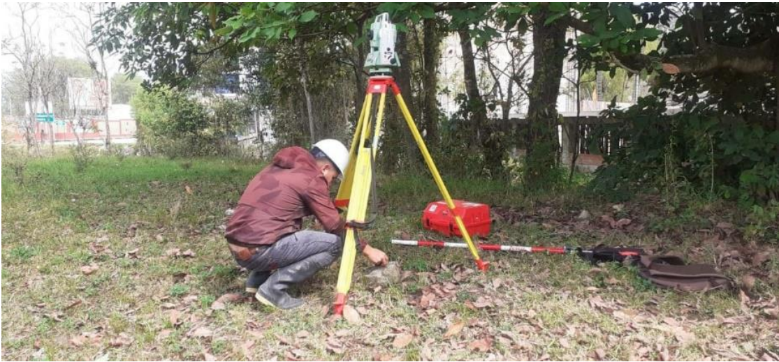
Fotografía 8 Levantamiento topográfico coordenada y altitud del BM-04.
