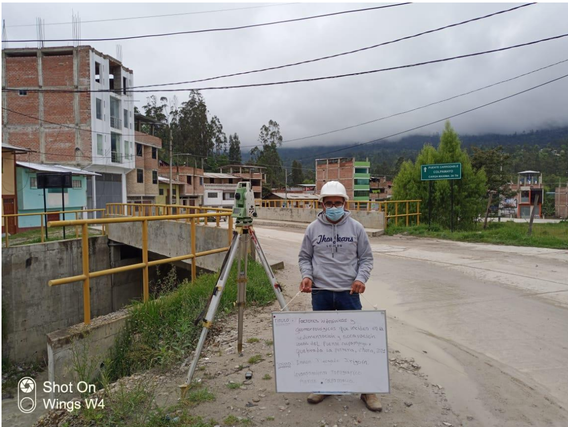
Fotografía 14. Estacionamiento para realizar la topografía de la quebrada La Potrera en el Puente Colpamayo
