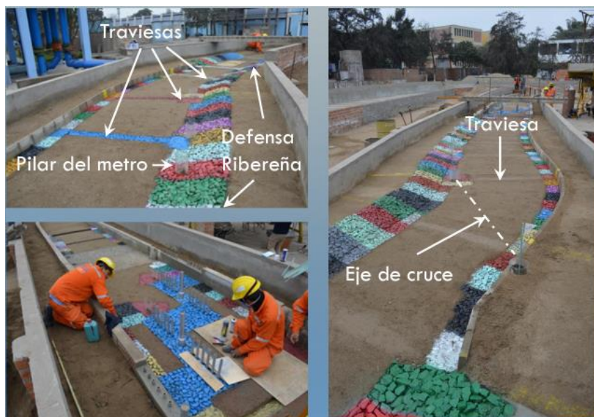
Figura 42 Estructuras Tipo Traviesas
