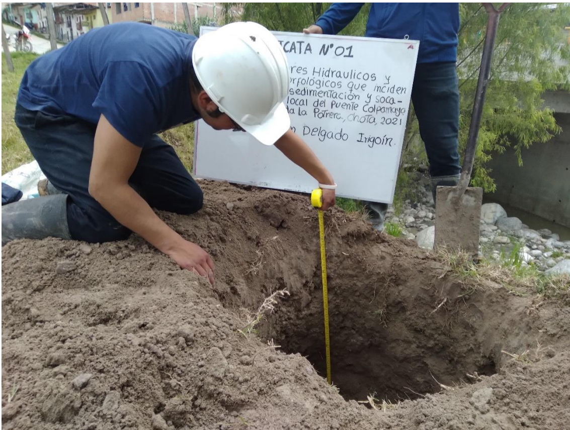
Fotografía 10. Toma de muestras de los sedimentos del cauce de la quebrada La Potrera
