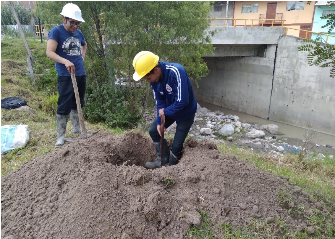
Fotografía 8. Excavación de una calicata en el borde de la ribera de la quebrada La Potrera
