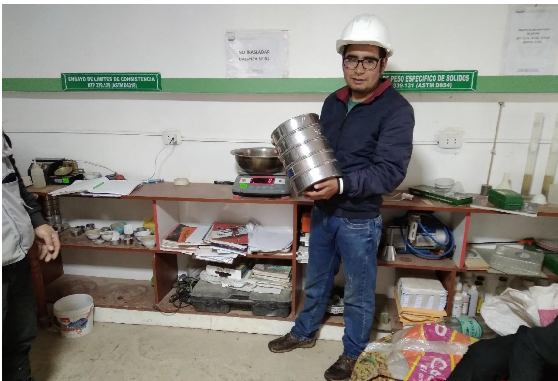
Fotografía 12. Granulometría del suelo en laboratorio, puente Colpamayo
