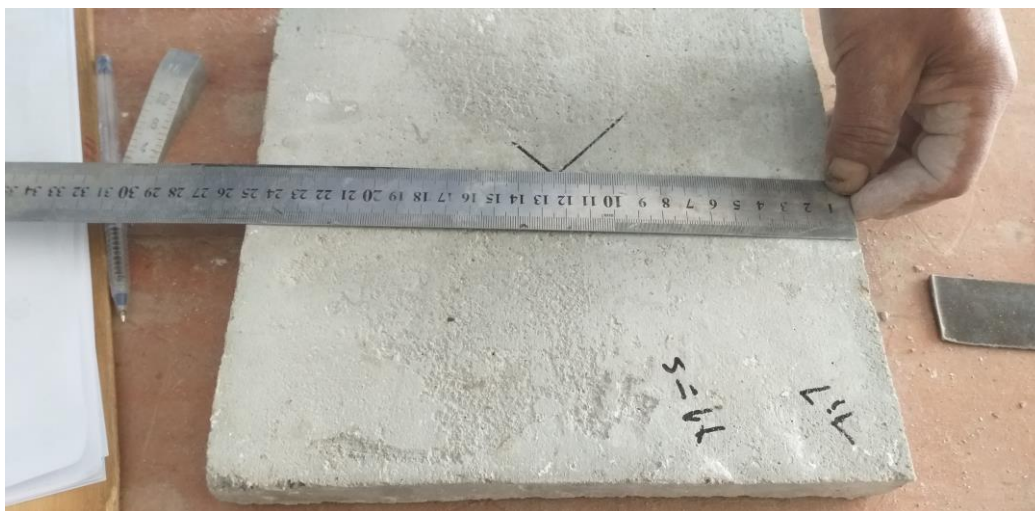
Fotografía 15 Alabeo de los ladrillos pasteleros
