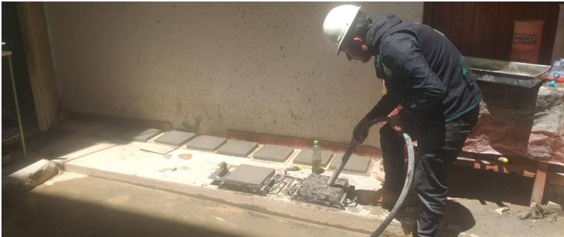
Fotografía 9 Producción de los ladrillos pasteleros
