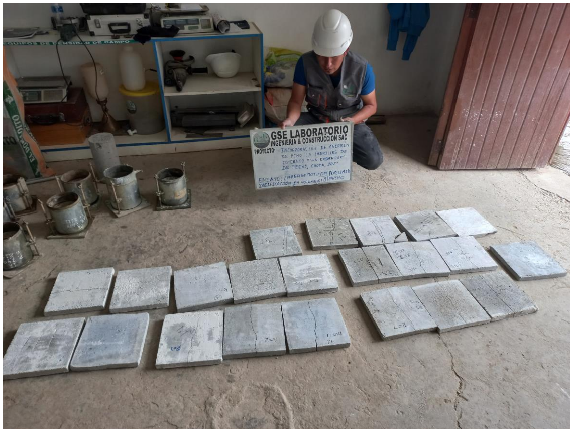
Fotografía 23 Paneles de concreto luego del ensayo de resistencia a la rotura
