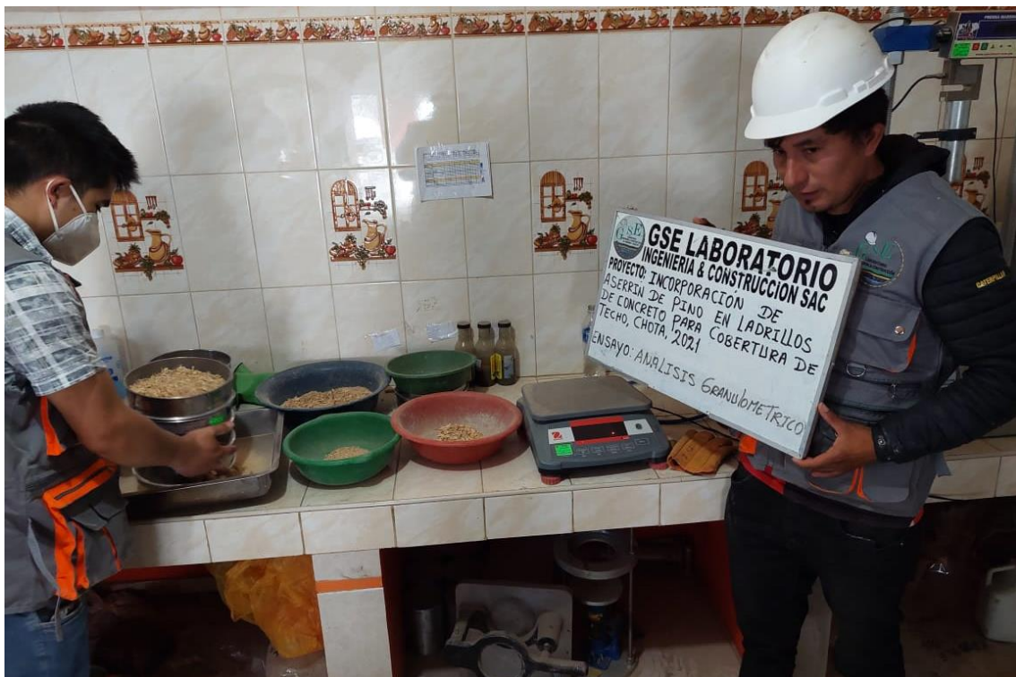
Fotografía 6 Análisis granulométrico del aserrín
