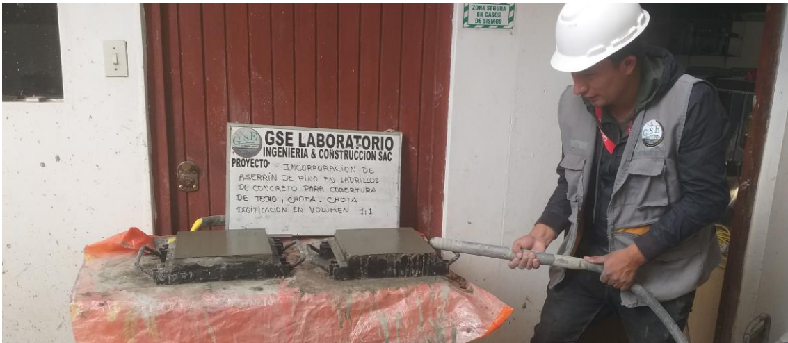
Fotografía 10 Fraguado de los ladrillos pasteleros
