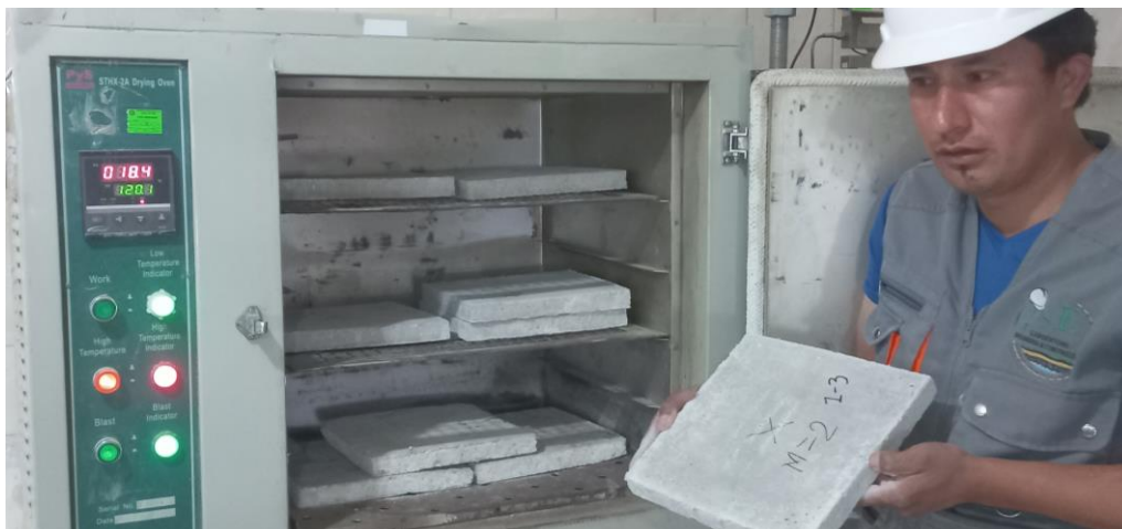
Fotografía 18 Colocación de los ladrillos pasteleros al horno para su secado
