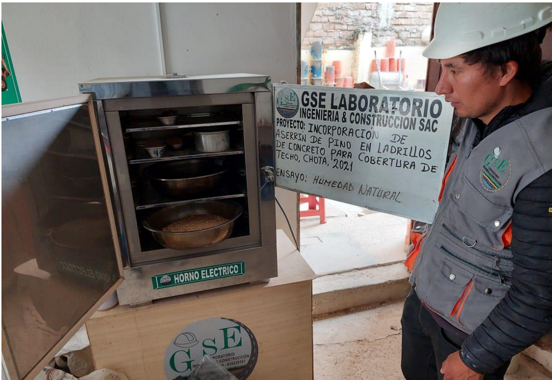
Fotografía 2 Colocación del aserrín al horno para su secado
