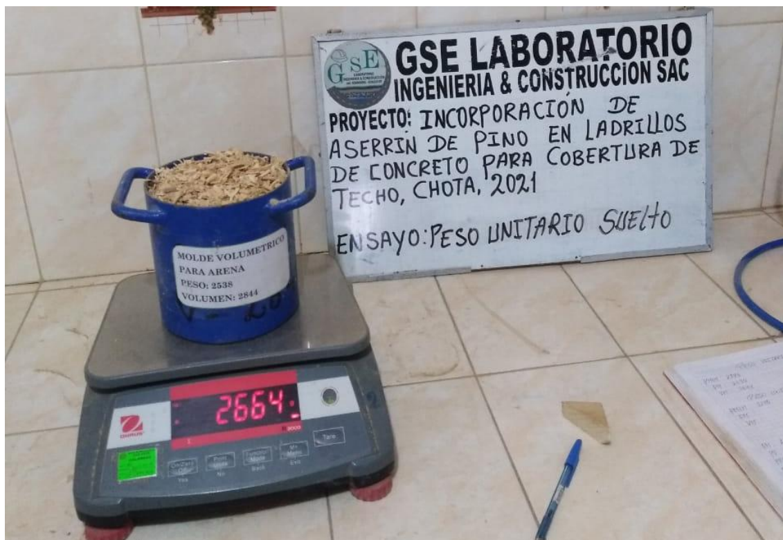
Fotografía 3 Ensayo de peso unitario suelto al aserrín
