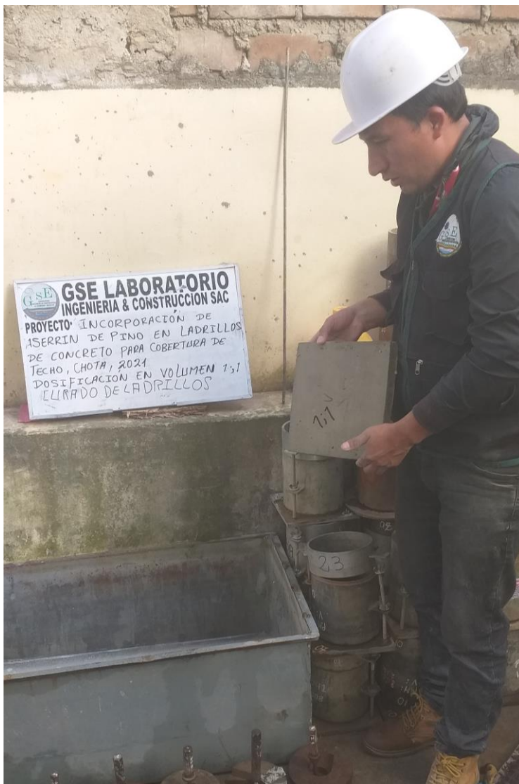
Fotografía 12 Curado de los ladrillos pasteleros en agua con cal
