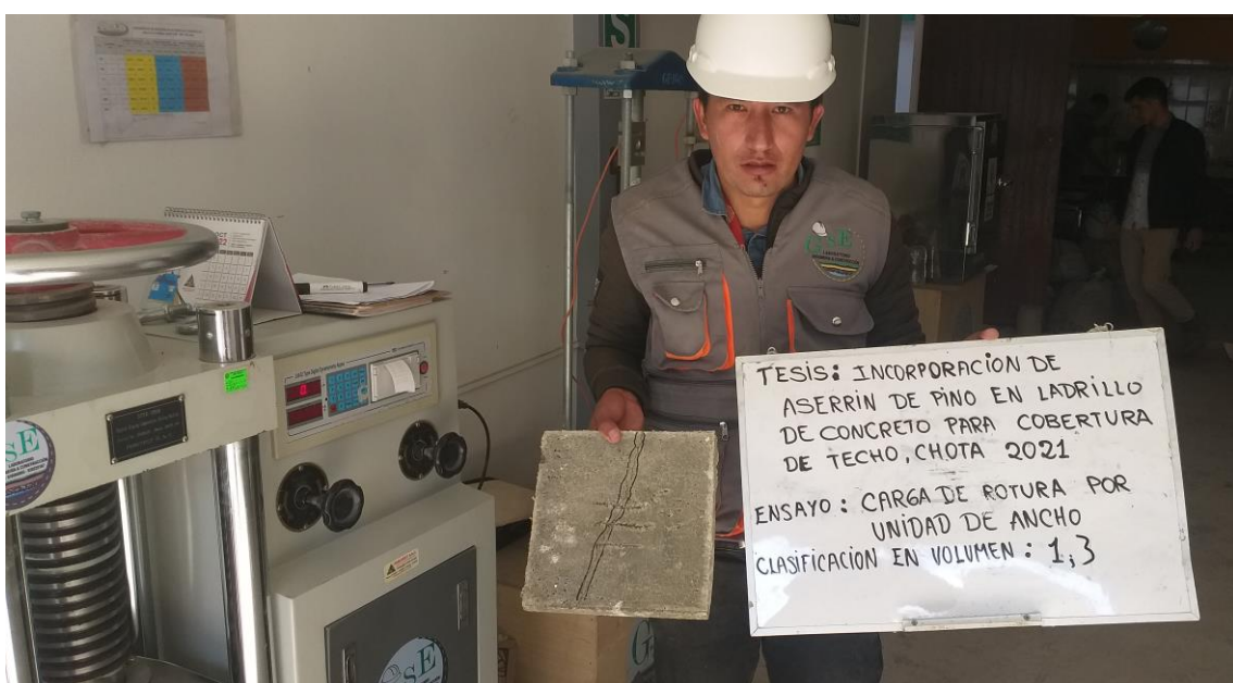
Fotografía 22 Paneles de concreto luego del ensayo de resistencia a la rotura
