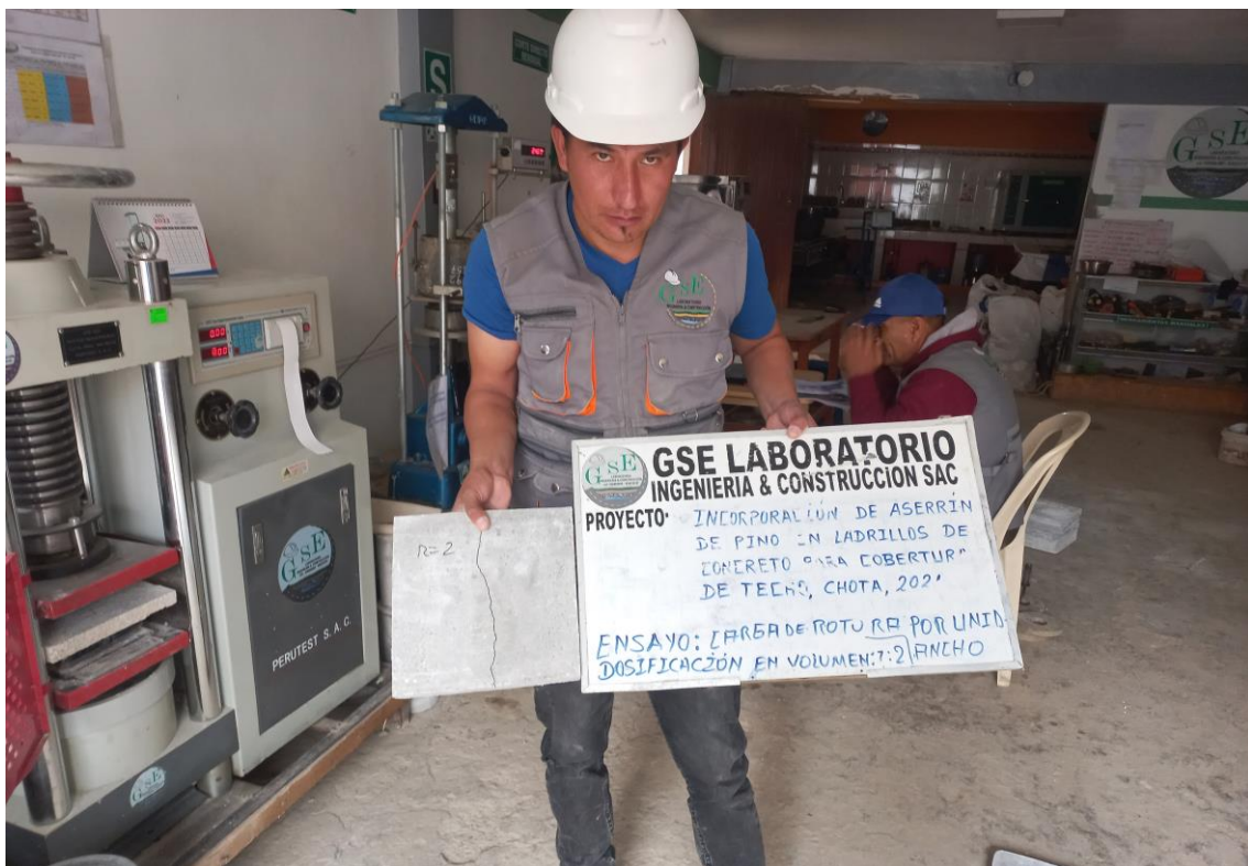
Fotografía 20 Paneles de concreto luego del ensayo de resistencia a la rotura
