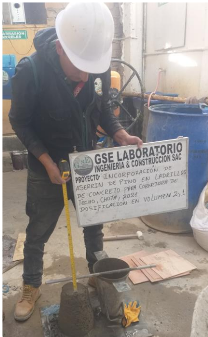
Figura 18 Ensayo de Asentamiento de la Mezcla de Concreto
