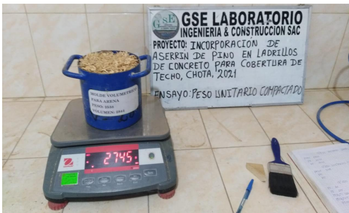
Fotografía 4 Ensayo de peso unitario compactado al aserrín
