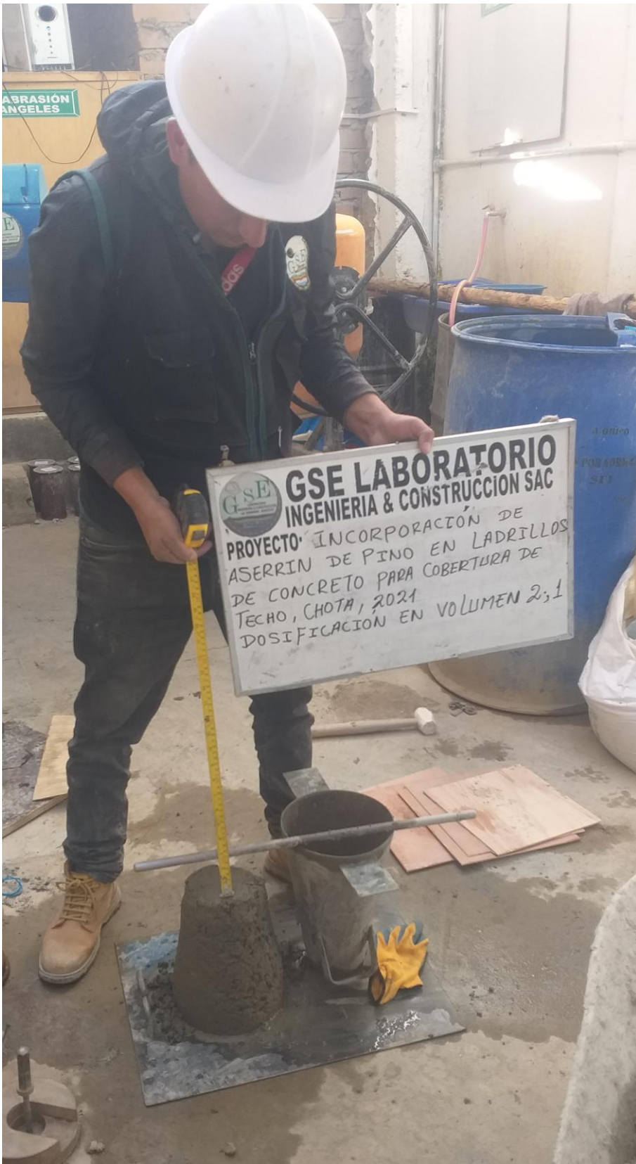
Fotografía 7 Ensayo de asentamiento en la mezcla de concreto
