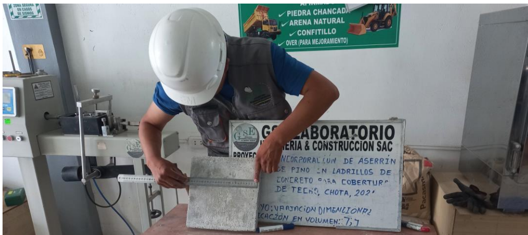
Fotografía 14 Medición de los ladrillos pasteleros
