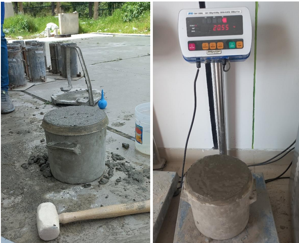
Fotografía 36 Ensayo para Determinar la Densidad del Concreto
