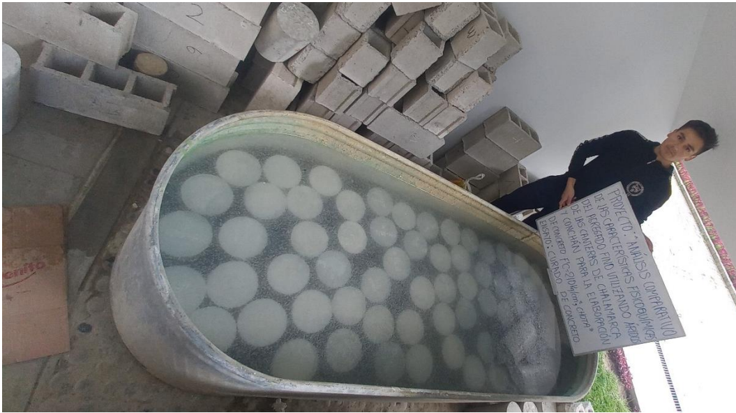
Fotografía 35 Curado de las Probetas de Concreto
