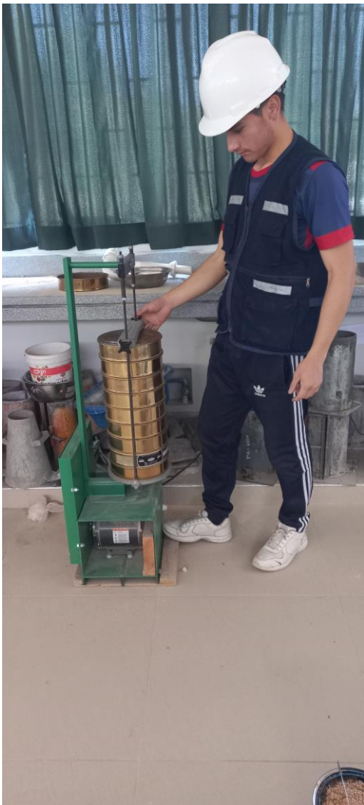
Fotografía 26 Granulometría de la arena
