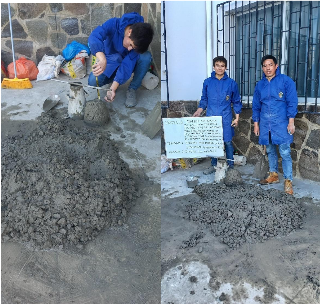
Fotografía 38 Ensayo para Determinar el Asentamiento del Concreto
