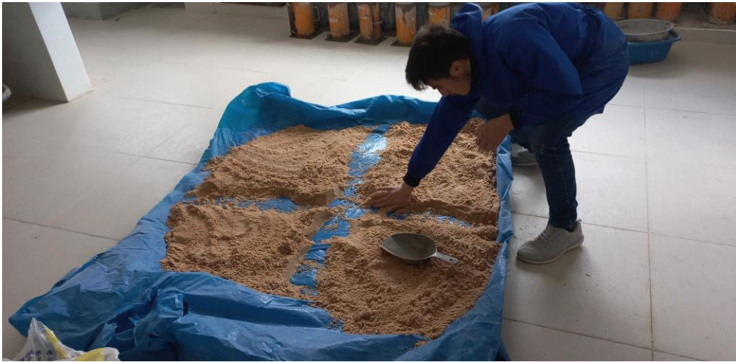
Fotografía 26 Granulometría de la arena
