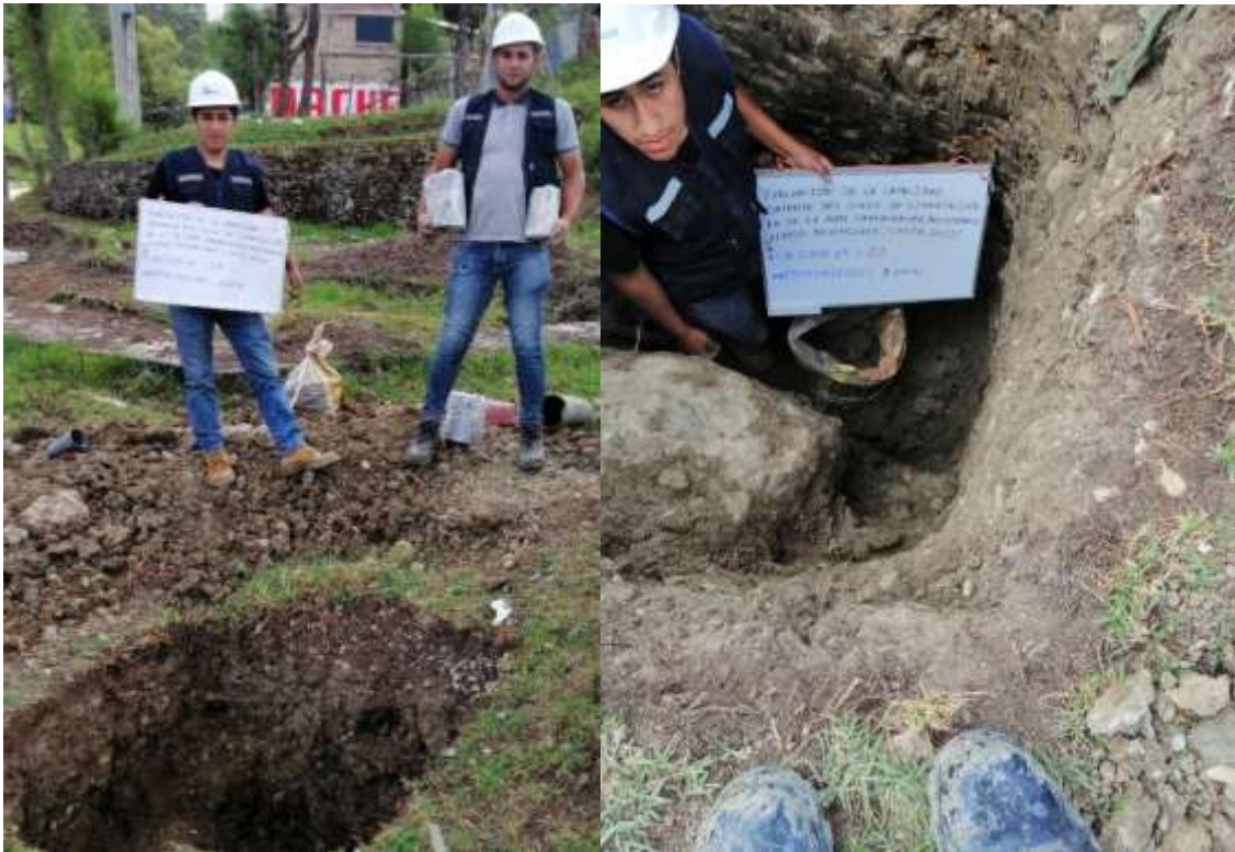
Fotografía 6. Excavación de la calicata 2 (3 m. de profundidad) en la I.E. Cabracancha
