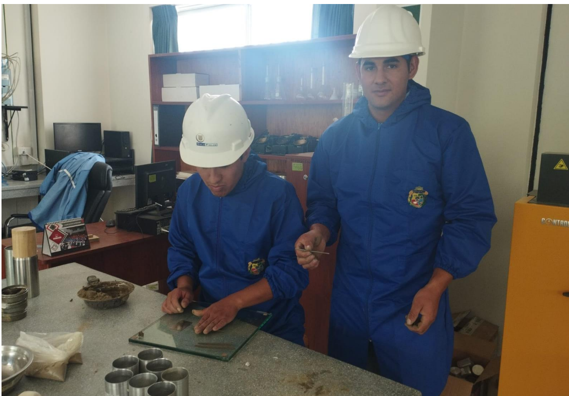
Fotografía 16. Realizando el ensayo de límite plástico del suelo, proceso de elaboración de los rollitos de suelo
