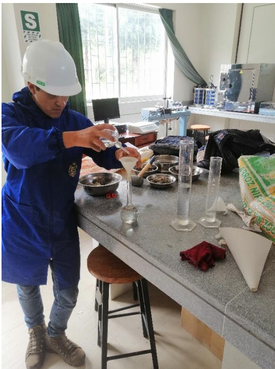
Fotografía 18. Densidad húmeda del suelo, tesistas colocando agua en la pipeta para el ensayo de peso específico del suelo
