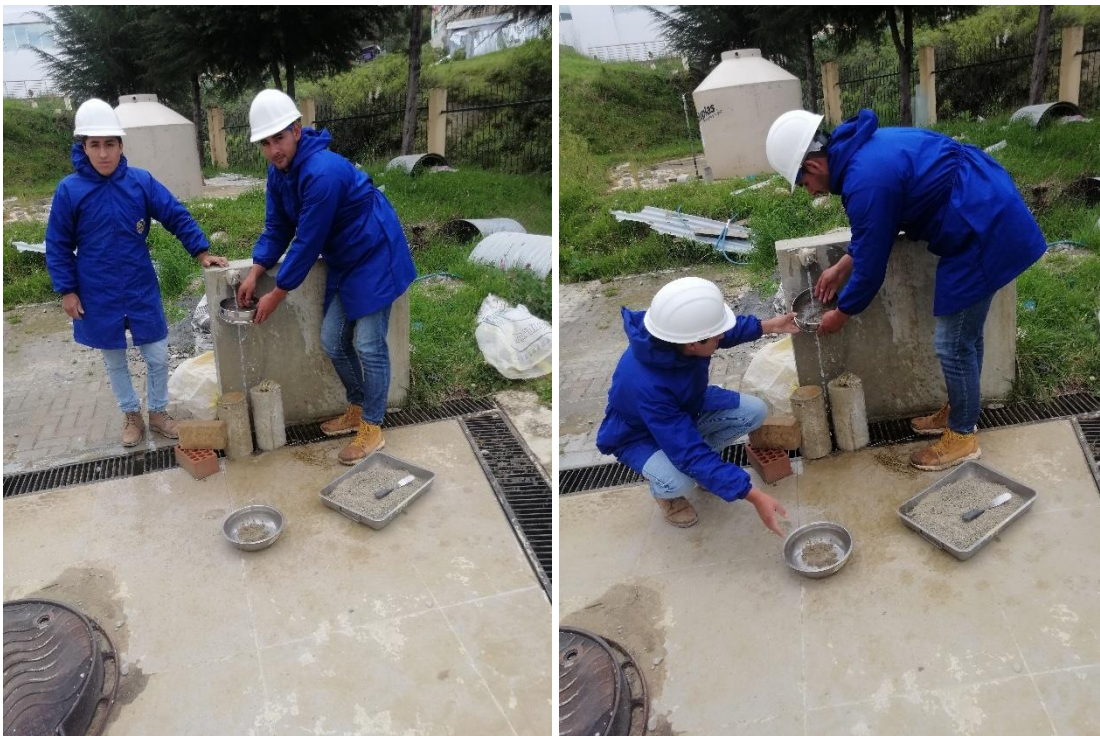
Fotografía 14. Tesistas realizando el ensayo de granulometría del suelo, (a) pasando el suelo por las mallas y (b) pesando el porcentaje retenido en los tamices
