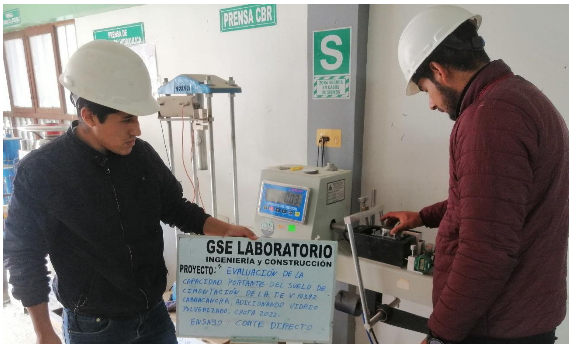
Fotografía 26. Ensayo de corte directo del suelo sin y con vidrio pulverizado en el laboratorio externo GSE-Chota
