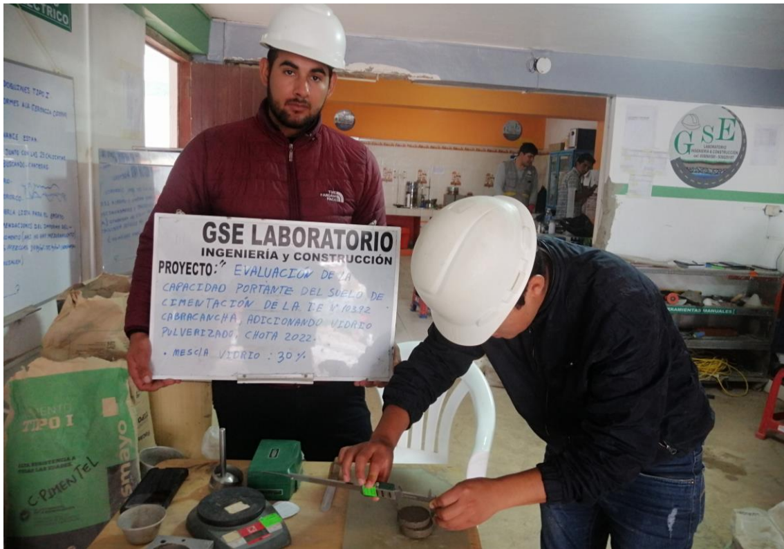
Fotografía 26. Ensayo de corte directo del suelo sin y con vidrio pulverizado en el laboratorio externo GSE-Chota
