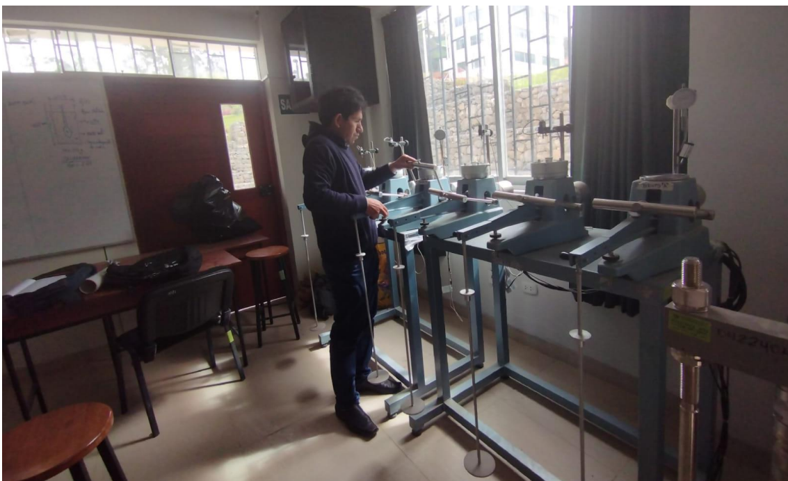
Fotografía 22. Registro de datos del ensayo de consolidación por parte del encargado de laboratorio en las muestras de suelo
