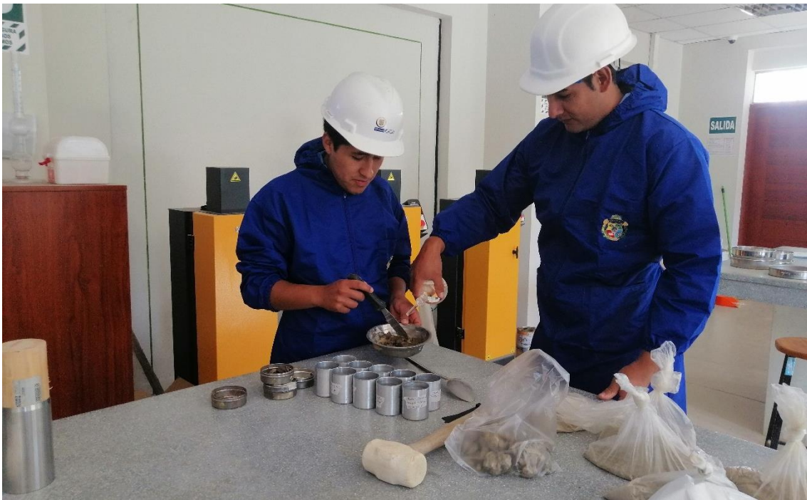
Fotografía 16. Realizando el ensayo de límite plástico del suelo, proceso de elaboración de los rollitos de suelo
