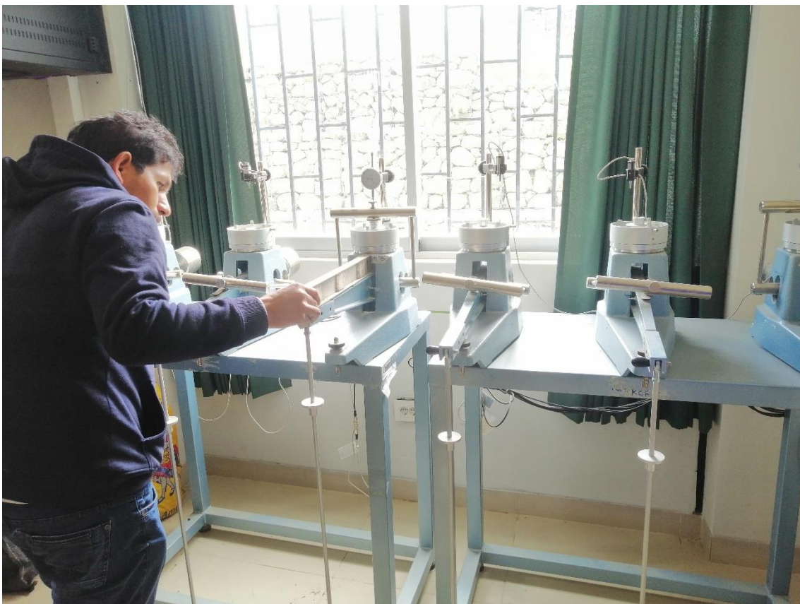
Fotografía 20. Encargado del laboratorio verificando el equipo para Consolidación
