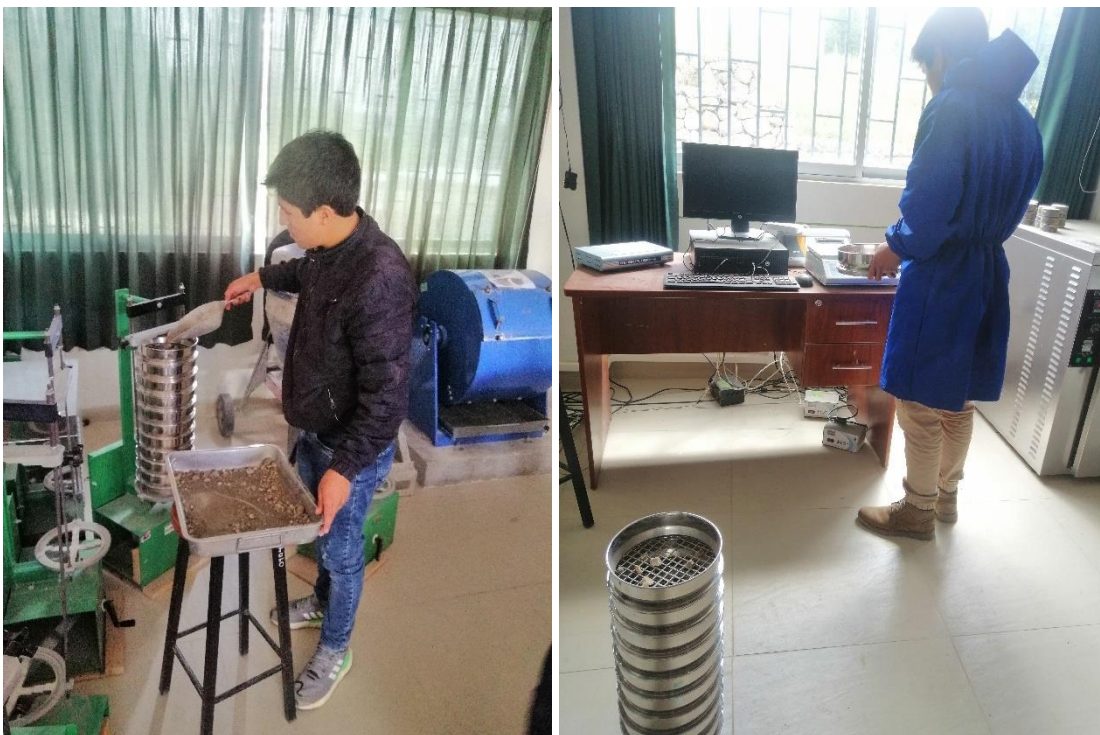
Fotografía 14. Tesistas realizando el ensayo de granulometría del suelo, (a) pasando el suelo por las mallas y (b) pesando el porcentaje retenido en los tamices
