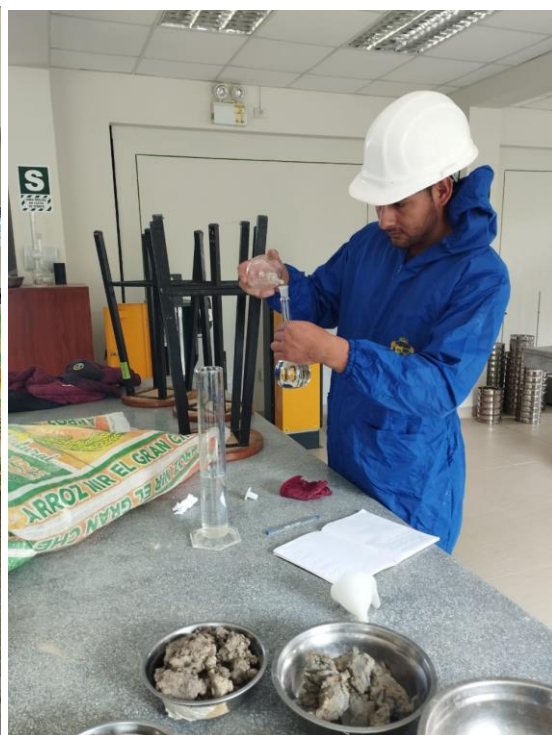
Fotografía 18. Densidad húmeda del suelo, tesistas colocando agua en la pipeta para el ensayo de peso específico del suelo
