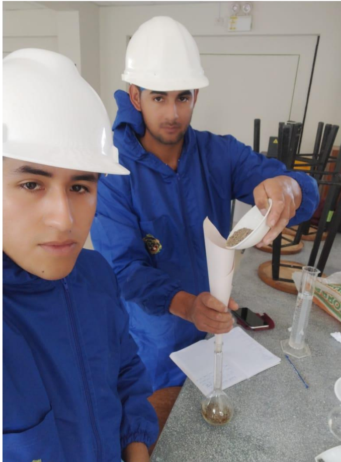
Figura 28 Ensayo de Peso Específico, Suelo I.E. 10392
