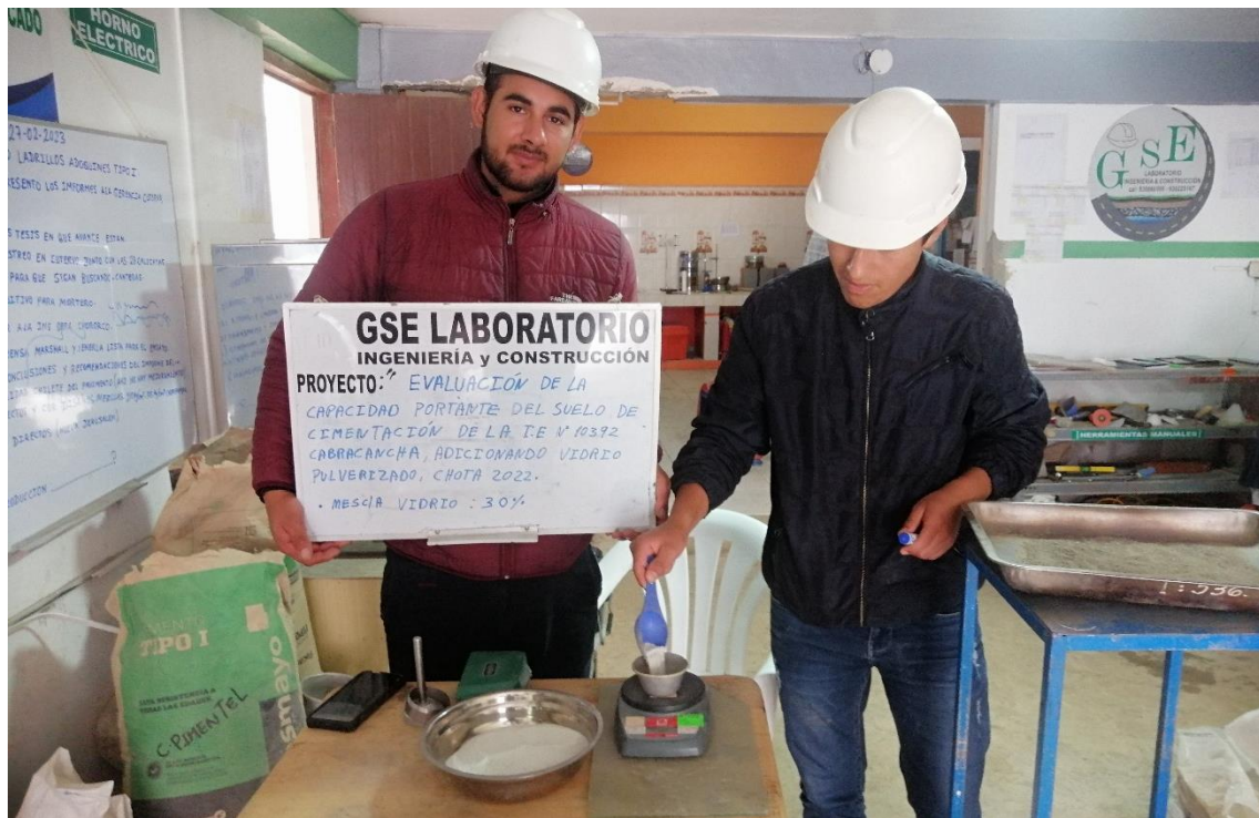
Fotografía 24. Mezcla del suelo con vidrio pulverizado para elaborar las muestras para el ensayo de corte directo
