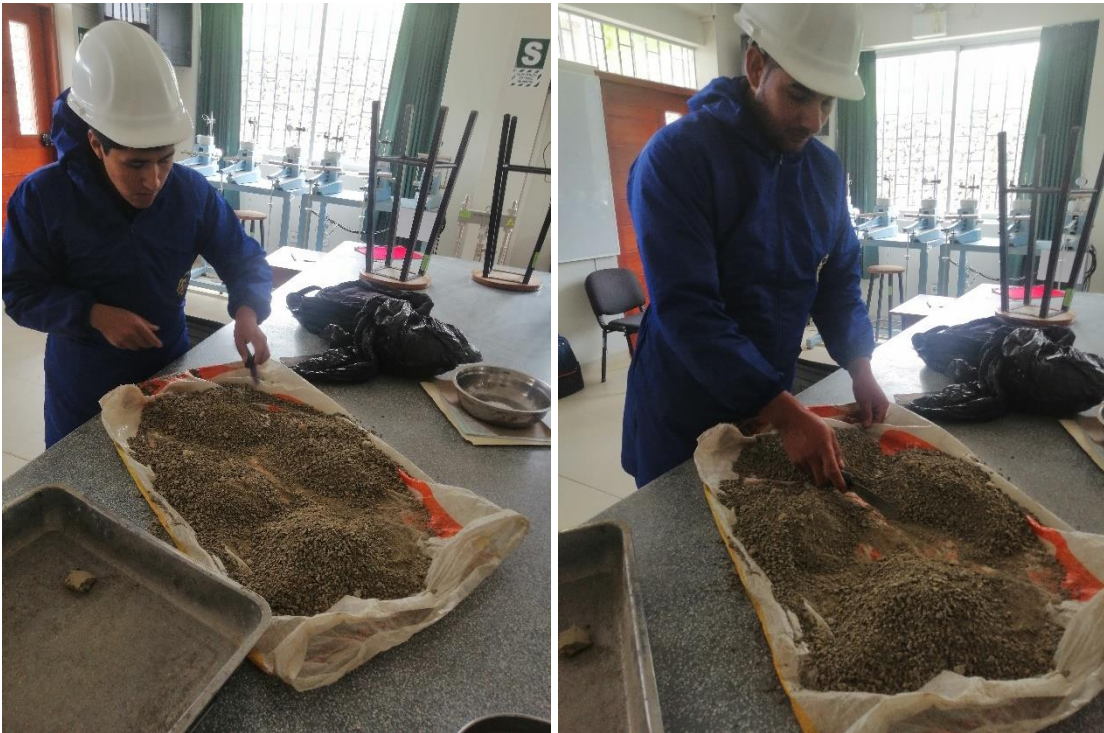
Fotografía 12. Tesistas realizando el cuarteo de las muestras de suelo en el laboratorio para los ensayos físicos
