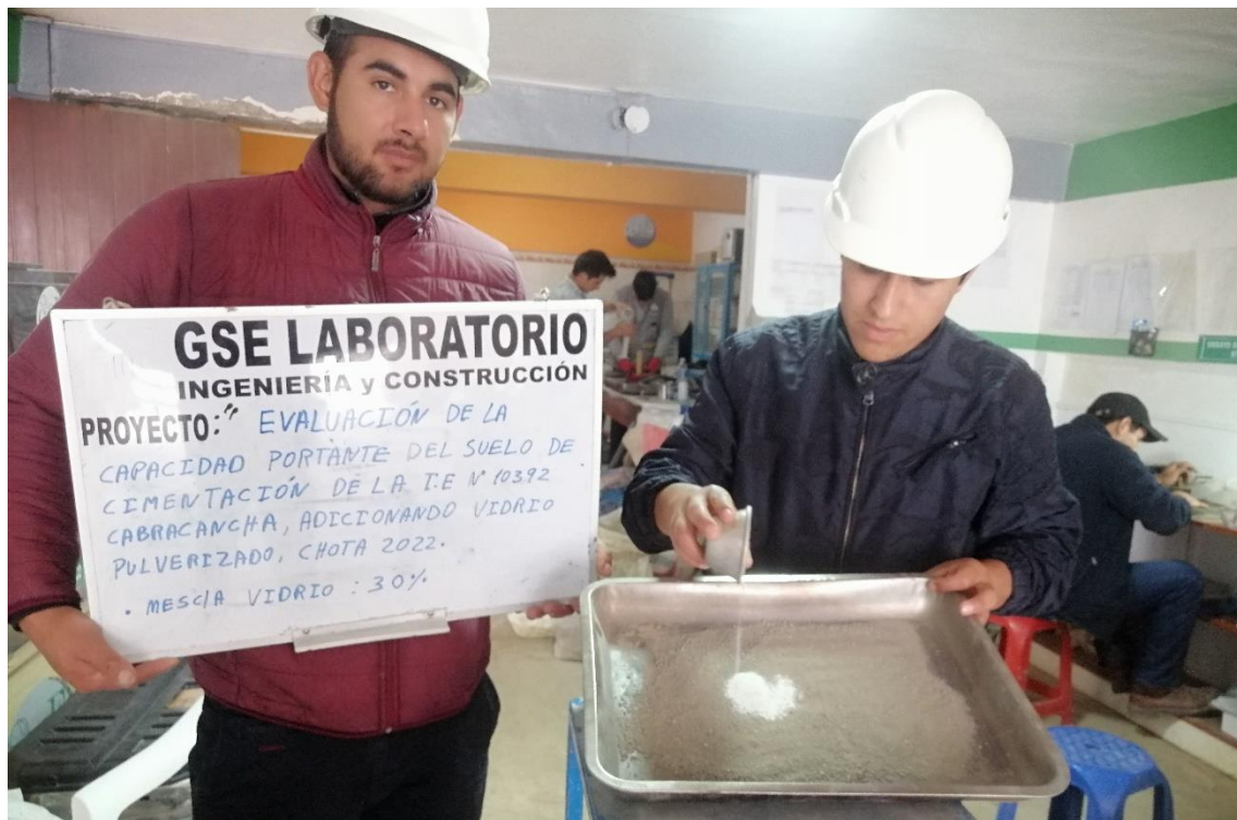
Fotografía 24. Mezcla del suelo con vidrio pulverizado para elaborar las muestras para el ensayo de corte directo
