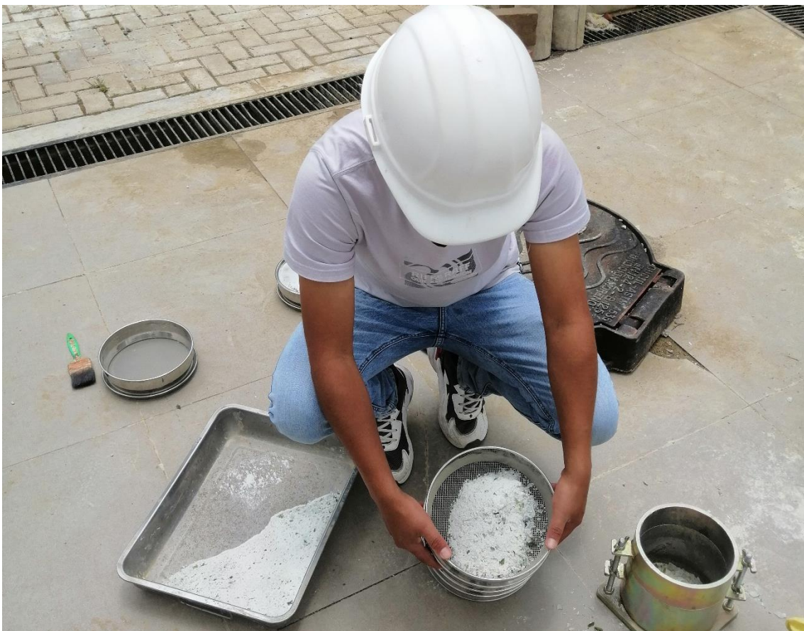
Fotografía 4. Tamizado del vidrio pulverizado por el tamiz N° 60 al tamiz N° 100
