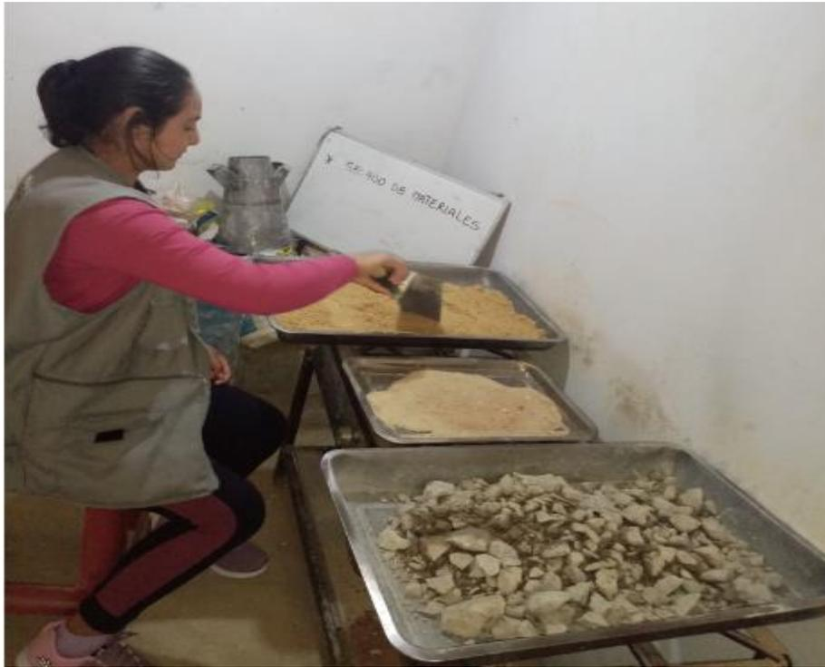
Fotografía 2. Ensayo de humedad del agregado fino
