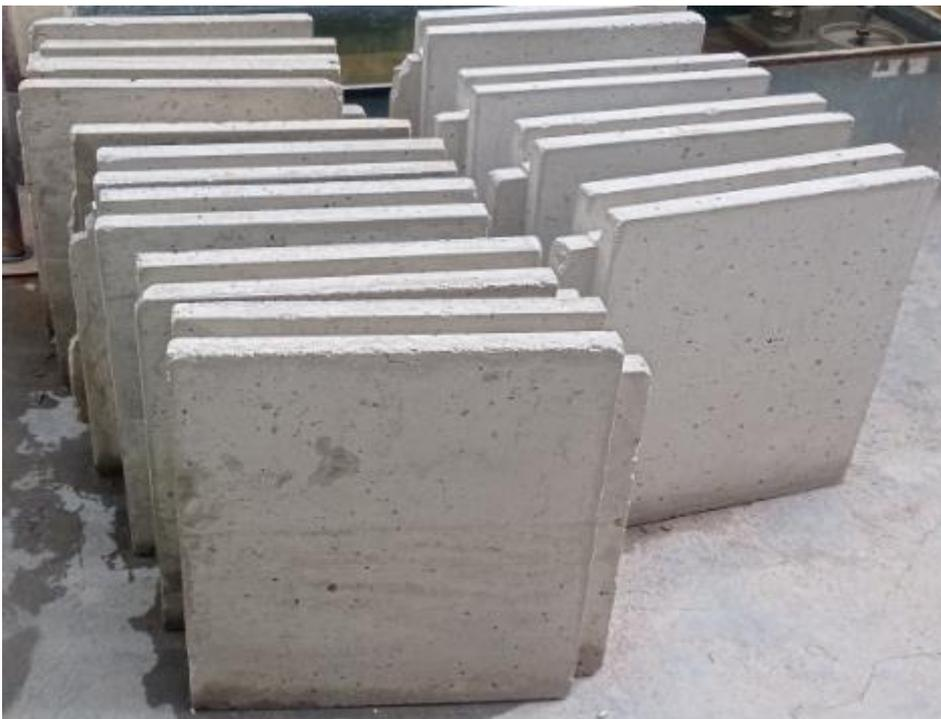
Fotografía 14. Elaboración de muretes de paneles de concreto con 25% EPS
