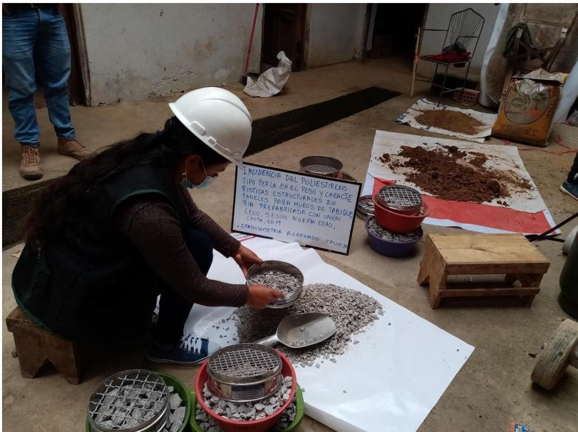
Fotografía 9. Ensayo de peso unitario suelto y compactado del agregado grueso
