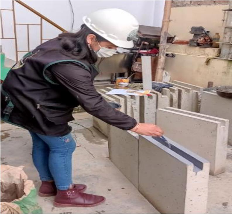
Fotografía 15. Ensayo en muretes de paneles de concreto con 25% EPS
