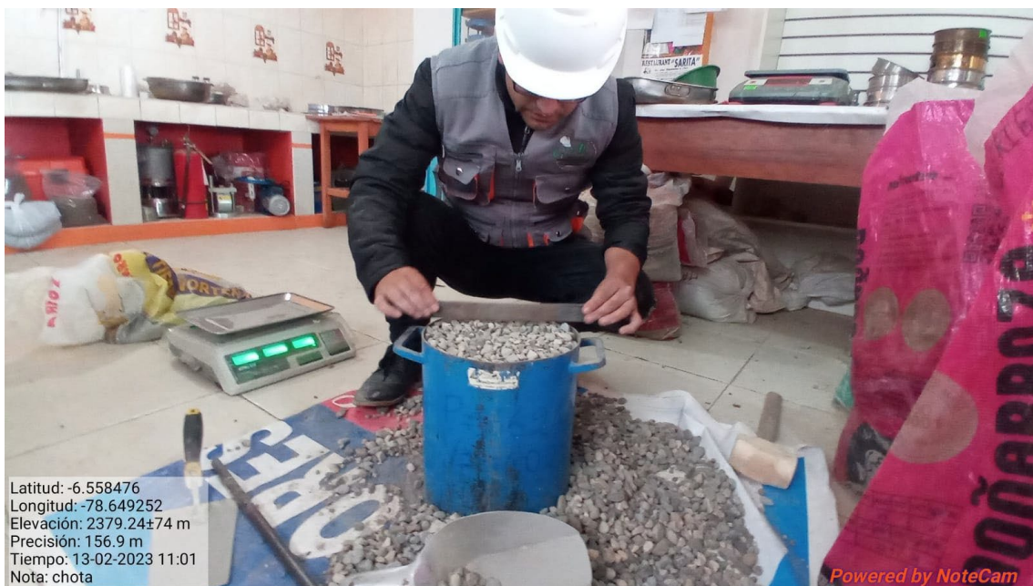
Fotografía 10. Realización del ensayo de peso unitario suelto del agregado grueso
