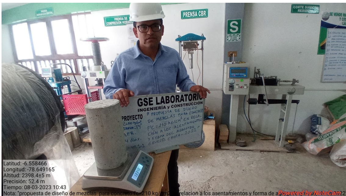
Fotografía 17. Pesado de probetas de concreto previo a la realización del ensayo de compresión
