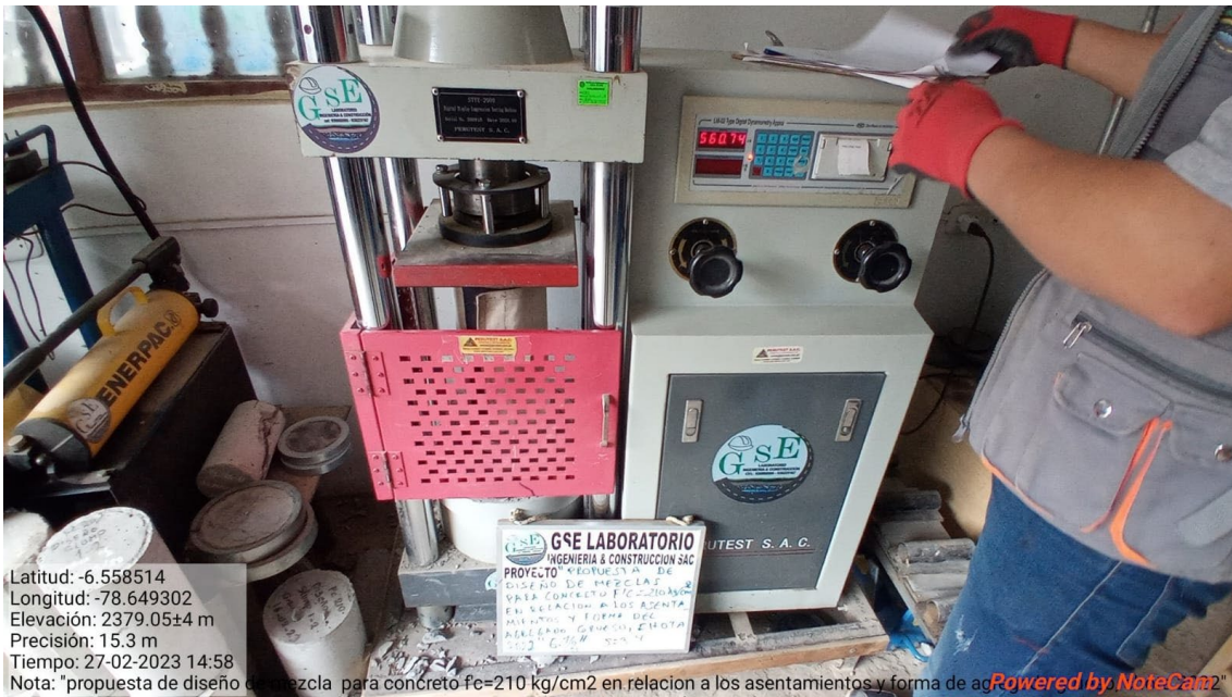
Fotografía 20. Colocación de la probeta en la máquina de ensayo de resistencia a la compresión
