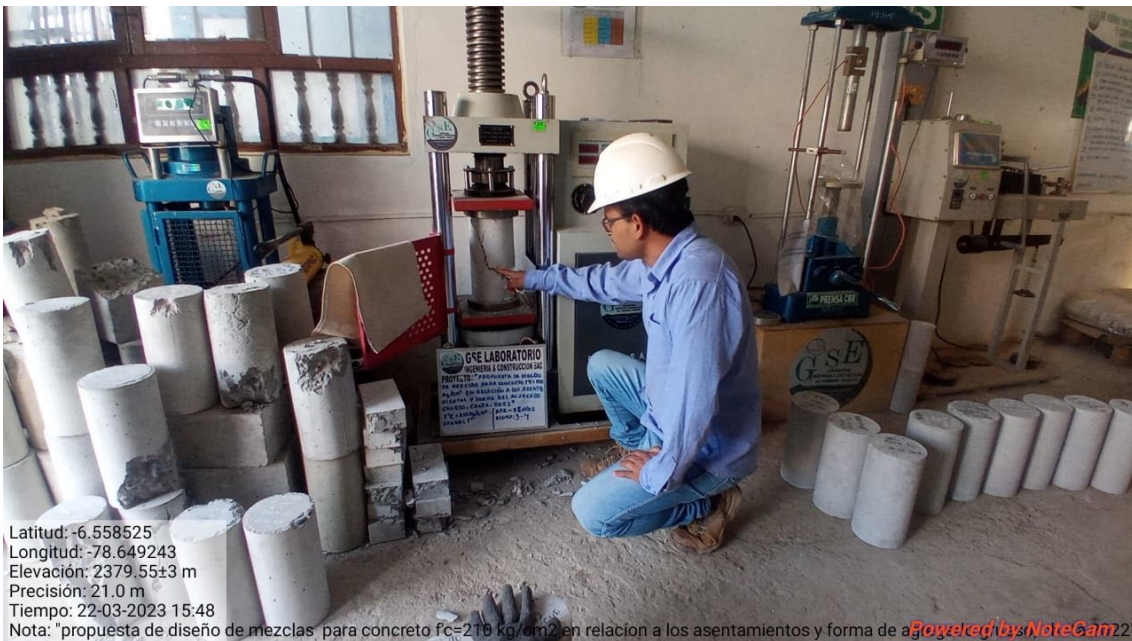
Fotografía 21. Probetas cilíndricas de concreto producidas con diferentes tipos de forma de agregados, TMN y asentamientos de mezcla
