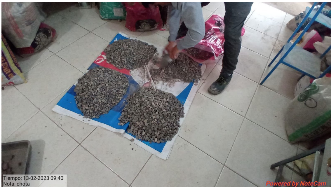
Fotografía 9. Cuarteo de la muestra de agregado grueso para la realización de los ensayos físicos y mecánicos
