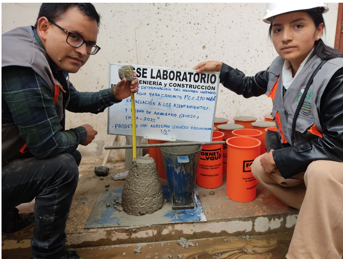
Fotografía 12. Medida del asentamiento de la mezcla de concreto con agregado redondeado de TMN 1/2"
