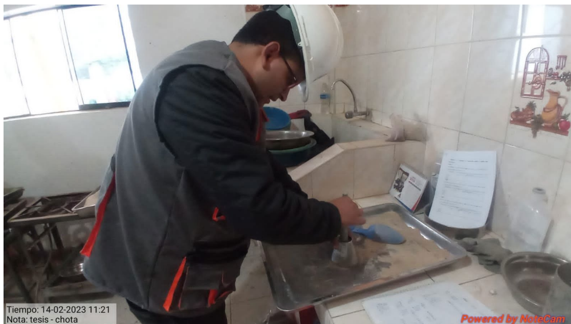
Fotografía 7. Verificación de la condición del estado saturado superficialmente seco del agregado fino
