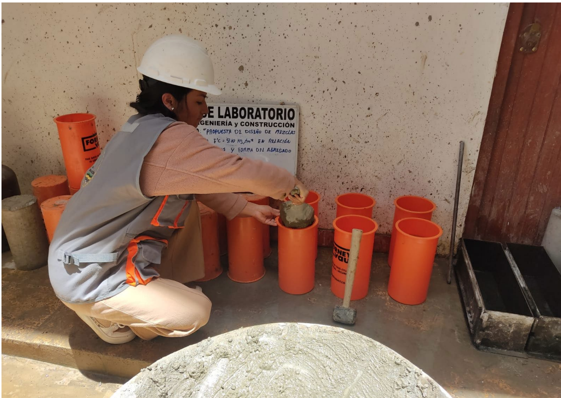
Fotografía 13. Colocación de la mezcla en los moldes cilíndricos para la elaboración de las probetas de ensayo a compresión
