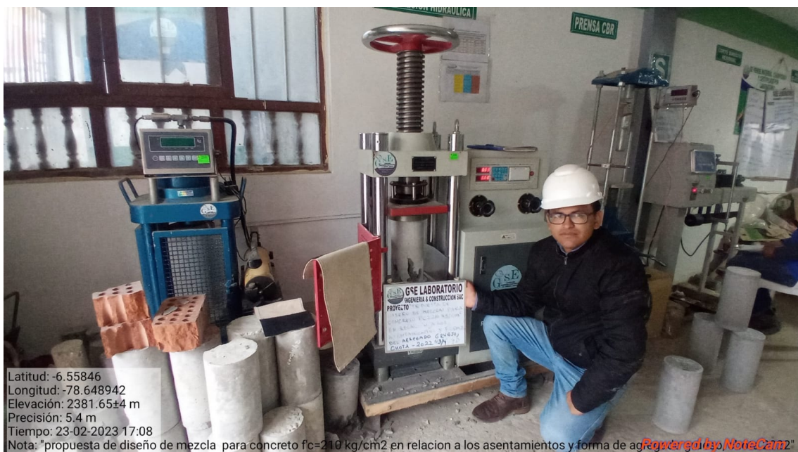
Fotografía 19. Ensayo de resistencia a la compresión en probetas cilíndricas de concreto
