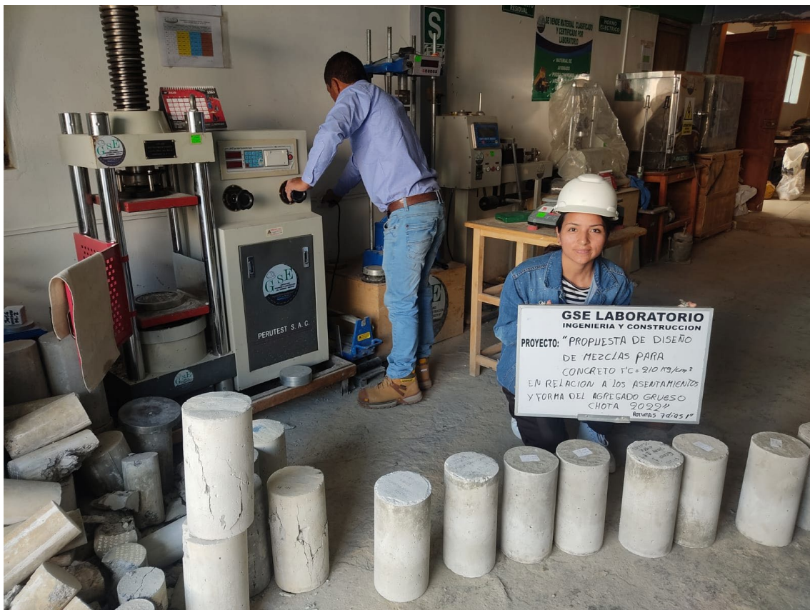
Fotografía 18. Vista de las probetas listas para la realización del ensayo de resistencia a compresión del concreto
