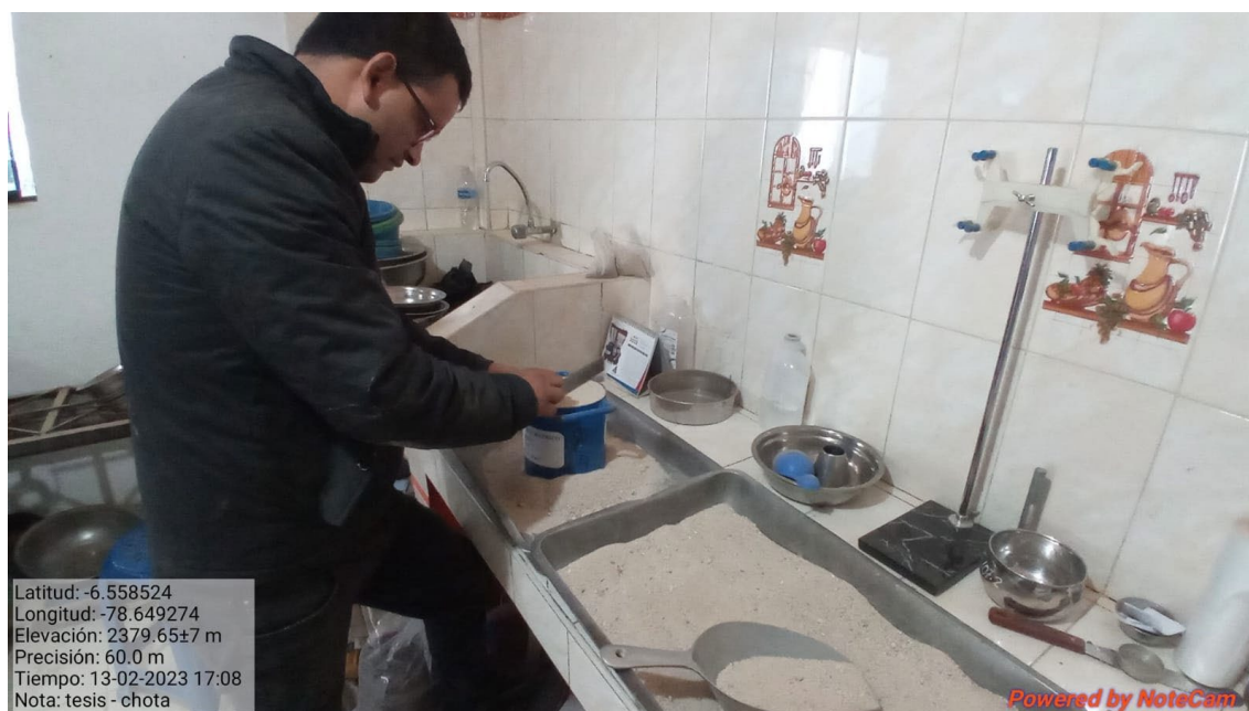
Fotografía 8. Enrasamiento de la muestra de agregado fino durante el ensayo de peso unitario suelto
