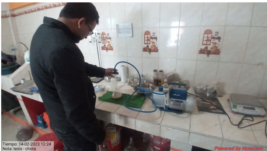
Fotografía 6. Eliminación de vacíos en la pipeta durante la realización del ensayo de peso específico
