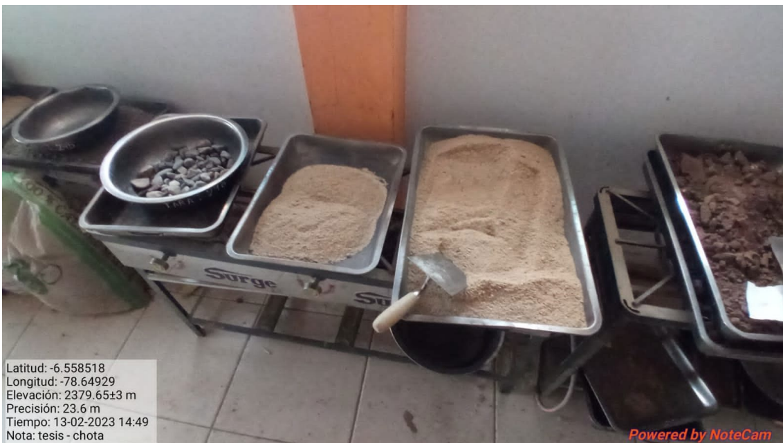
Fotografía 4. Secado del agregado fino en la estufa para la realización de ensayos físicos en el laboratorio GSE
