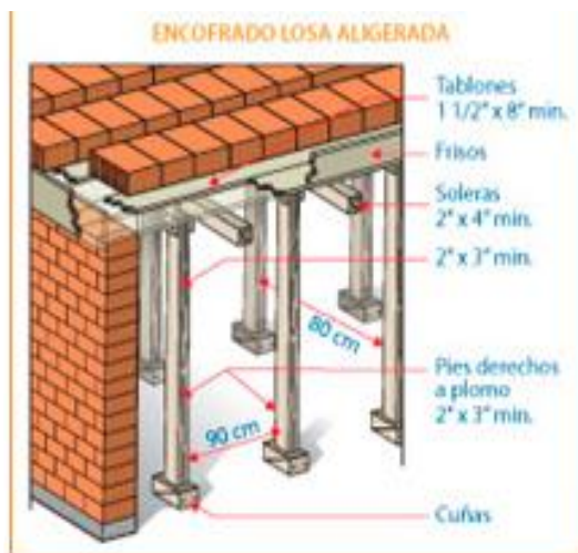
Encofrado de Losa Aligerada
