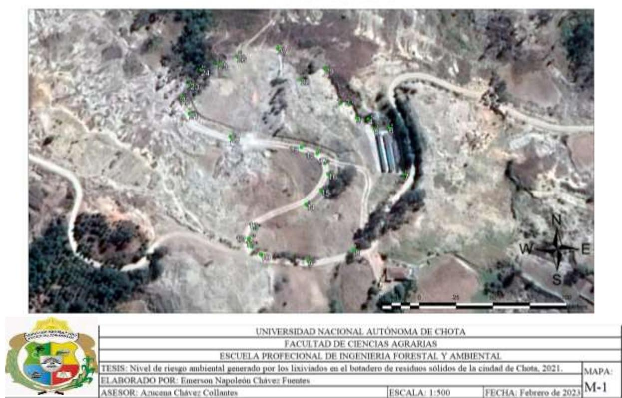
Para determinar el área en total del estudio se realizó con la colaboración de los trabajadores y un GPS, donde se efectuó la marcación de puntos alrededor del perímetro del botadero, puesto que, la municipalidad provincial de Chota, no dispone con levantamiento topográfico del área en total del botadero de los desechos de la ciudad de Chota. Como resultado de las coordenadas tomadas y posteriormente procesadas, se obtuvo aproximadamente un área de 9 577 m<sup>2</sup>.
