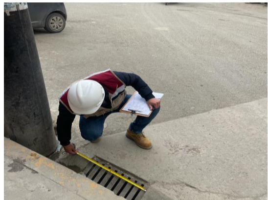
FOTO N° 18: INSPECCIÓN OCULAR DE REJILLAS EN EL SECTOR 2.
