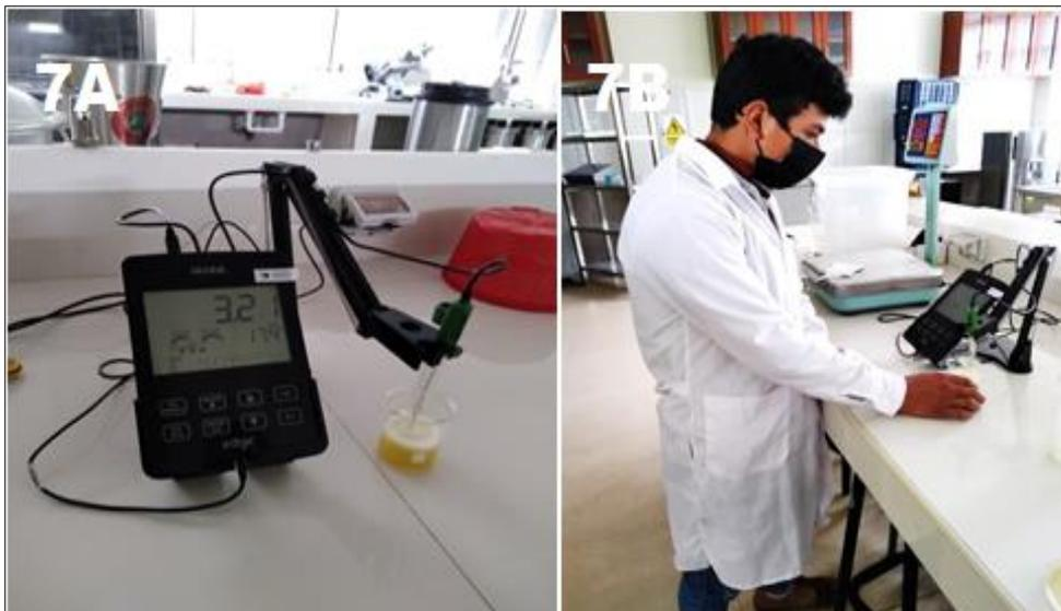
*Nota.* 7A representa el pH metro utilizado para medir el pH de las muestras, y 7B representa la determinación de pH de las muestras.
