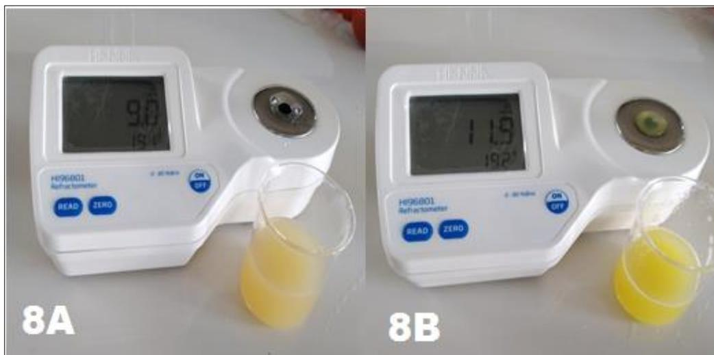
*Nota.* 8A y 8B representan a la medición de °Brix con el refractómetro digital.
