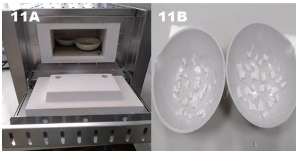
*Nota.* 11A representa la mufla que se utilizó para determinar las cenizas y 11B representa a las muestras de cenizas de yacón y piña.
