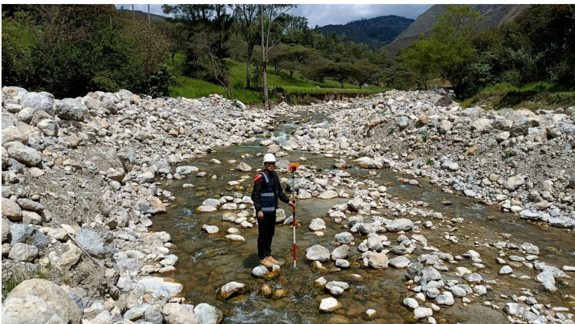
Fotografía 12. Realización del levantamiento topográfico en el cauce del río Jalqueño a las afueras de la ciudad de Lajas
