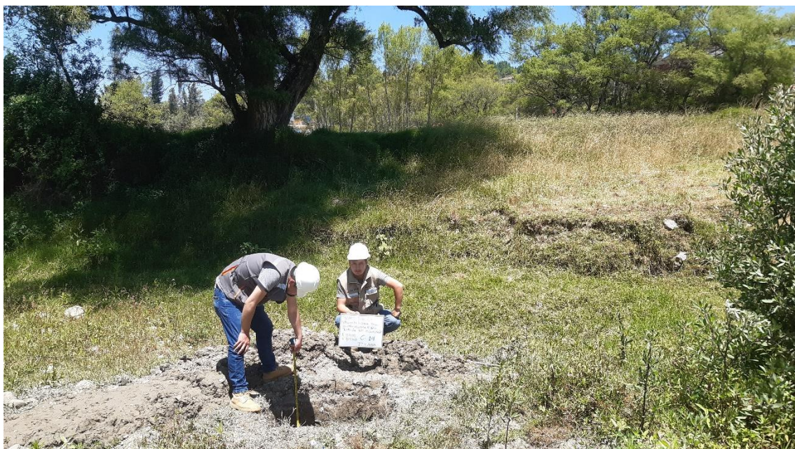
Fotografía 28. Medición de la profundidad de la calicata N°14
