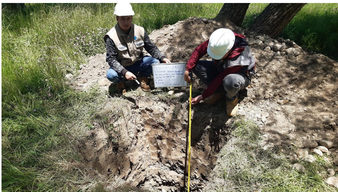
Fotografía 10. Medición de la profundidad calicata N°5
