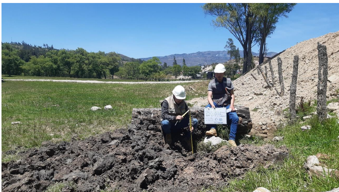
Fotografía 26. Medición de la calicata N°13
