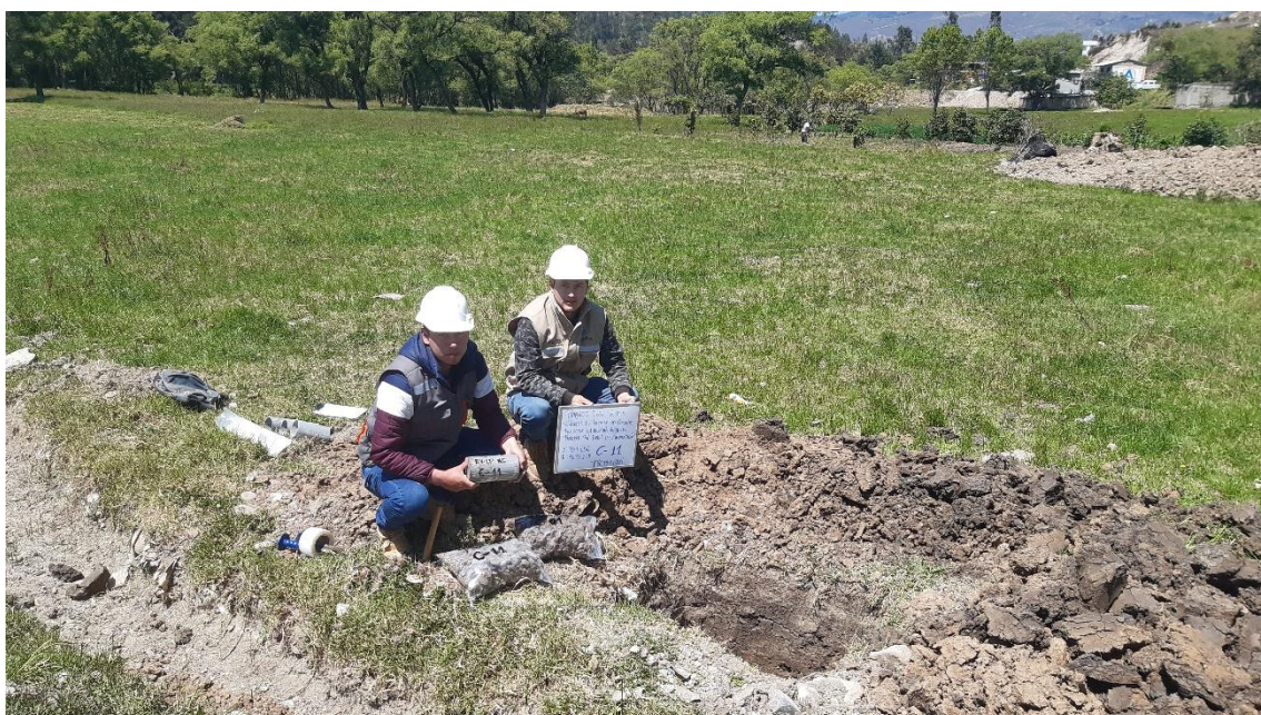
Fotografía 22. Extracción de la muestra calicata N°11
