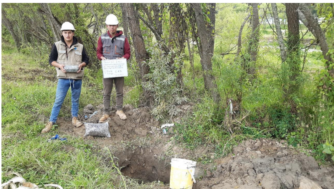
Fotografía 6. Extracción de la muestra de la calicata N°3
