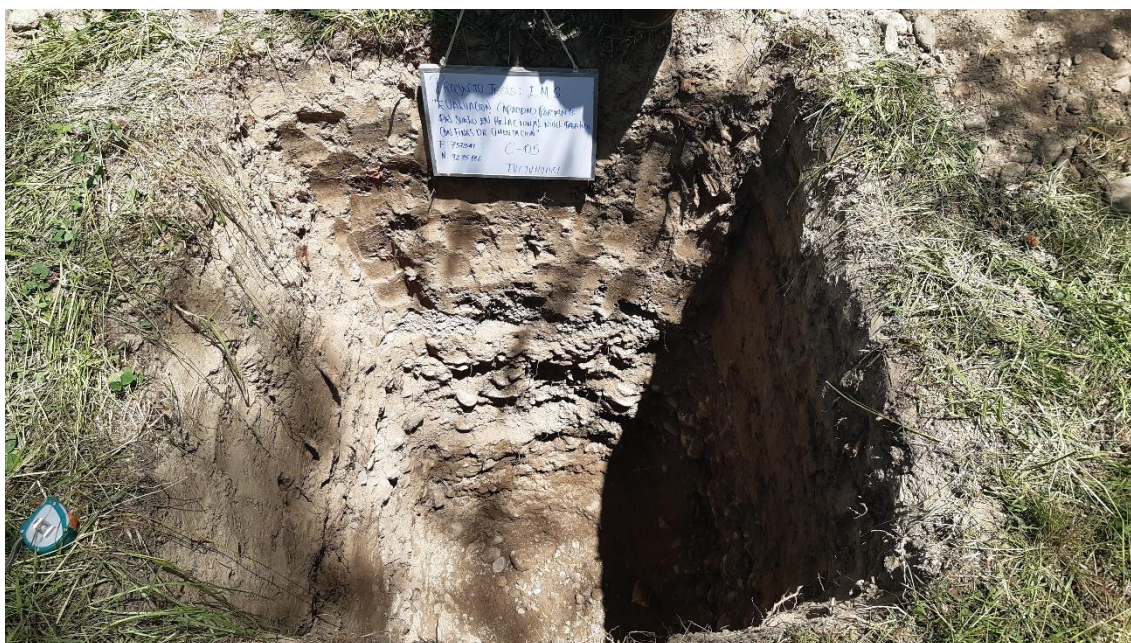
Fotografía 10. Medición de la profundidad calicata N°5
