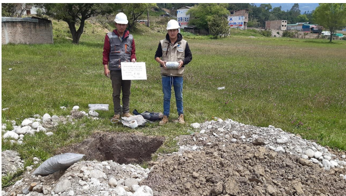
Fotografía 20. Extracción de la muestra calicata N°10
