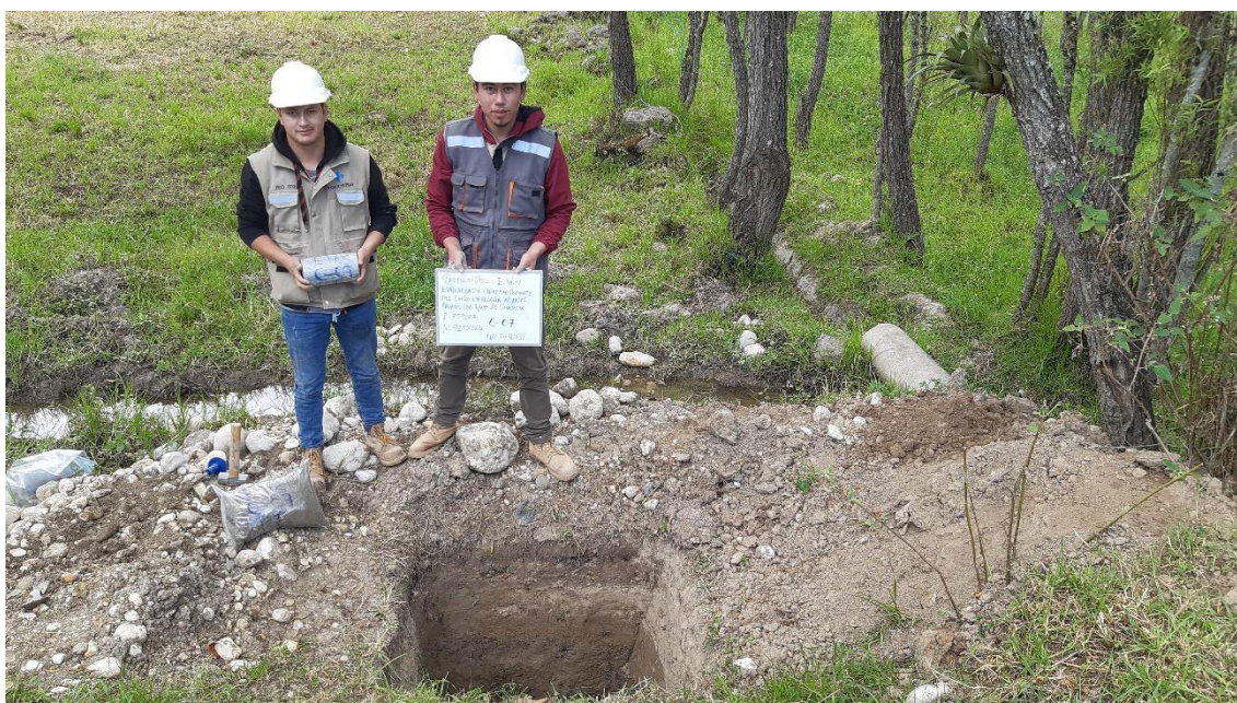
Fotografía 14. Extracción de la muestra de la calicata N°7
