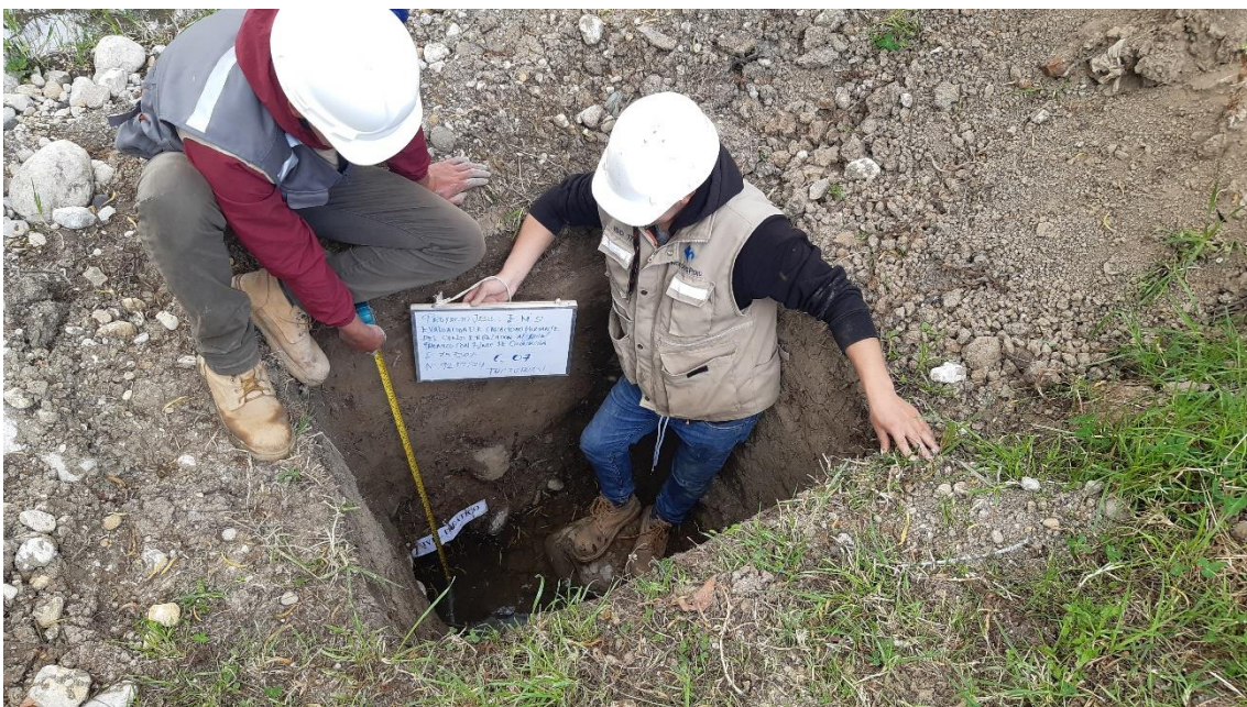
Fotografía 30. Verificación del nivel freático calicata N°7.
