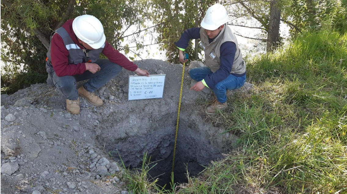
Fotografía 2. Extracción de la muestra calicata N°1
