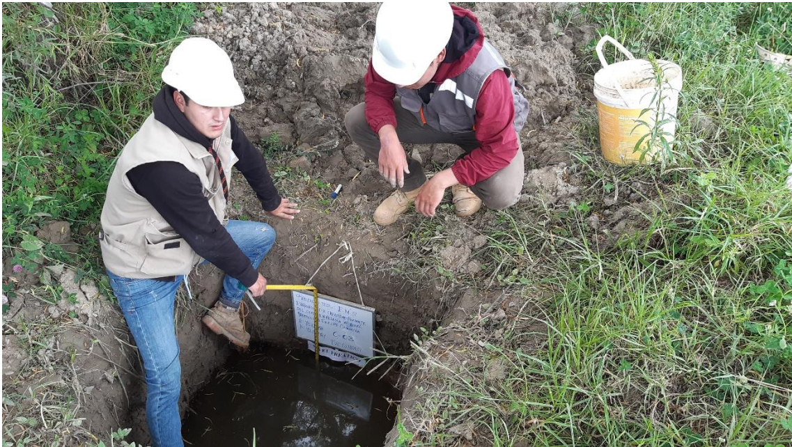
Fotografía 28. Medición del nivel freático calicata N°4.
