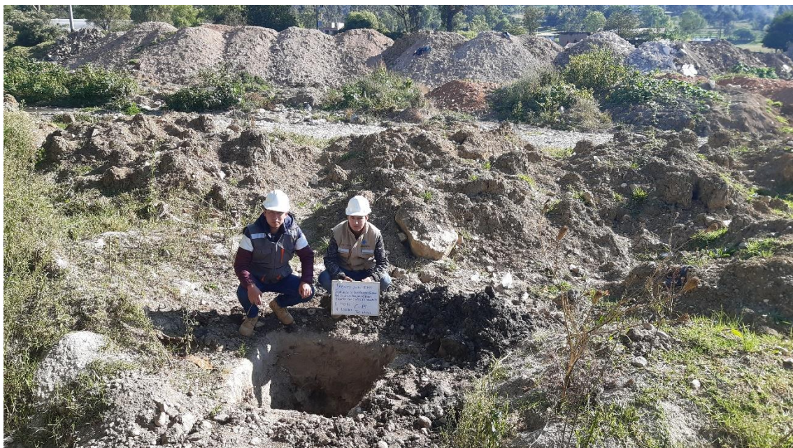
Fotografía 27. Medición de profundidad de la calicata N°15
