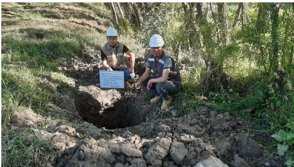
Fotografía 6. Extracción de la muestra de la calicata N°3
