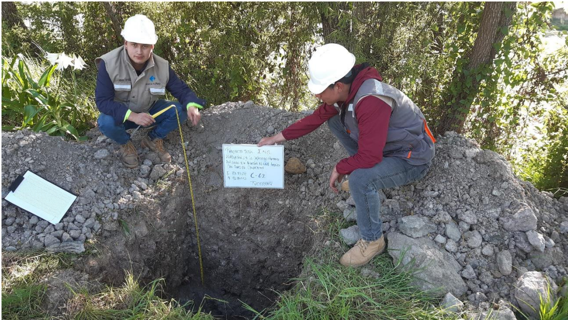
Fotografía 4. Extracción de la muestra calicata N°2
