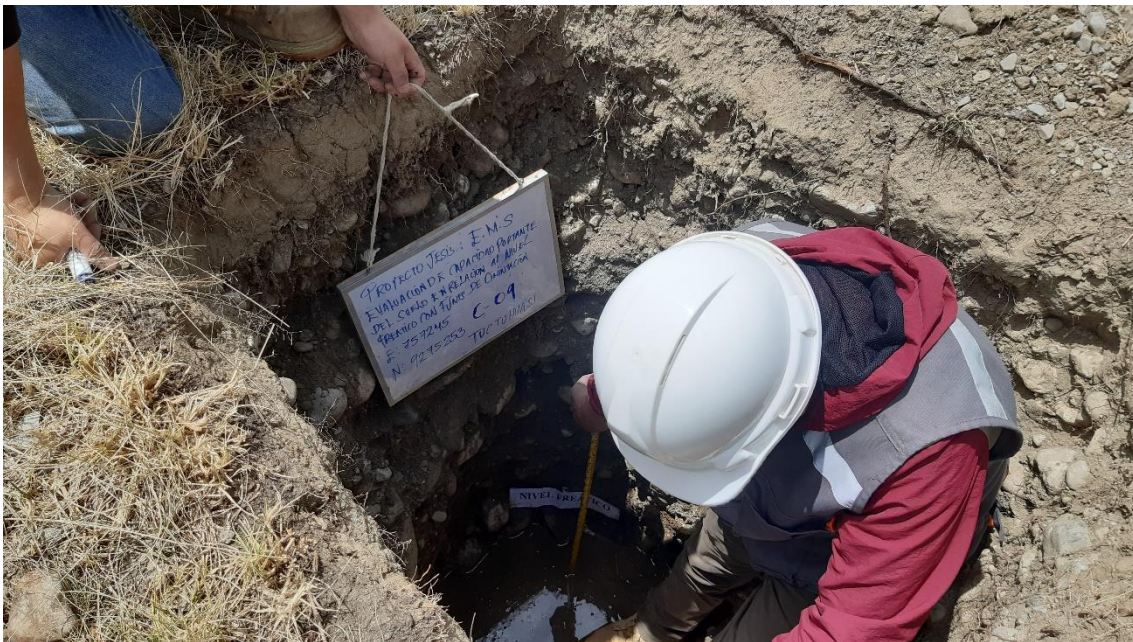
Fotografía 32. Control del nivel freático calicata N°13.
