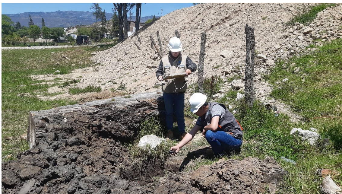
Fotografía 26. Medición de la calicata N°13
