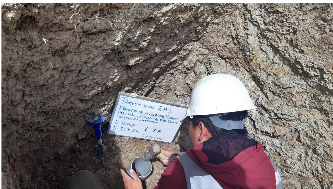
Fotografía 16. Extracción de la muestra de la calicata N°8
