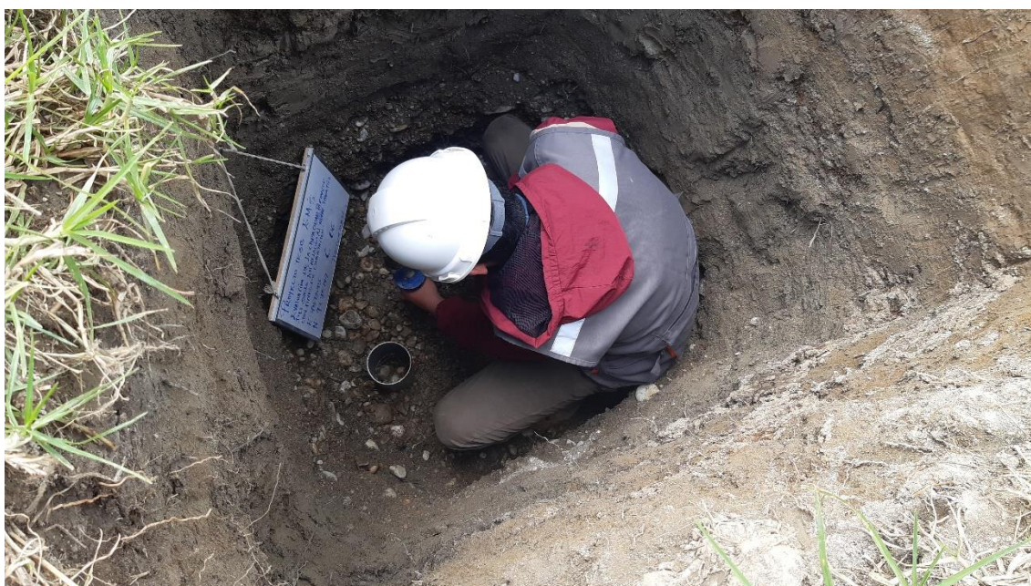
Fotografía 12. Extracción de la muestra de la calicata N°6
