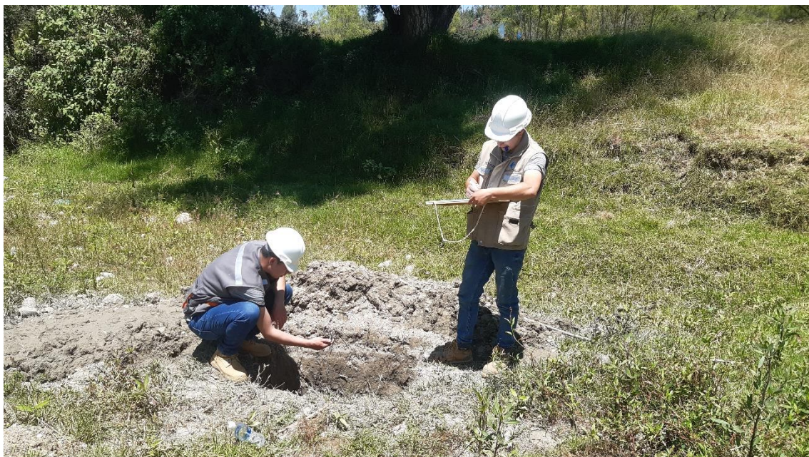
Fotografía 28. Medición de la profundidad de la calicata N°14
