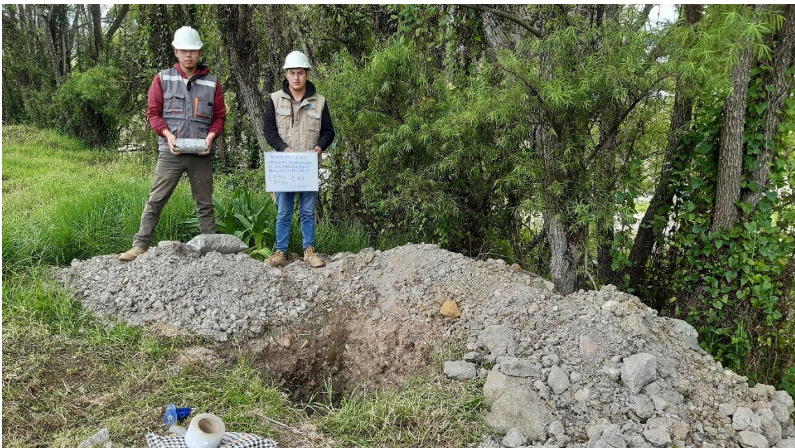
Fotografía 4. Extracción de la muestra calicata N°2
