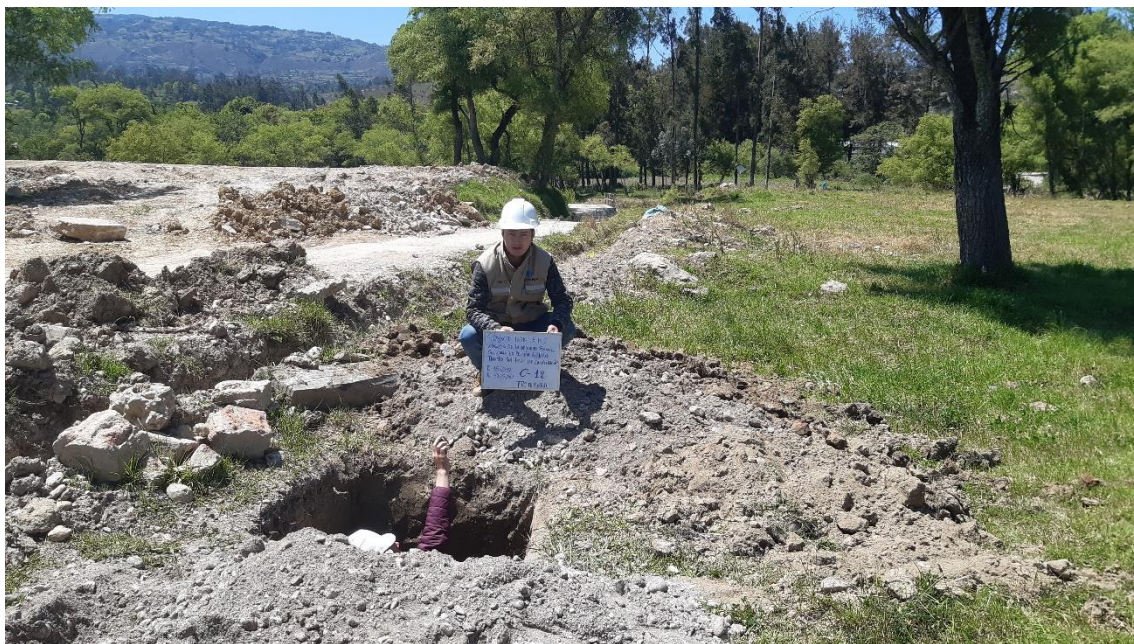
Fotografía 24. Extracción de la muestra calicata N°12
