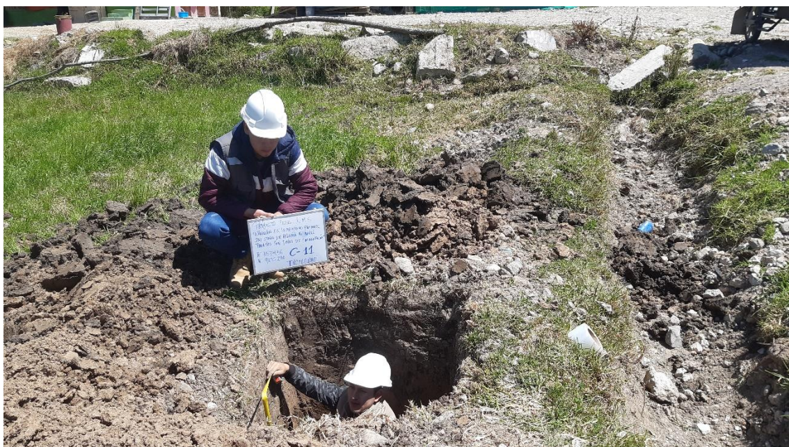
Fotografía 22. Extracción de la muestra calicata N°11
