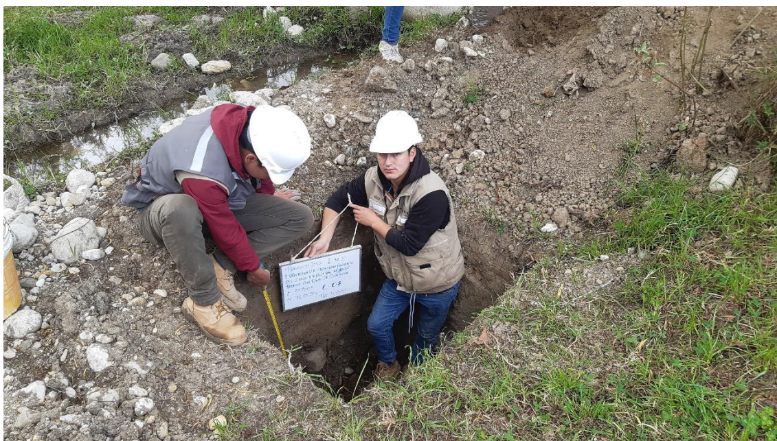
Fotografía 14. Extracción de la muestra de la calicata N°7
