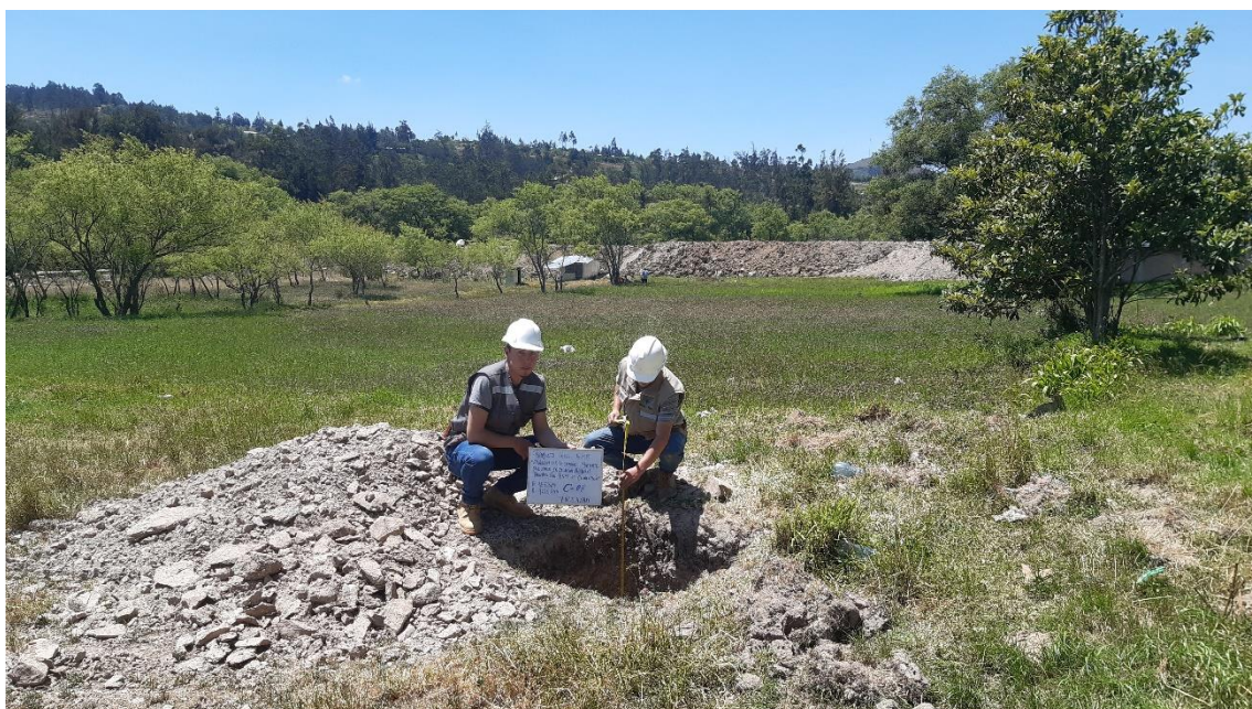
Fotografía 16. Extracción de la muestra de la calicata N°8
