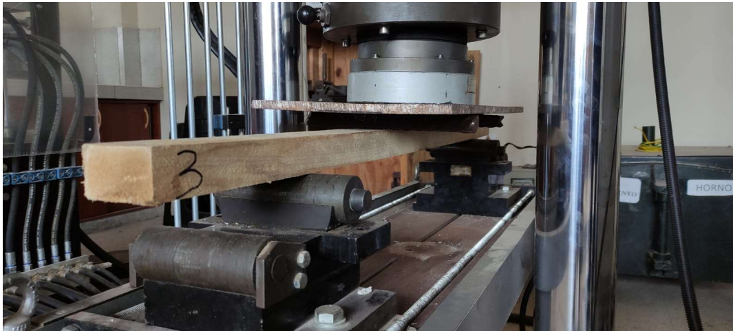
Fotografía 21. Ensayo de flexión de la viga de madera del árbol N° 3
