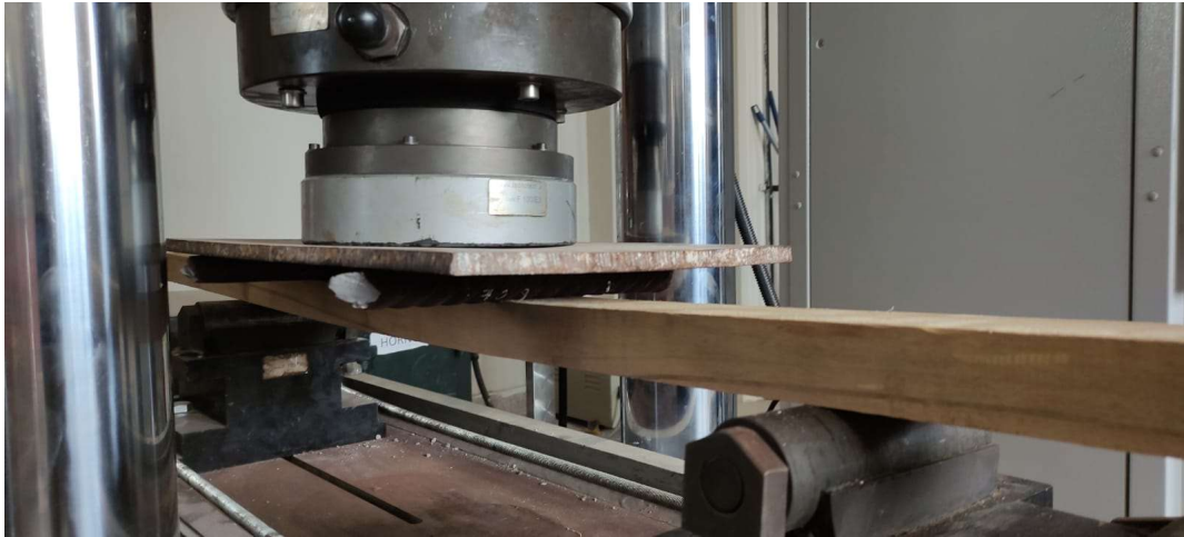
Fotografía 23. Ensayo de flexión de la viga de madera del árbol N° 5
