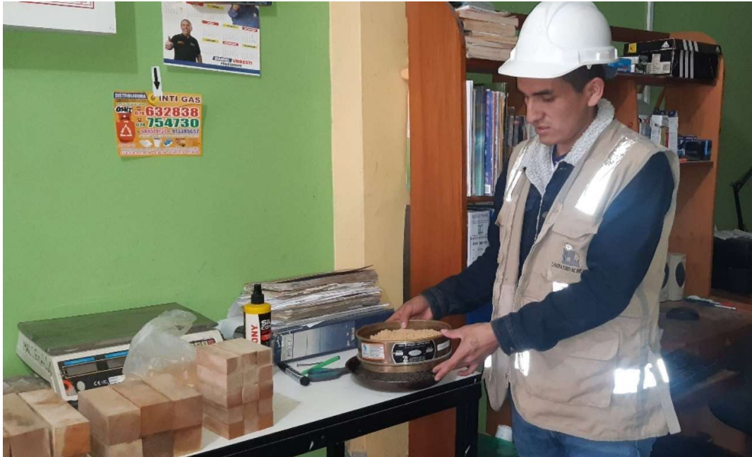
Fotografía 13. Tamizado del aserrín para el ensayo de contenido de humedad
