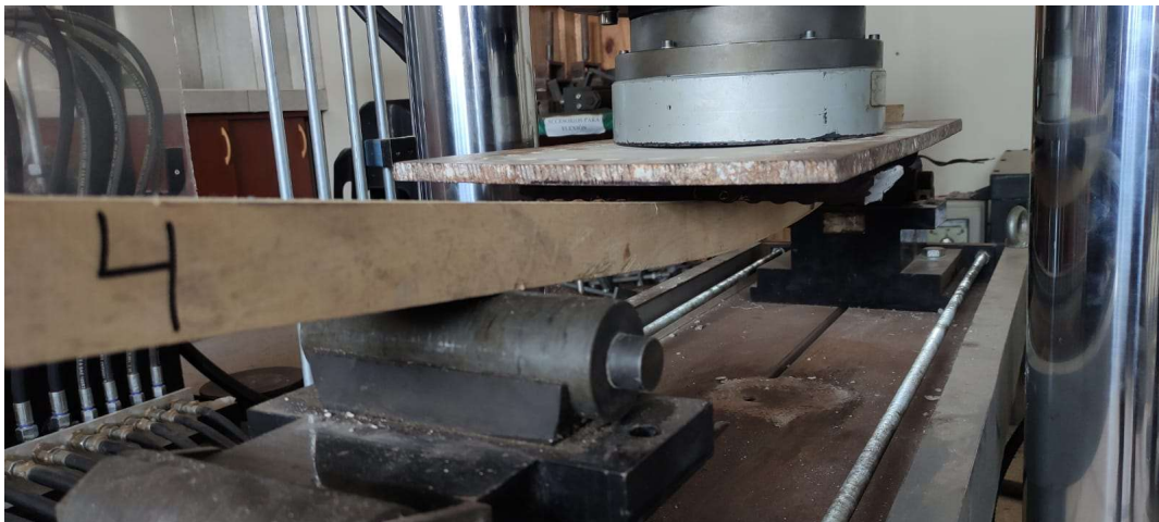
Fotografía 22. Ensayo de flexión de la viga de madera del árbol N° 4
