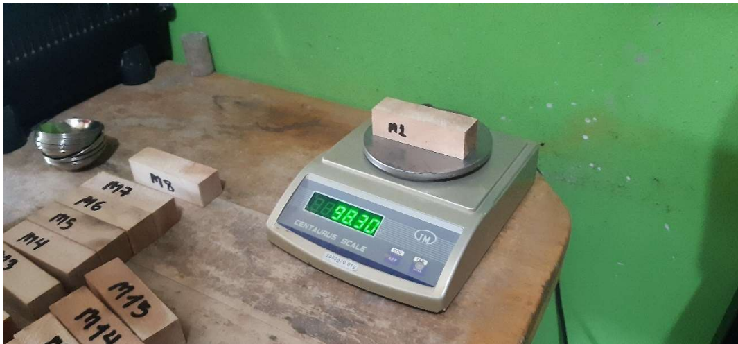
Fotografía 12. Ensayo de densidad básica
