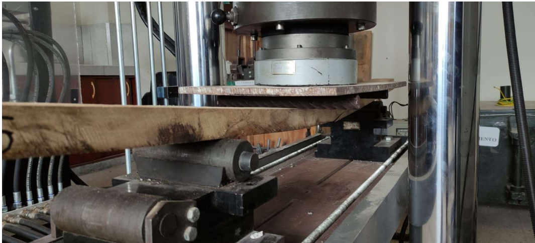
Fotografía 24. Ensayo de flexión de viga de madera del árbol N° 6
