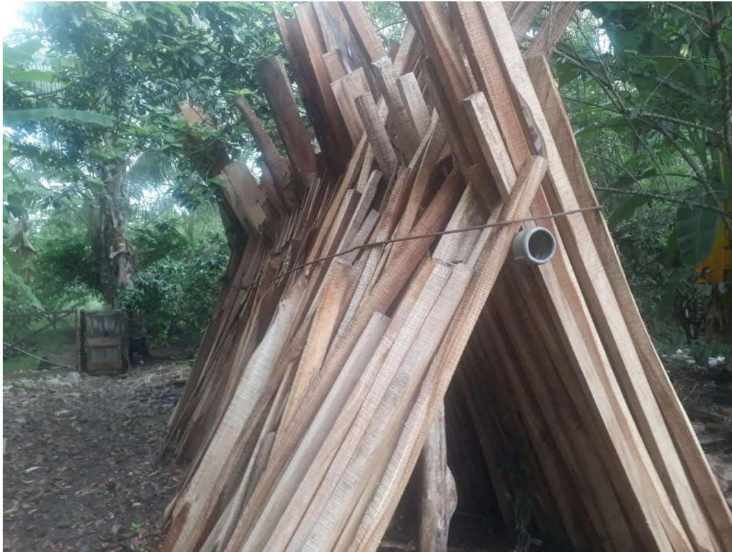
Fotografía 15. Secado de Vigas de Madera
