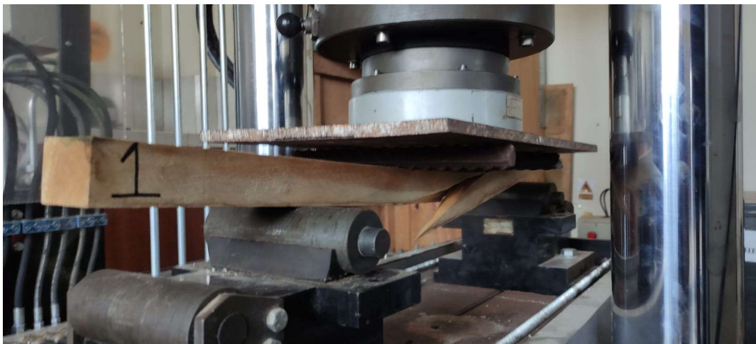
Fotografía 19. Ensayo de flexión de la viga de madera del árbol N° 1
