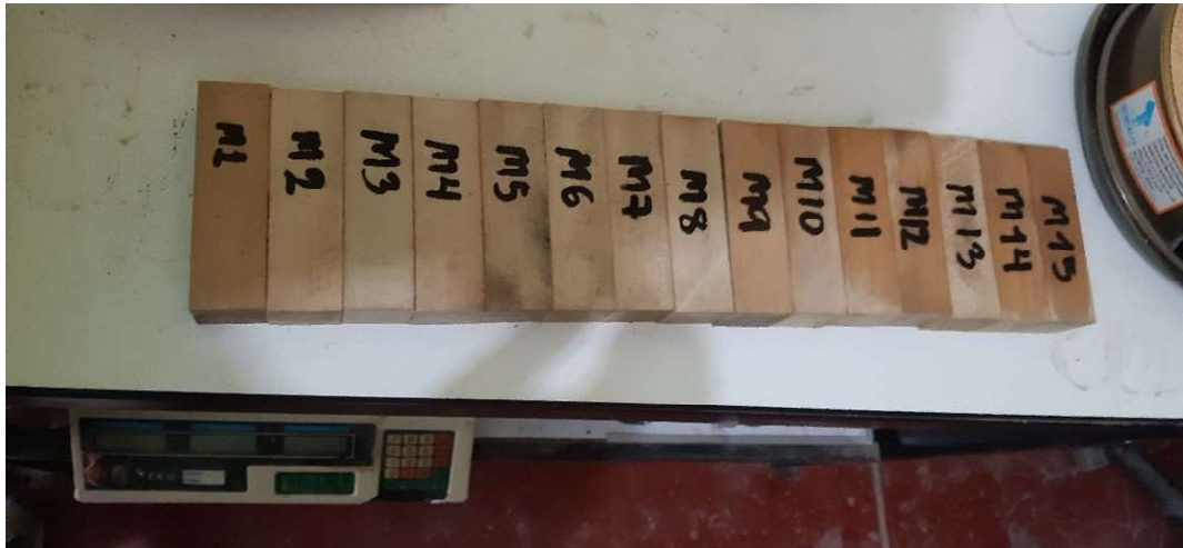
Fotografía 12. Ensayo de densidad básica
