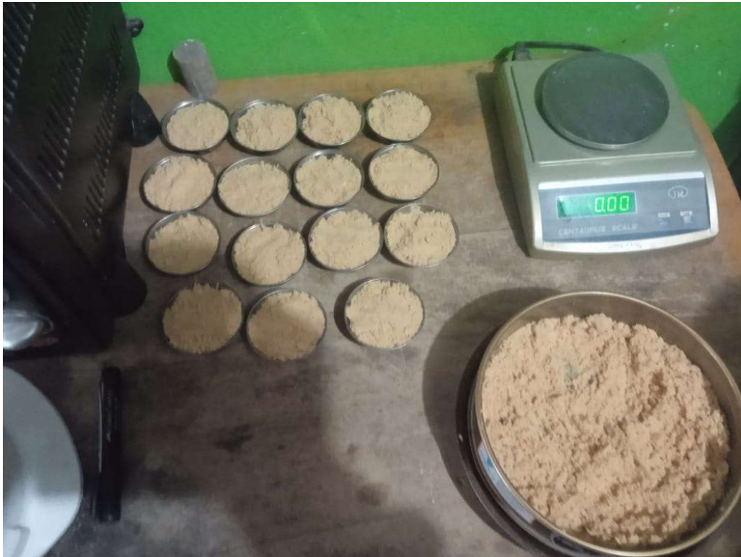
Fotografía 14. Ensayo de contenido de humedad gravimétrica
