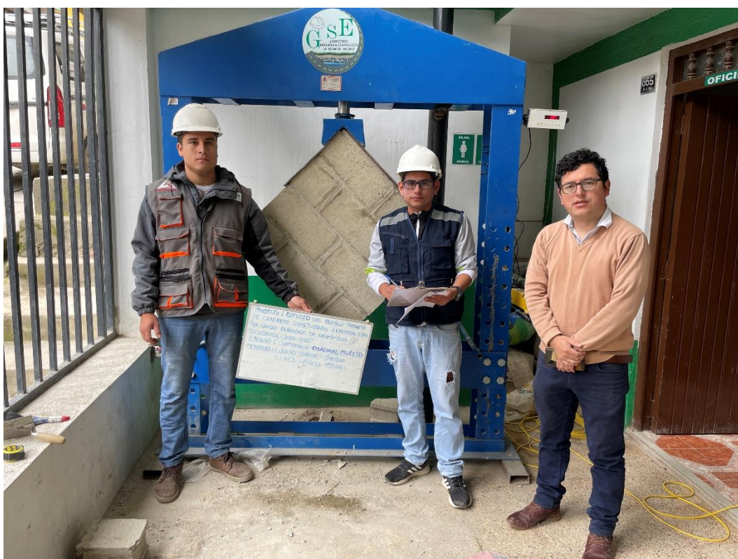
Fotografía 22. Resistencia a la Compresión Diagonal en Muretes
