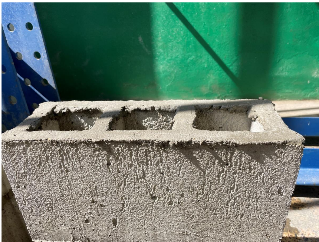
Fotografía 16. Refrentado de las Muestras Ensayadas
