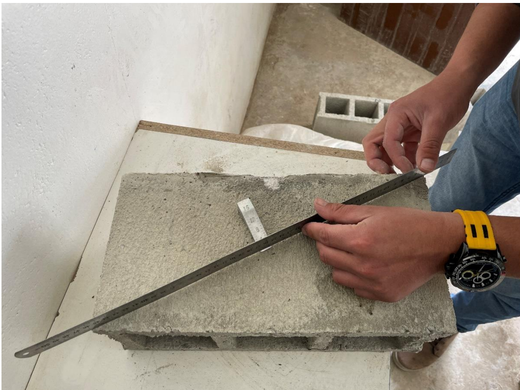
Fotografía 12. Ensayo de Alabeo con Ayuda de una Cuña Milimétrica
