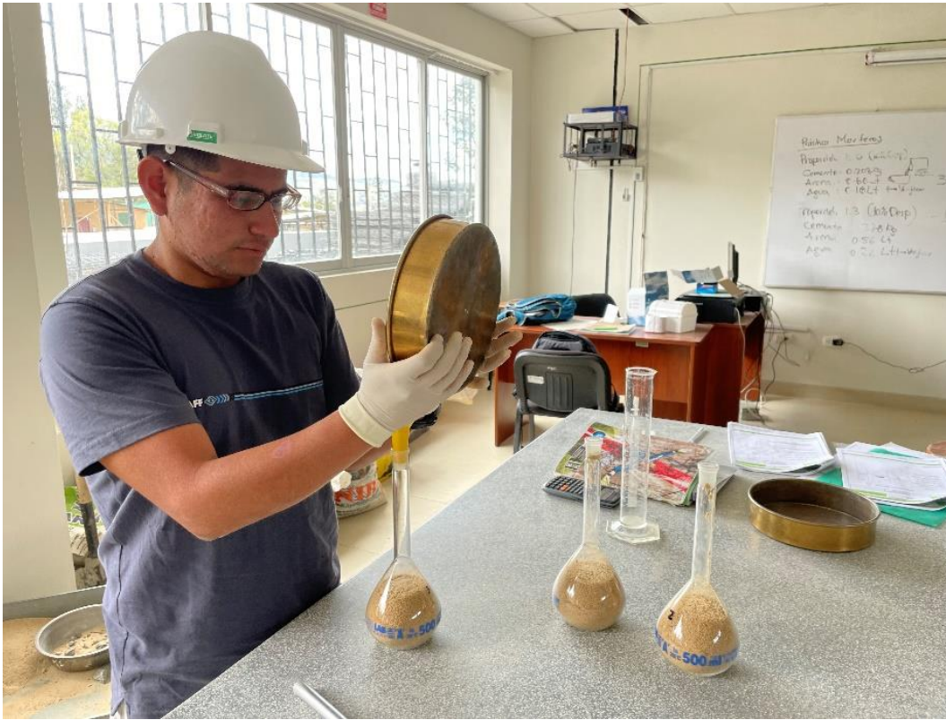
Fotografía 7. Ensayo de Peso Específico del Agregado Fino
