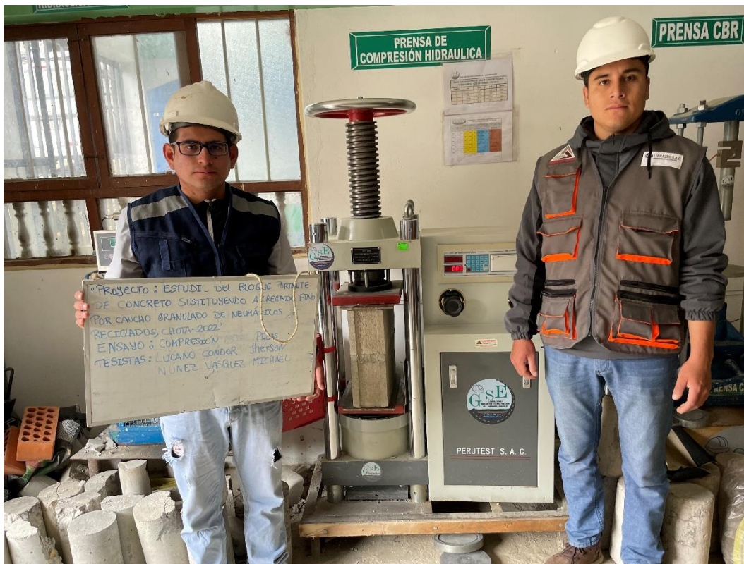
Fotografía 19. Resistencia a la compresión en Pilas
