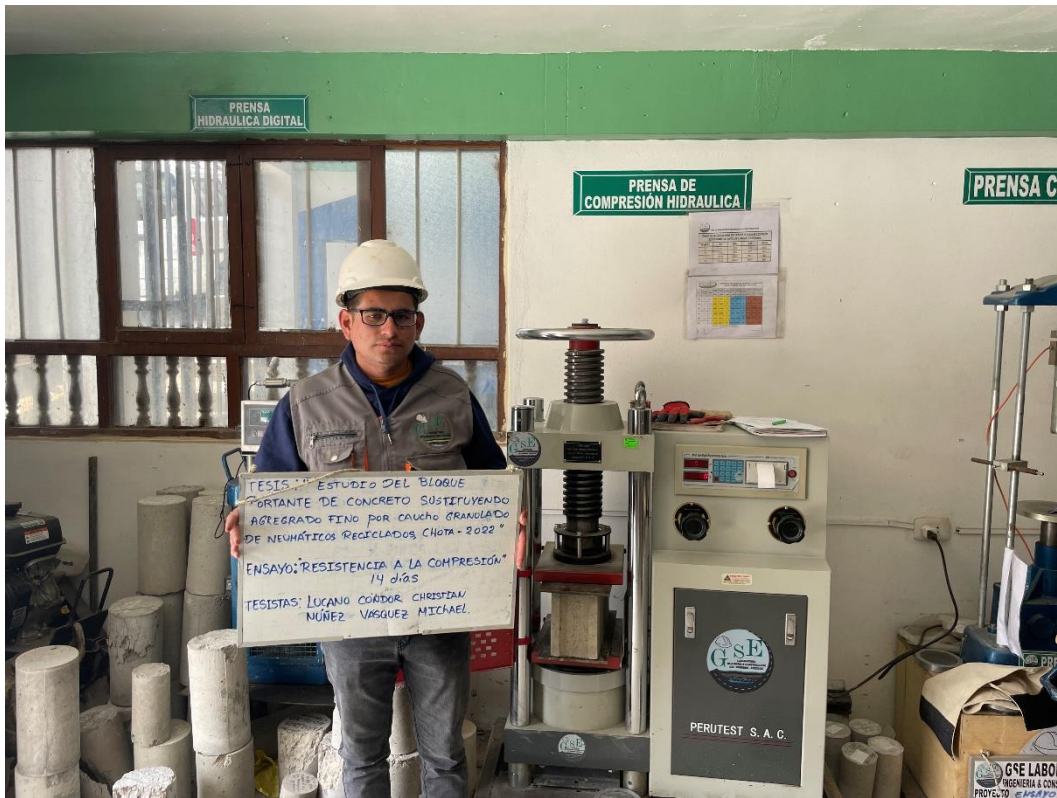
Fotografía 18. Resistencia a la Compresión de Cubos del Mortero
