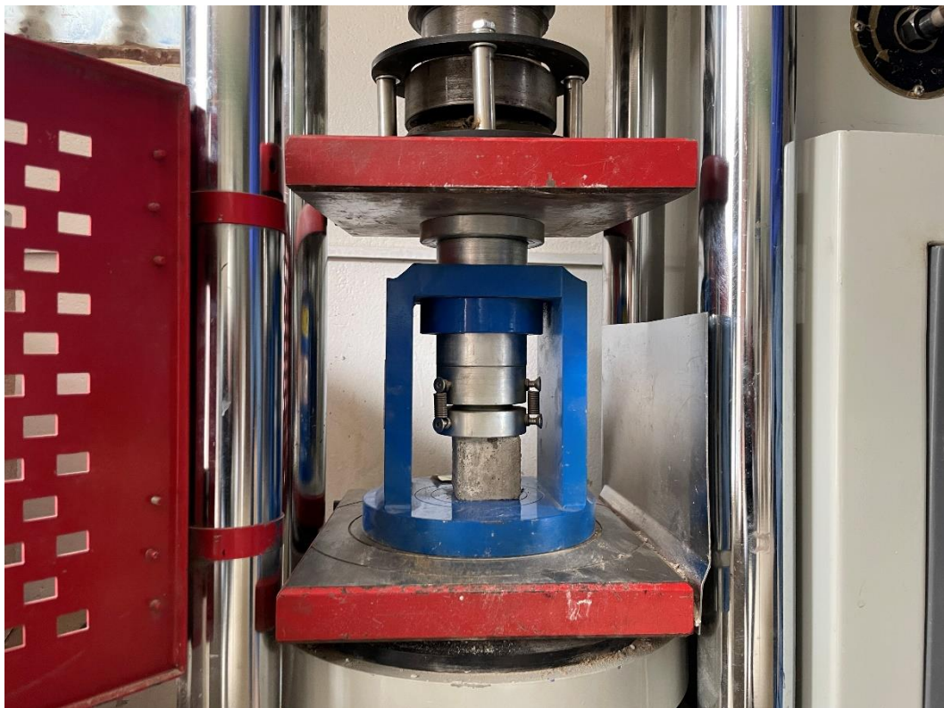
Fotografía 18. Resistencia a la Compresión de Cubos del Mortero
