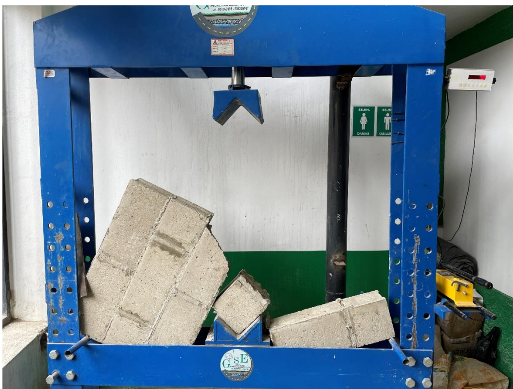
Fotografía 22. Resistencia a la Compresión Diagonal en Muretes
