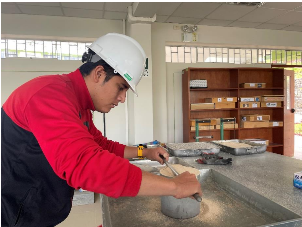
Fotografía 6. Ensayo de Peso Unitario del Agregado Fino
