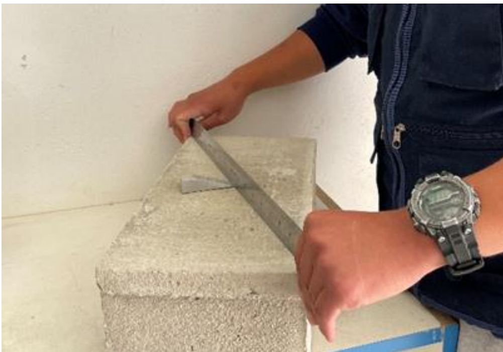
Ensayo de Alabeo con Ayuda de una Cuña
