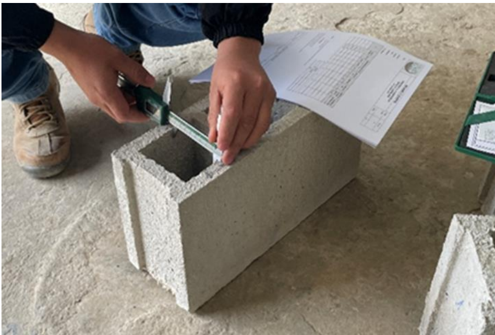
Medición del Área Vacía de la Unidad Ensayada
