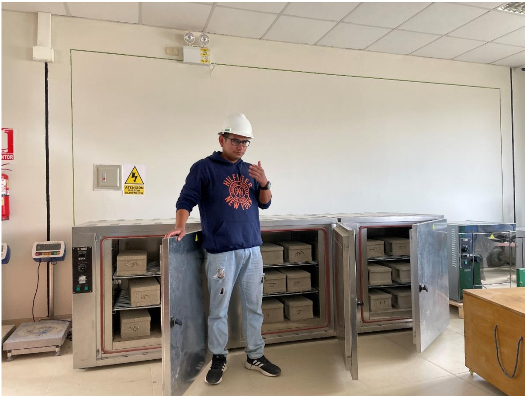
Fotografía 14. Bloques Secos Puestos en Horno por 24 Horas
