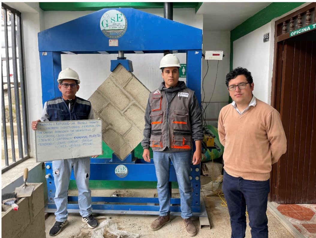
Fotografía 20. Resistencia a la Compresión Diagonal en Muretes
