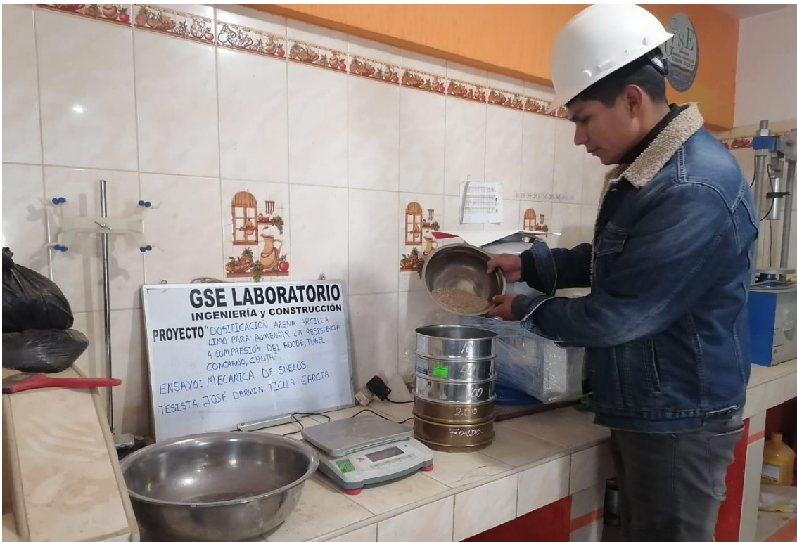
Fotografía 9 Ensayo de granulometría en el suelo de las canteras
