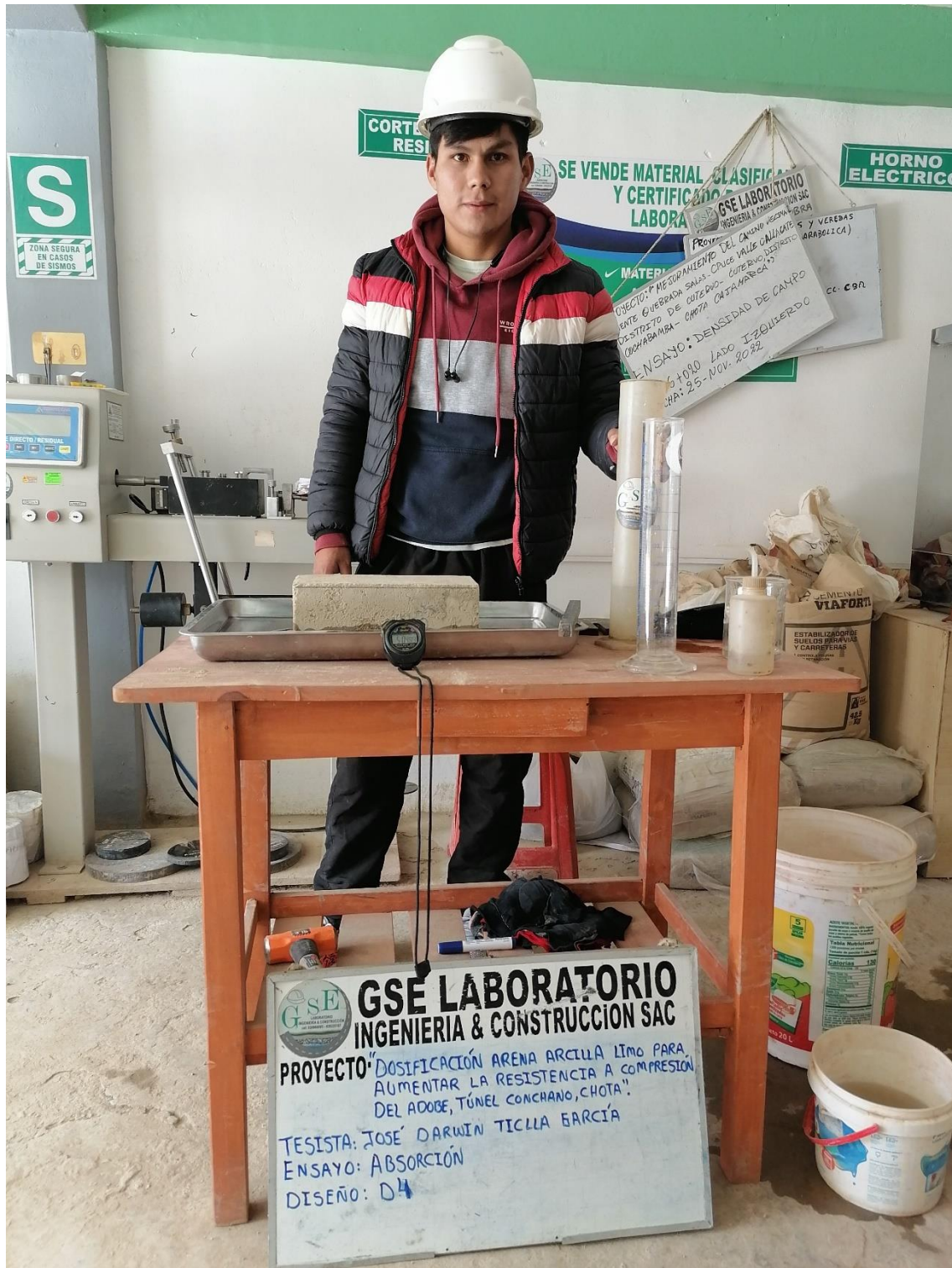
Fotografía 20 Ensayo de absorción por capilaridad en adobes
