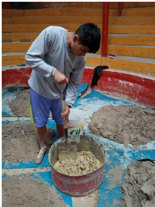
Colocación de agua al suelo
