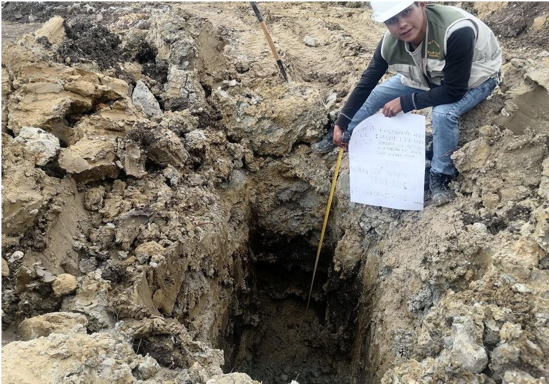
Fotografía 7 Toma de muestras en la cantera de limo Túnel Conchano
