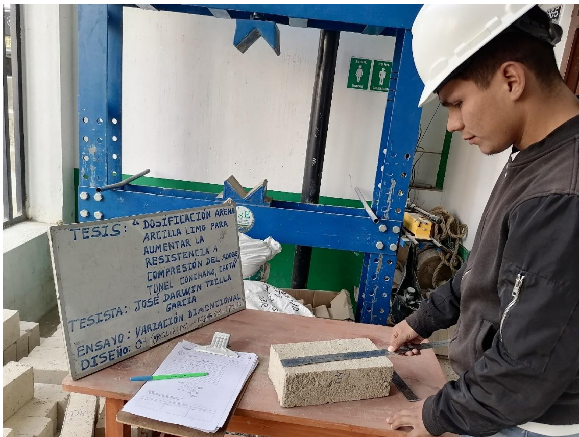
Fotografía 19 Ensayo de alabeo en adobes
