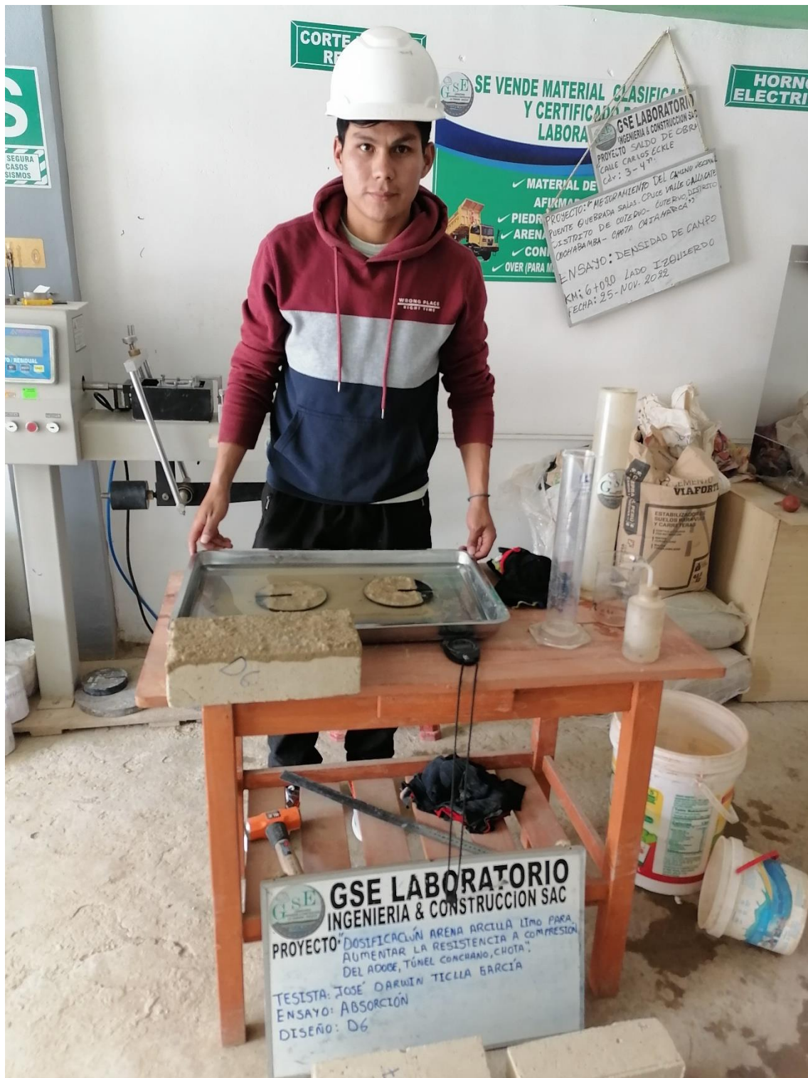
Fotografía 21 Vista de espécimen después del ensayo de absorción por capilaridad
