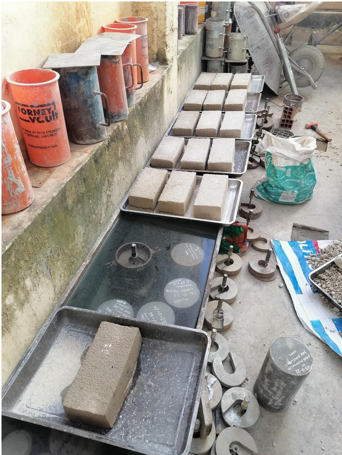
Fotografía 22 Vista de los diferentes adobes sometidos al ensayo de absorción por capilaridad
