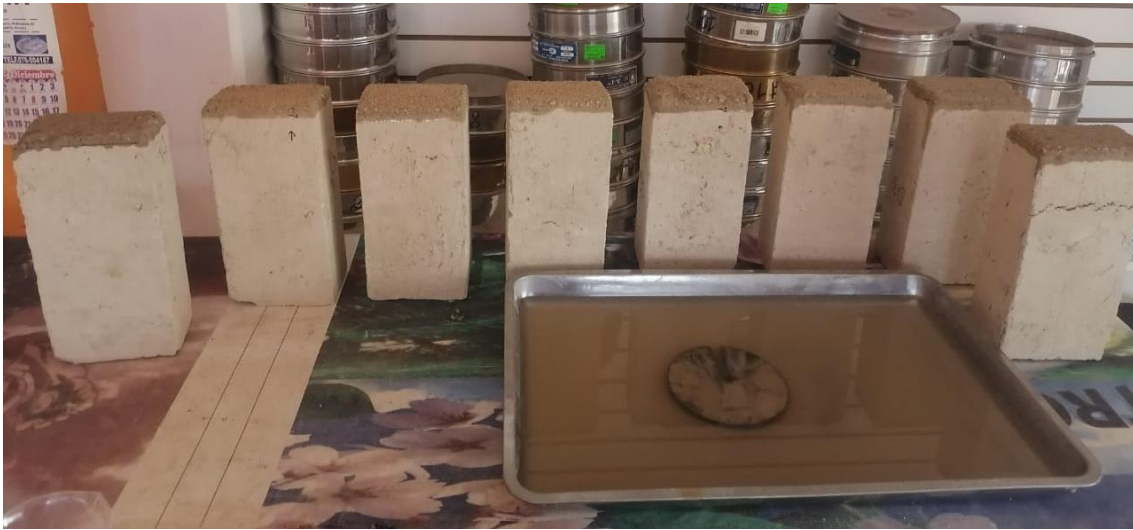
Fotografía 26 Secado de las muestras y registro del deterioro en el ensayo de humectación/secado
