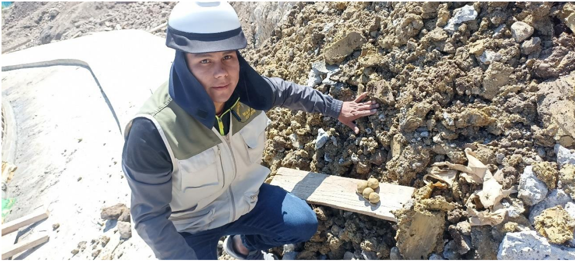
Fotografía 4 Verificación in situ del tipo de suelo: prueba de resistencia seca
