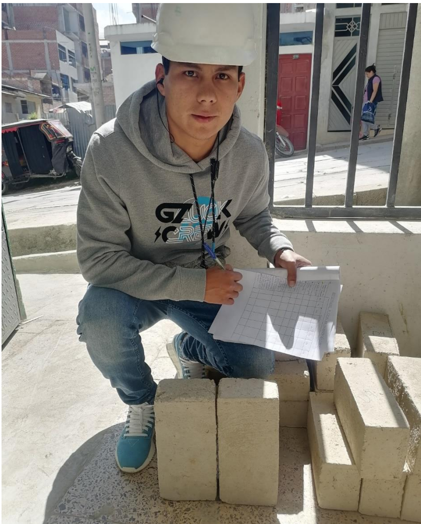
Fotografía 26 Secado de las muestras y registro del deterioro en el ensayo de humectación/secado
