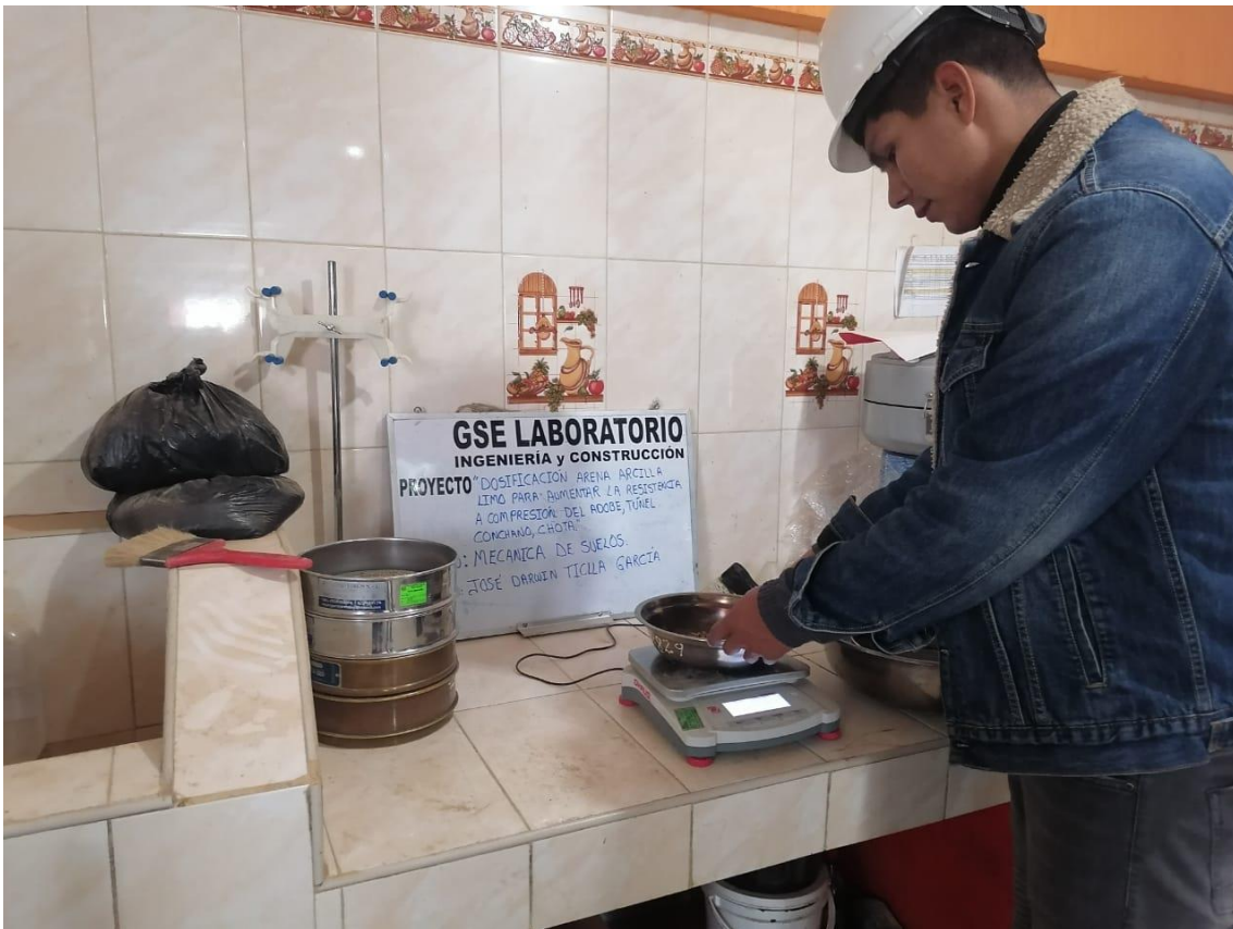
Fotografía 9 Ensayo de granulometría en el suelo de las canteras
