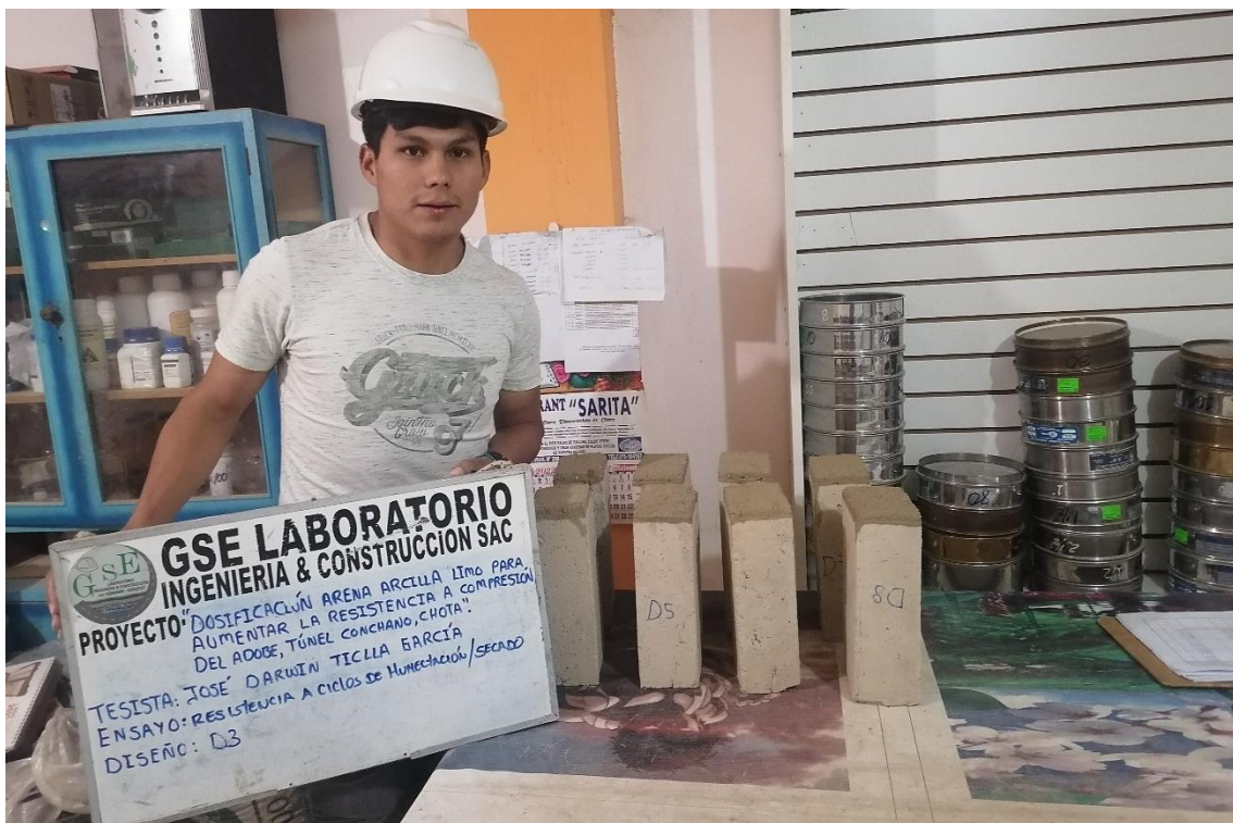
Fotografía 24 Ensayo de resistencia a procesos de humectación/secado en adobes
