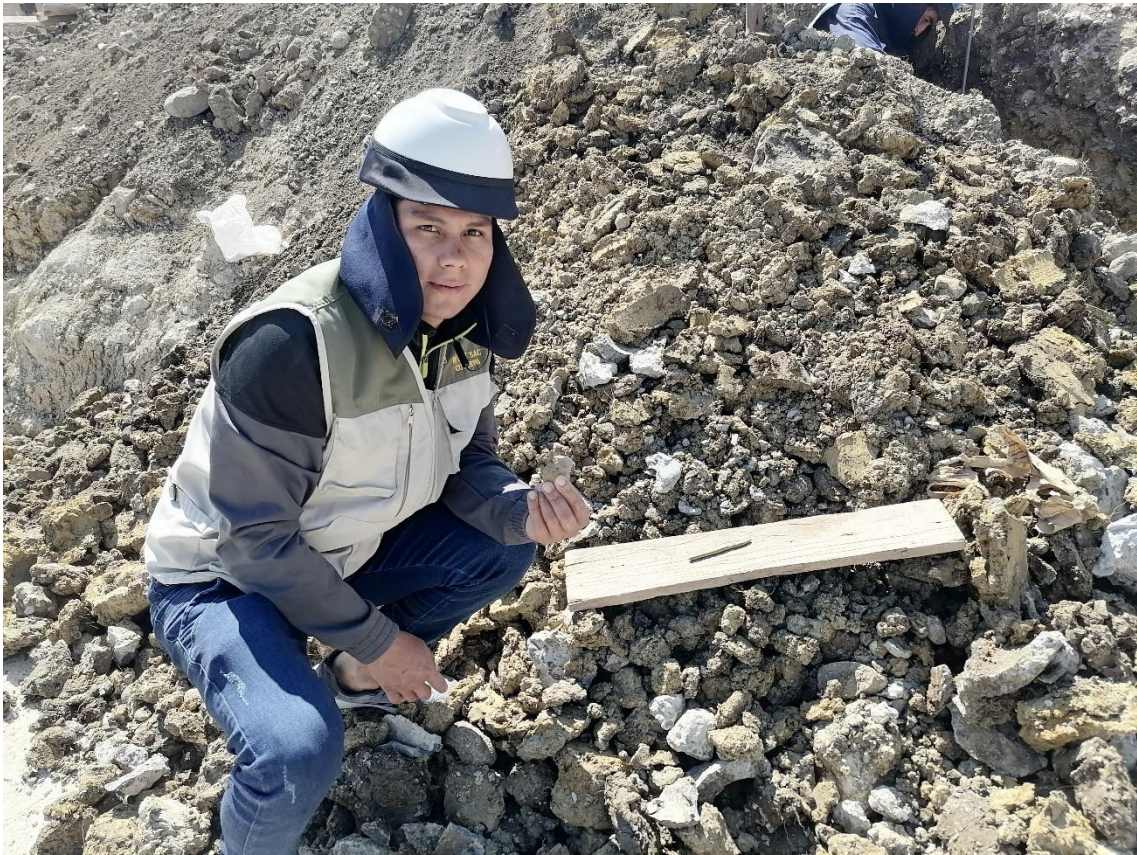
Fotografía 3 Verificación in situ del tipo de suelo: prueba de cinta de barro
