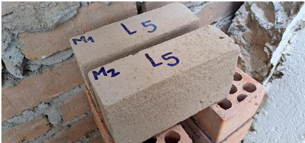
Figura 38 Prueba de Eflorescencia de Velo de Horno
