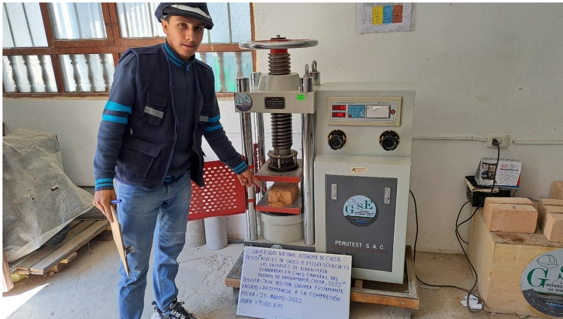
Fotografía 17. Ensayo de resistencia a compresión en ladrillos
