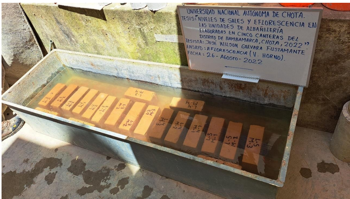
Fotografía 20. Ladrillos sometidos a contacto con el agua para ensayo de velo de horno
