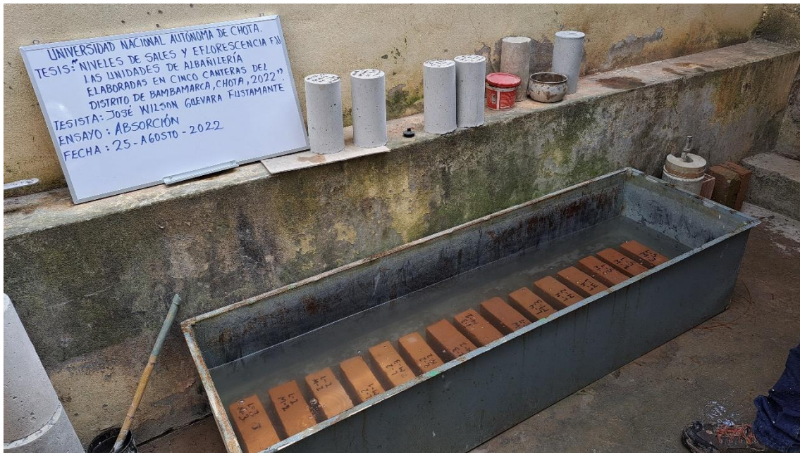
Fotografía 15. Ensayo de absorción en ladrillos
