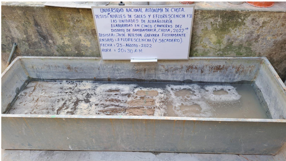
Fotografía 18. Ladrillos convertidos en lodo al tratar de realizar el ensayo de velo de secadero en contacto con el agua
