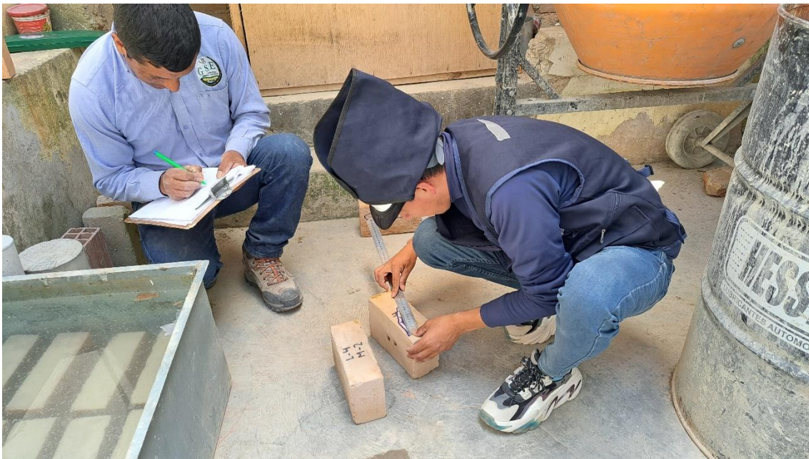
Fotografía 22. Ensayo de velo de horno en ladrillos
