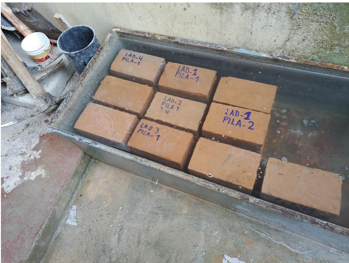
Fotografía 23. Pilas sometidas a contacto con agua para ensayo de velo de obra
