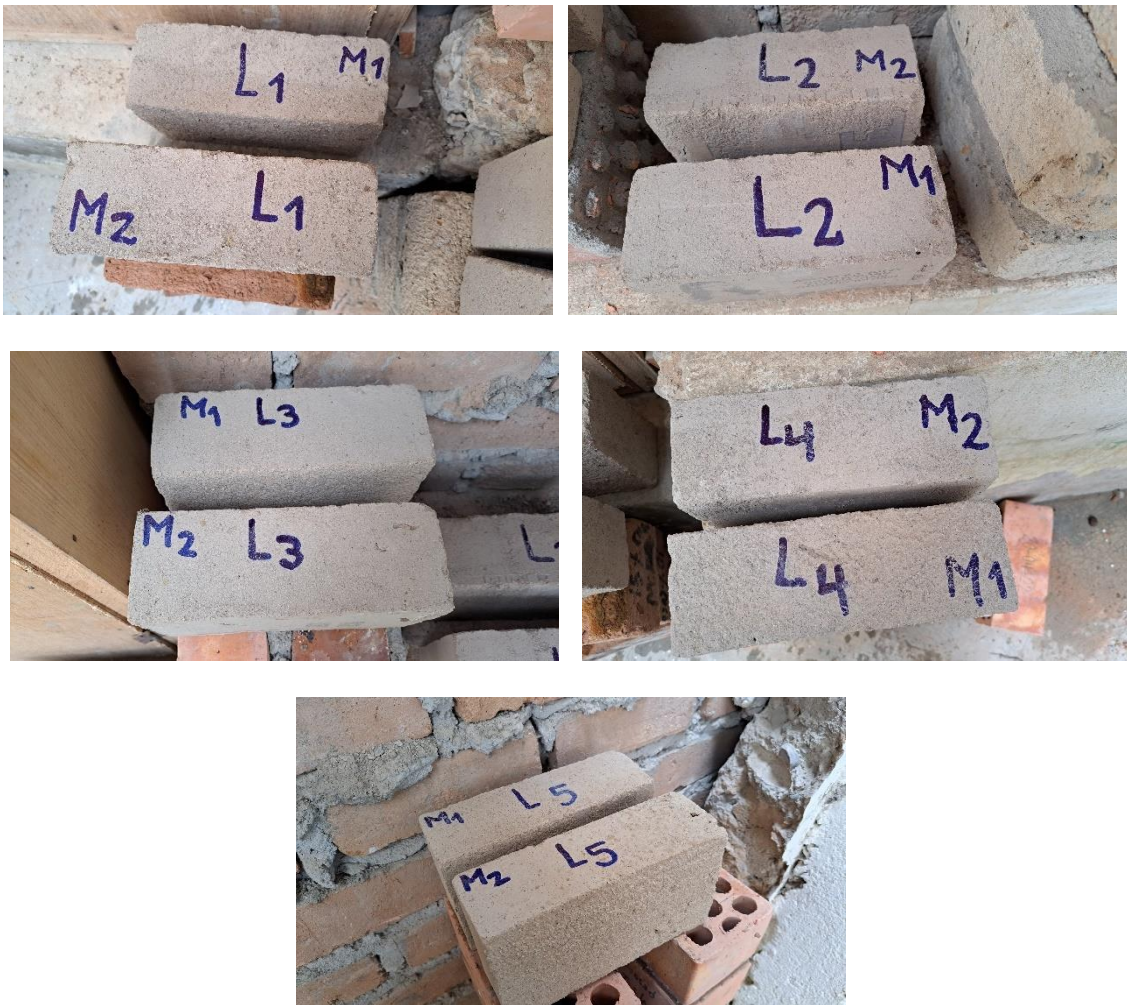
Fotografía 20. Ladrillos sometidos a contacto con el agua para ensayo de velo de horno
