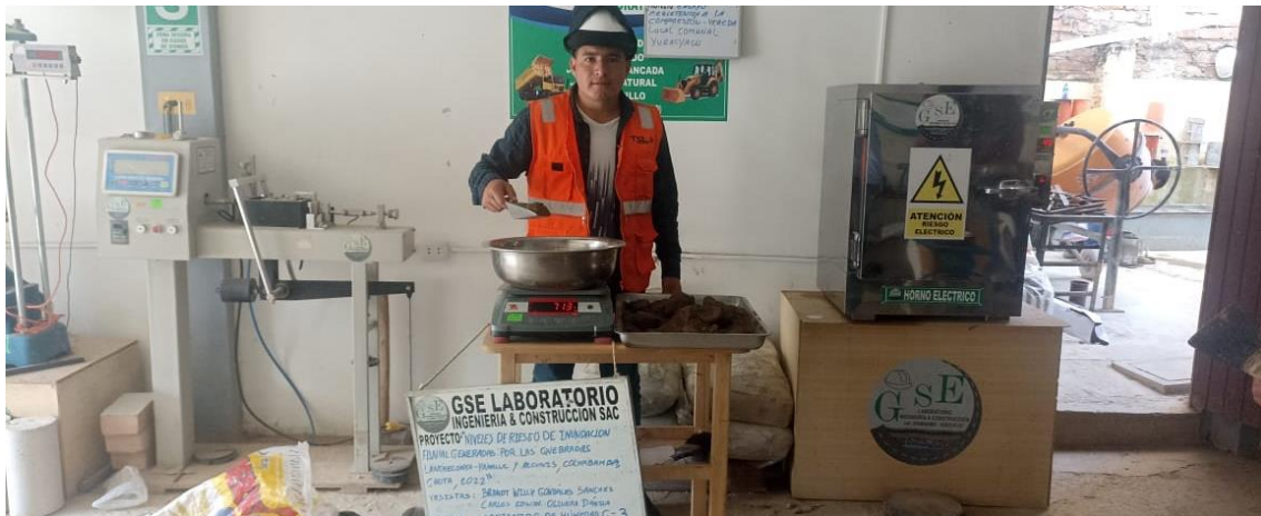
Fotografía 28. Ensayo de contenido de humedad, colocación de la muestra en el horno
