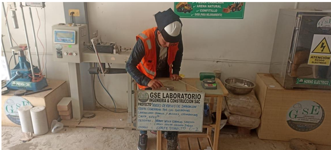
Fotografía 34. Ensayo de corte directo, aplicación de la carga
