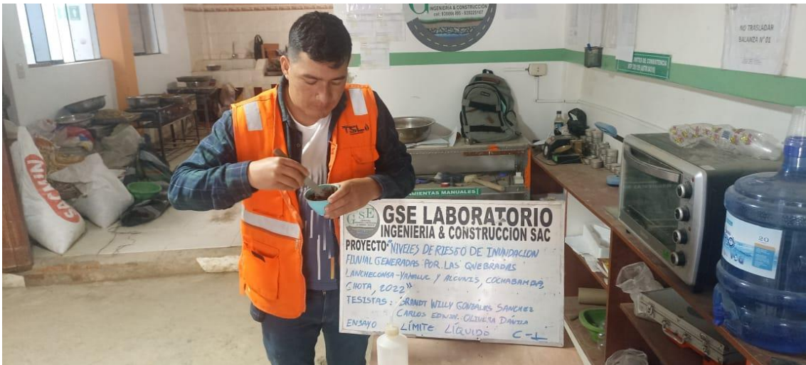
Fotografía 31. Ensayo de límite líquido, conteo de número de golpes en la copa Casagrande
