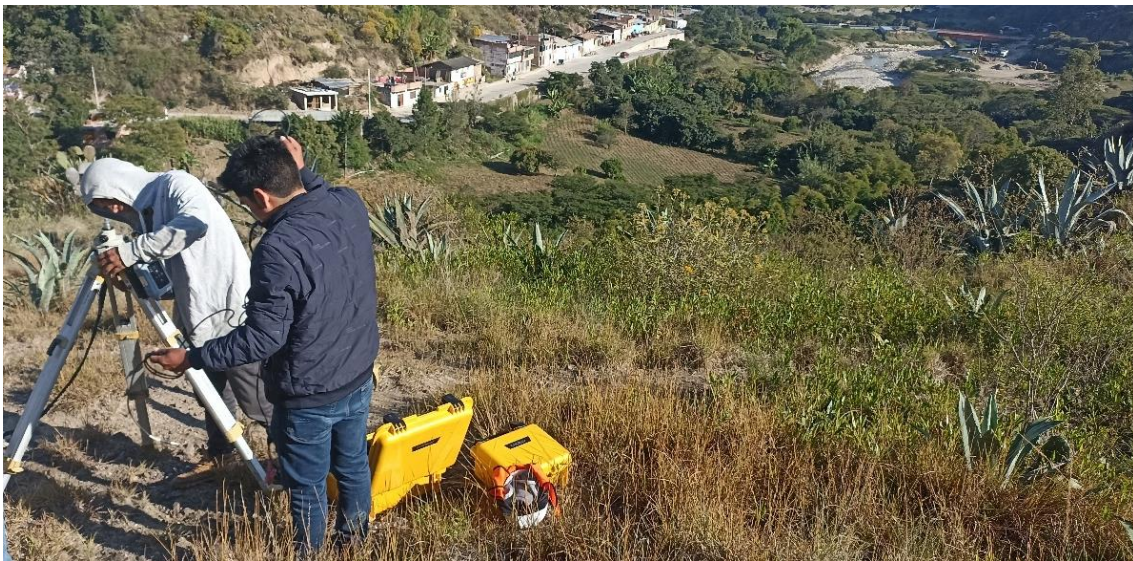
Fotografía 2. Posicionamiento del GPS diferencial para levantamiento topográfico de la quebrada Lancheconga-Yamaluc
