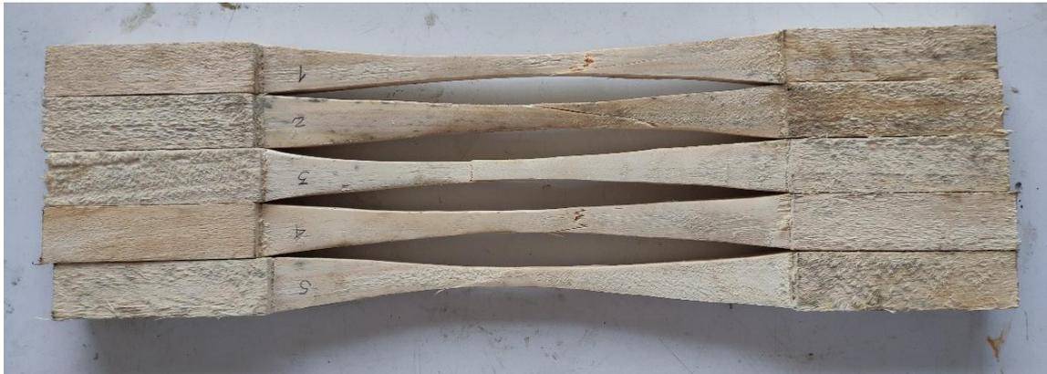
Fig. N°2. Muestras de madera *Pinus Radiata*, ensayo de tensión paralela a la fibra Vista frontal
