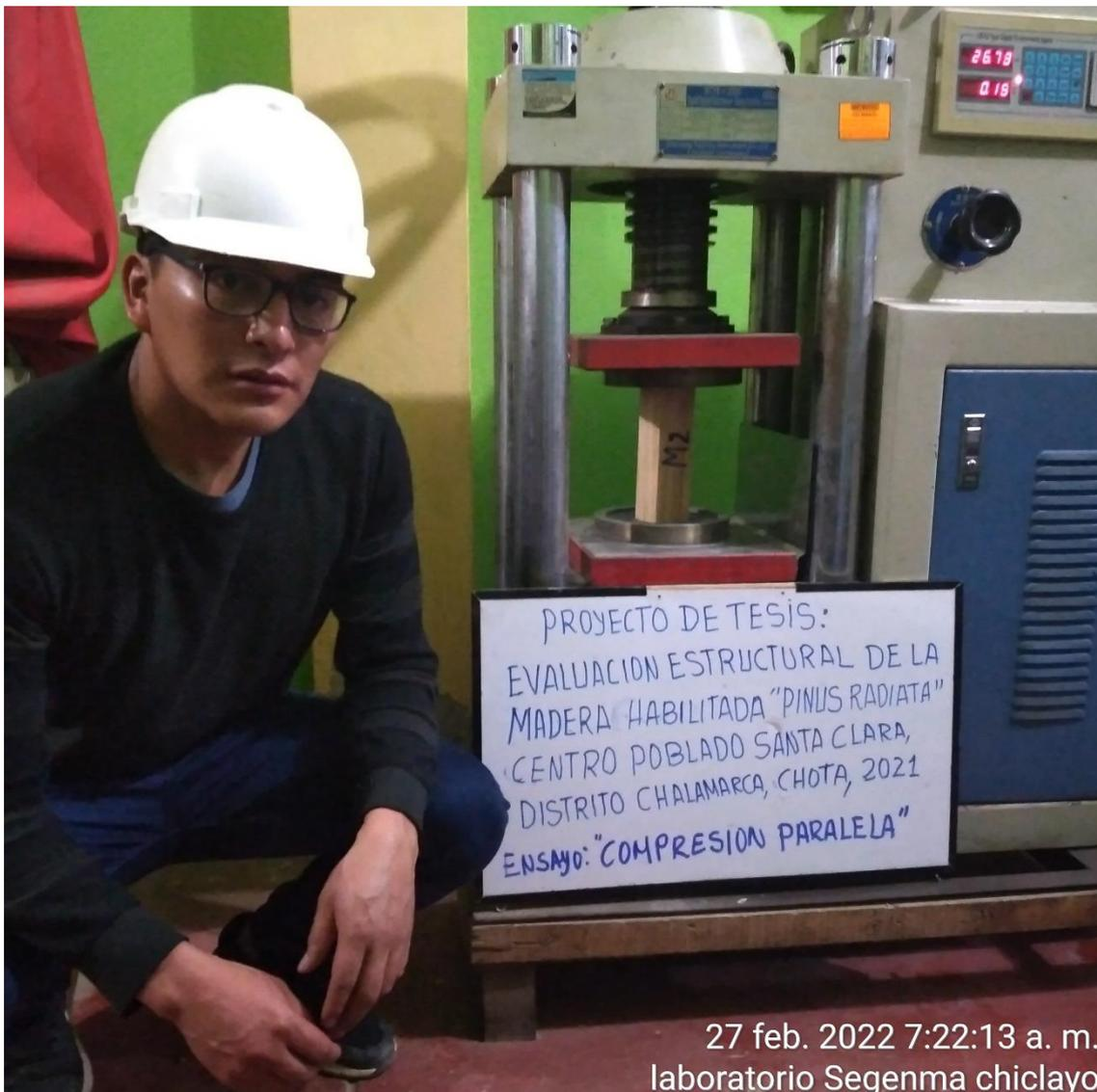
Al realizar un ensayo de compresión en esta orientación las fibras recibirán la carga a través de su eje longitudinal. La ruptura frecuentemente ocurre debido al colapso de las fibras. Se realizó en el laboratorio SEGEMA de la ciudad de Chiclayo.
