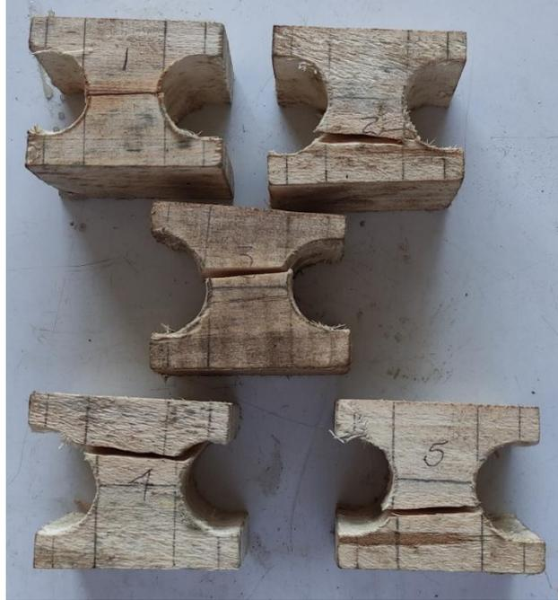
Fig. N°6. Muestras de madera *Pinus Radiata*, ensayo de tensión perpendicular a la fibra
