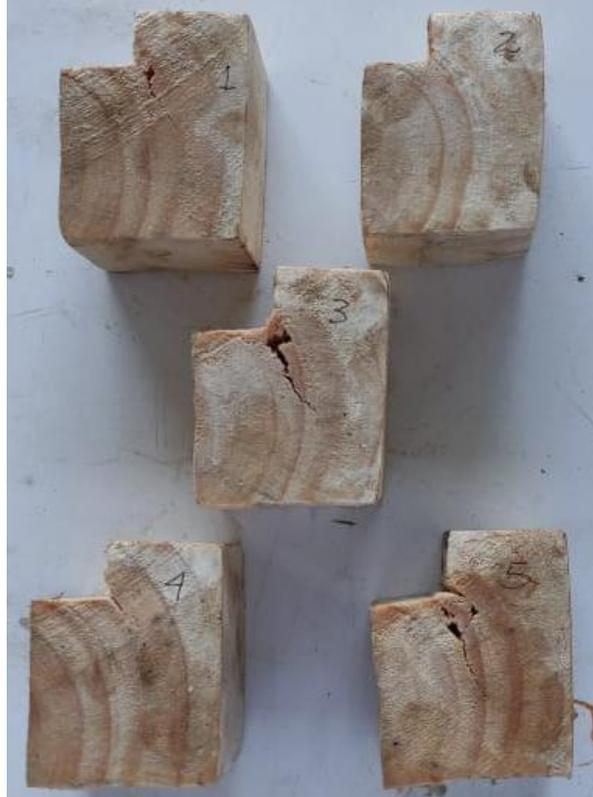
Fig. N°7. Muestras de madera *Pinus Radiata*, ensayo de cizallamiento paralelo al grano.
