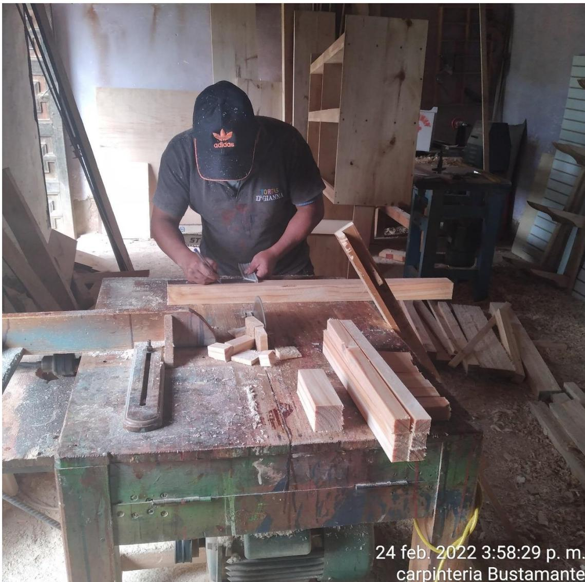
Las viguetas se trasladaron a una carpintería local, donde se prosiguió con el siguiente paso que, es la conversión de la madera en las probetas de ensayo, las probetas fueron elaboradas según las dimensiones dadas en la normatividad.
