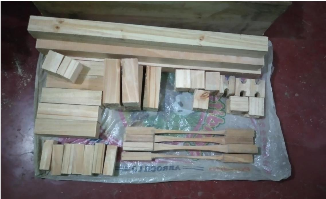
Fotografía 8. Ensayo de contenido de humedad en la madera de pino
