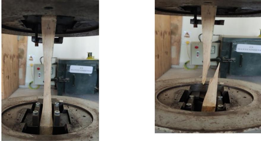
Fig. N°4. Muestras de madera *Pinus Radiata*, ensayo de tensión paralela a la fibra; antes y después de ensayo.
