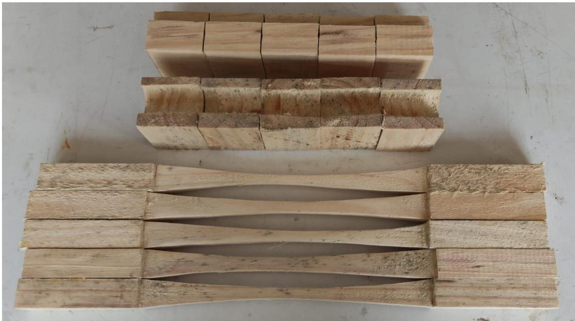
Fig. N°1. Muestras de madera *Pinus Radiata*, puestas en laboratorio.
