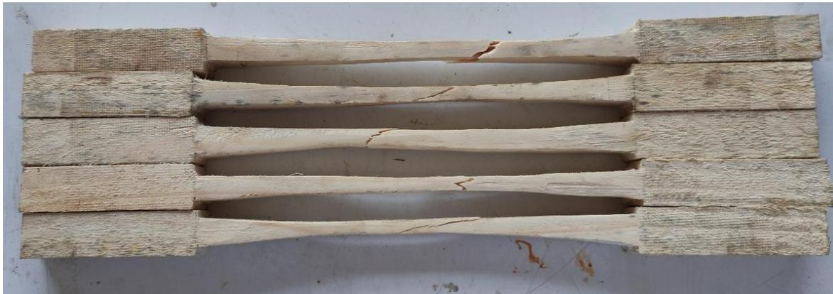
Fig. N°3. Muestras de madera *Pinus Radiata*, ensayo de tensión paralela a la fibra Vista lateral.
