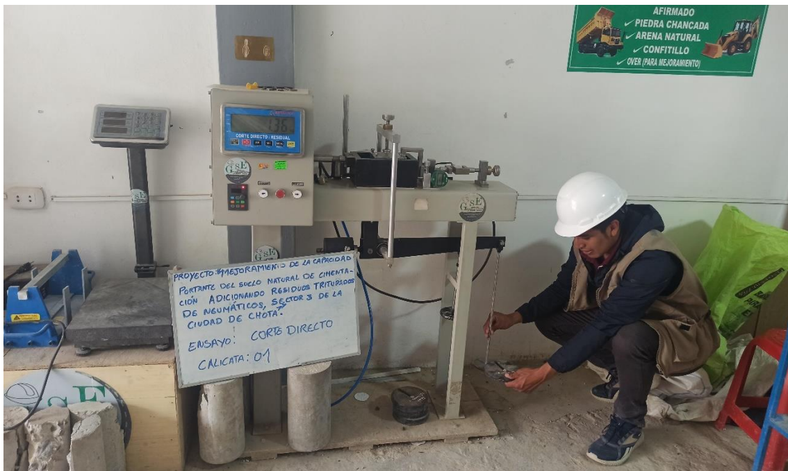
Figura 60 Ensayo del corte directo de la calicata 1
