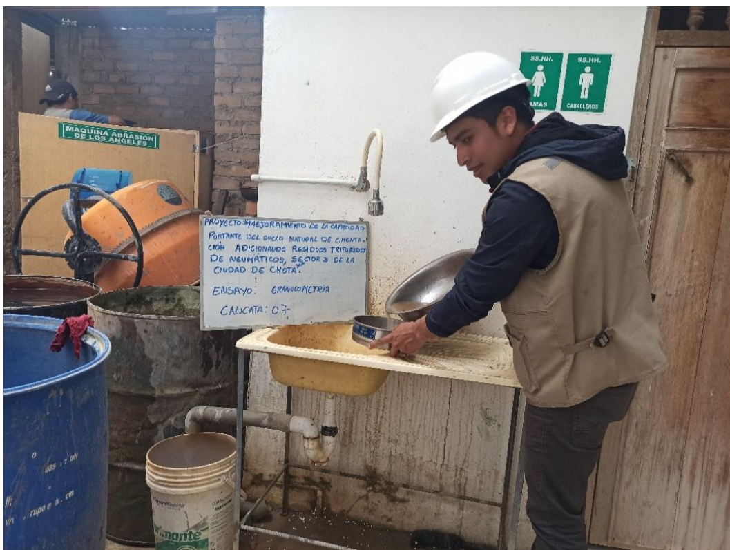
Figura 71 Ensayo de granulometría de la calicata 7
