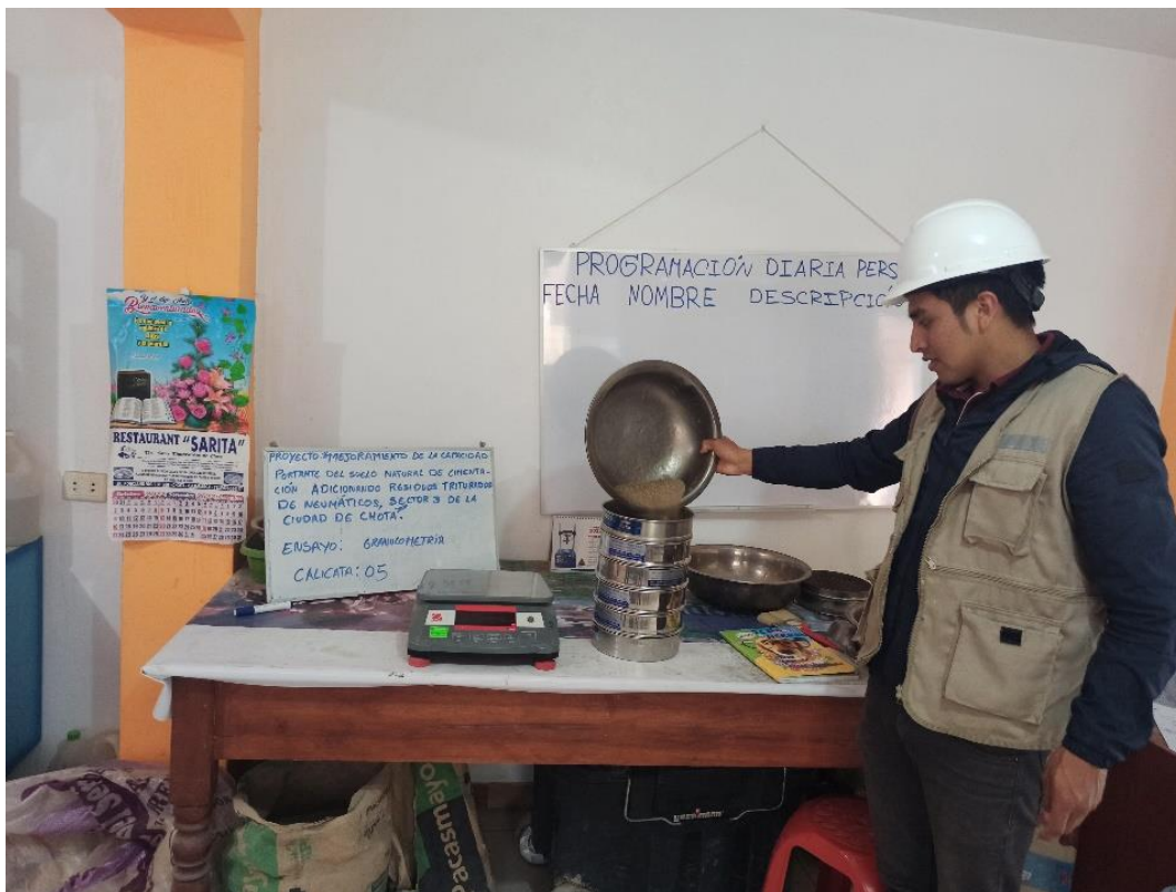
Figura 67 Ensayo de granulometría de la calicata 5
