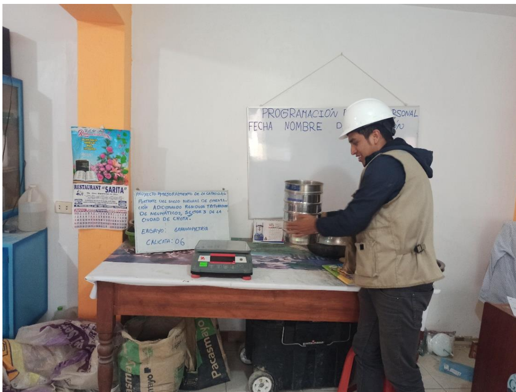
Figura 69 Ensayo de granulometría de la calicata 6
