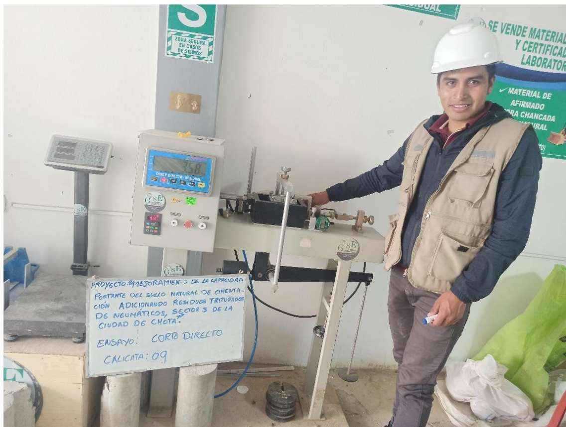
Figura 78 Ensayo del corte directo de la calicata 9
