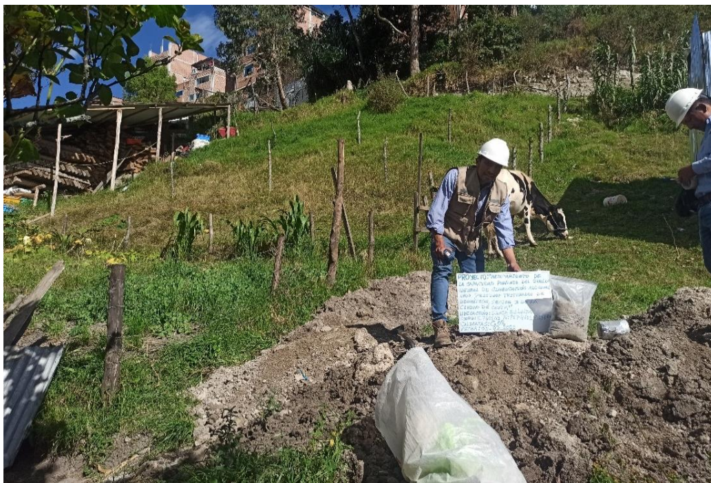
Figura 47 Extracción de muestras en la calicata 3
