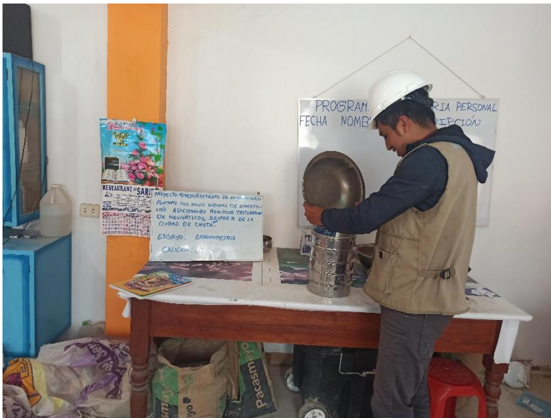
Figura 59 Ensayo de límites de consistencia de la calicata 1
