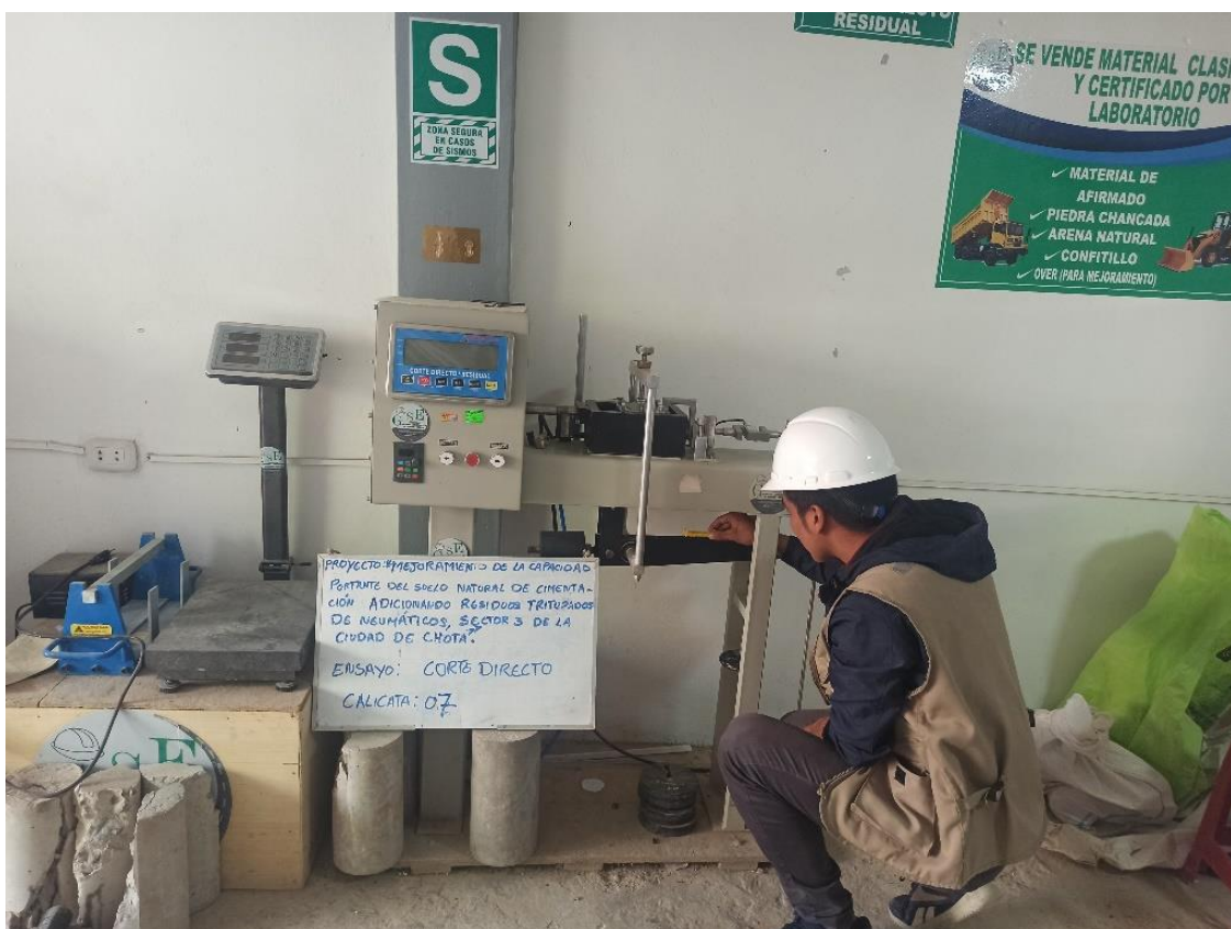
Figura 73 Ensayo del corte directo de la calicata 7
