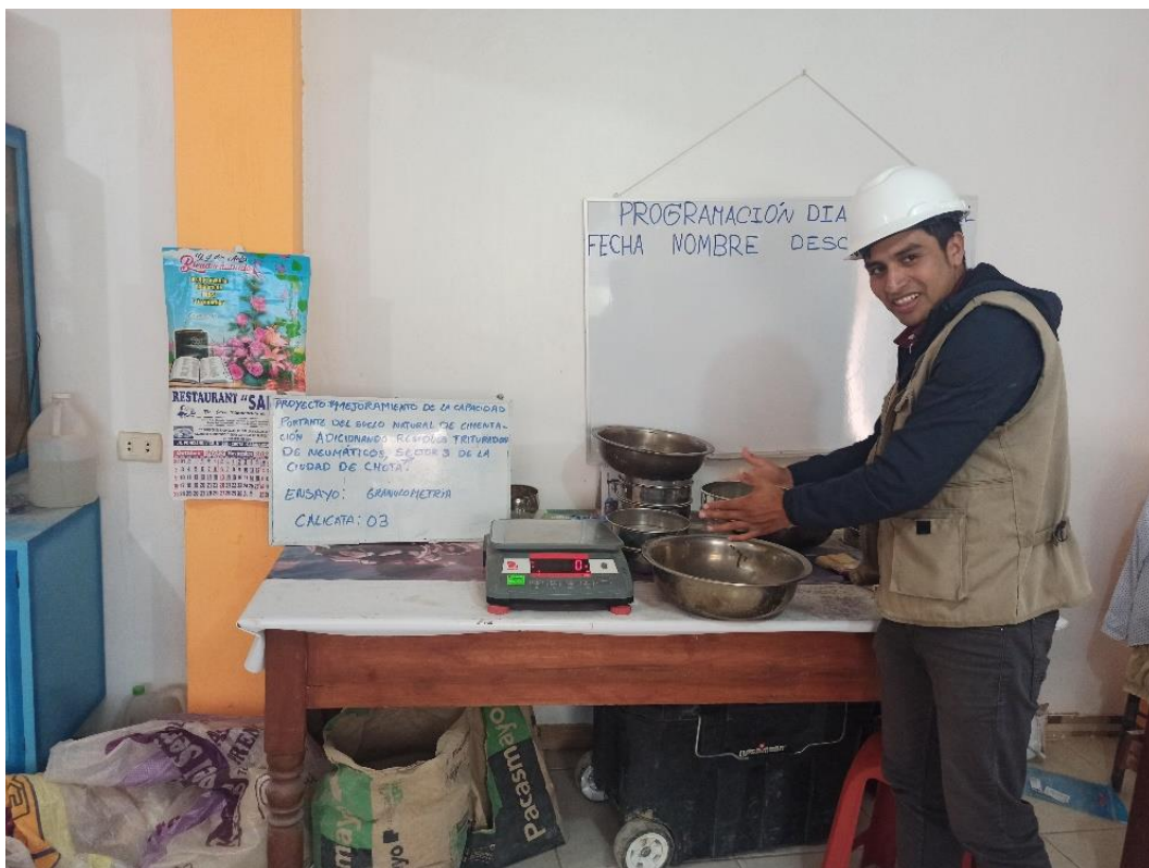
Figura 63 Ensayo de granulometría de la calicata 3
