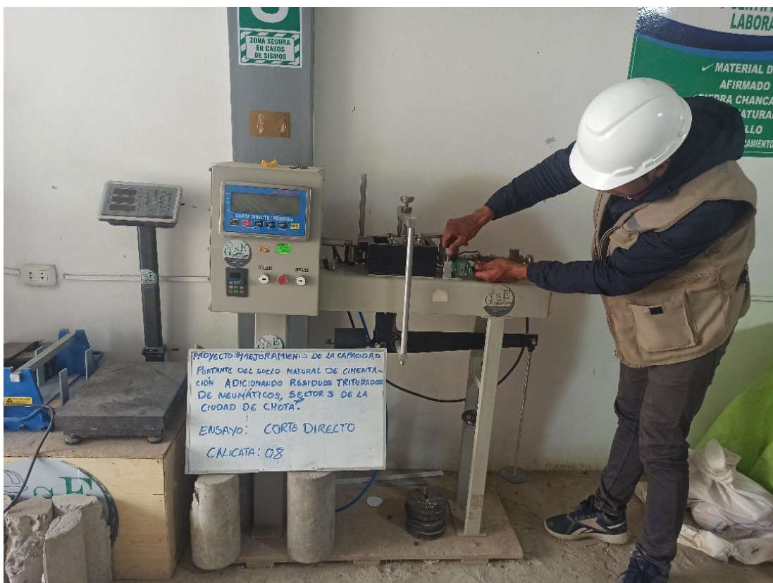
Figura 75 Ensayo del corte directo de la calicata 8
