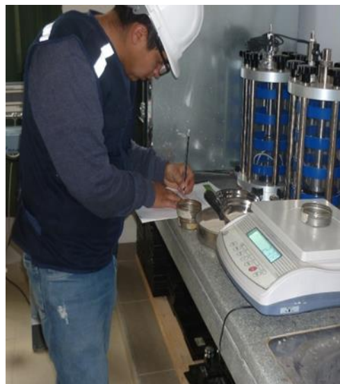
Registro de pesos, para determinar LP
