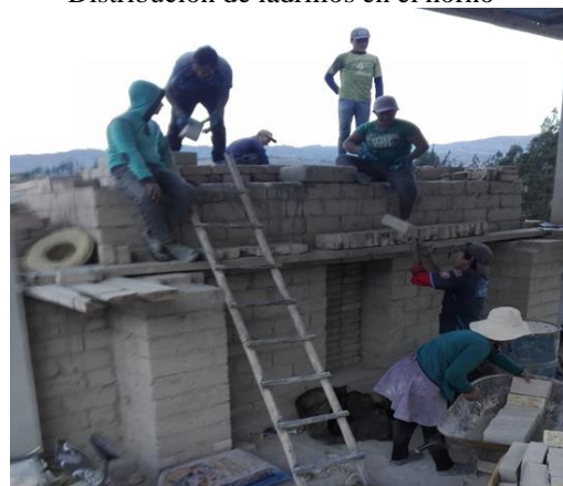
Distribución de ladrillos en el horno
