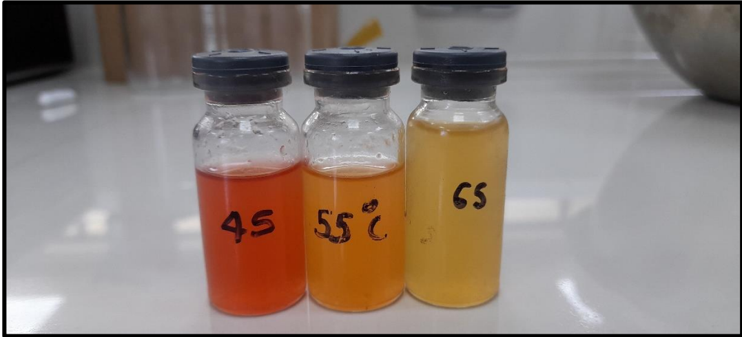
Imagen 5. Cambio de compuestos después de almacenar a temperaturas altas y tiempos prolongados para predecir la vida útil.
