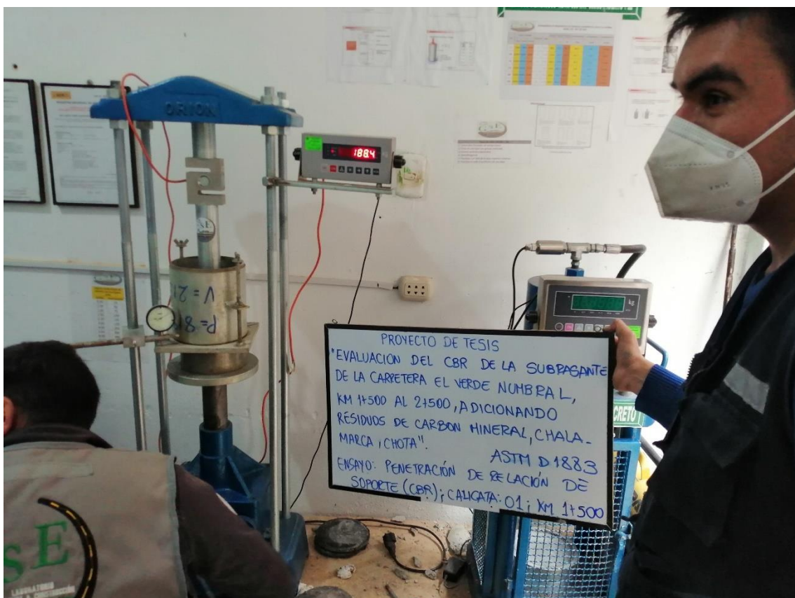
Fotografía 17. Ensayo de CBR, calicata 1
