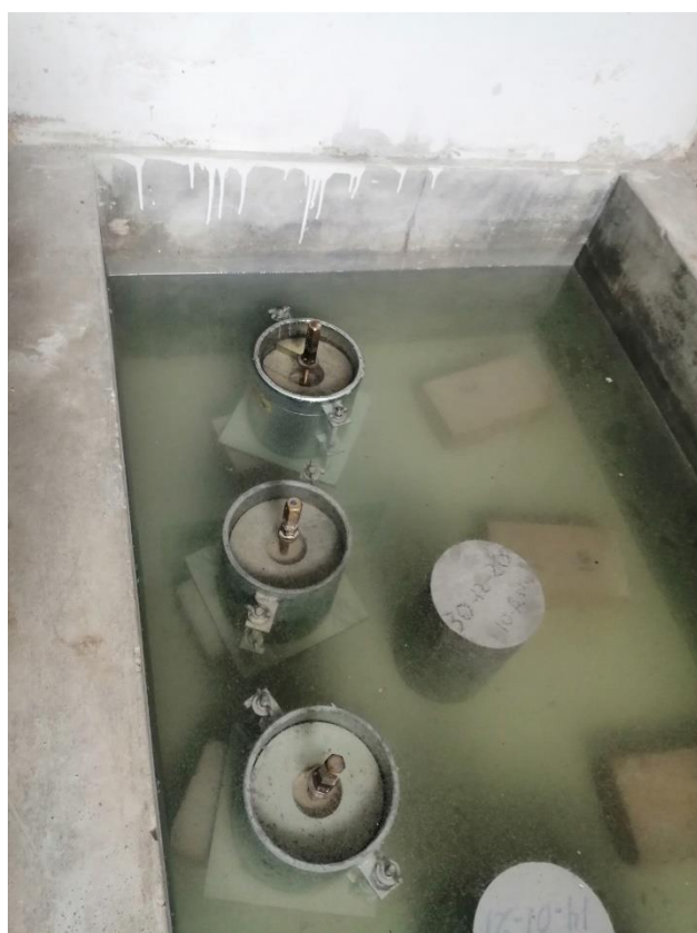
Fotografía 23. Ensayo de expansión suelo con residuos de carbón mineral
