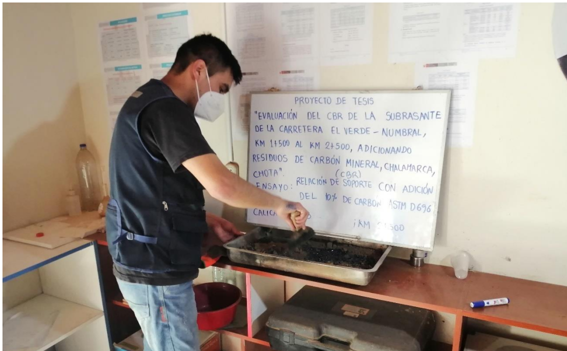
Fotografía 26. Ensayo de CBR suelo con residuos de carbón mineral, calicata 3
