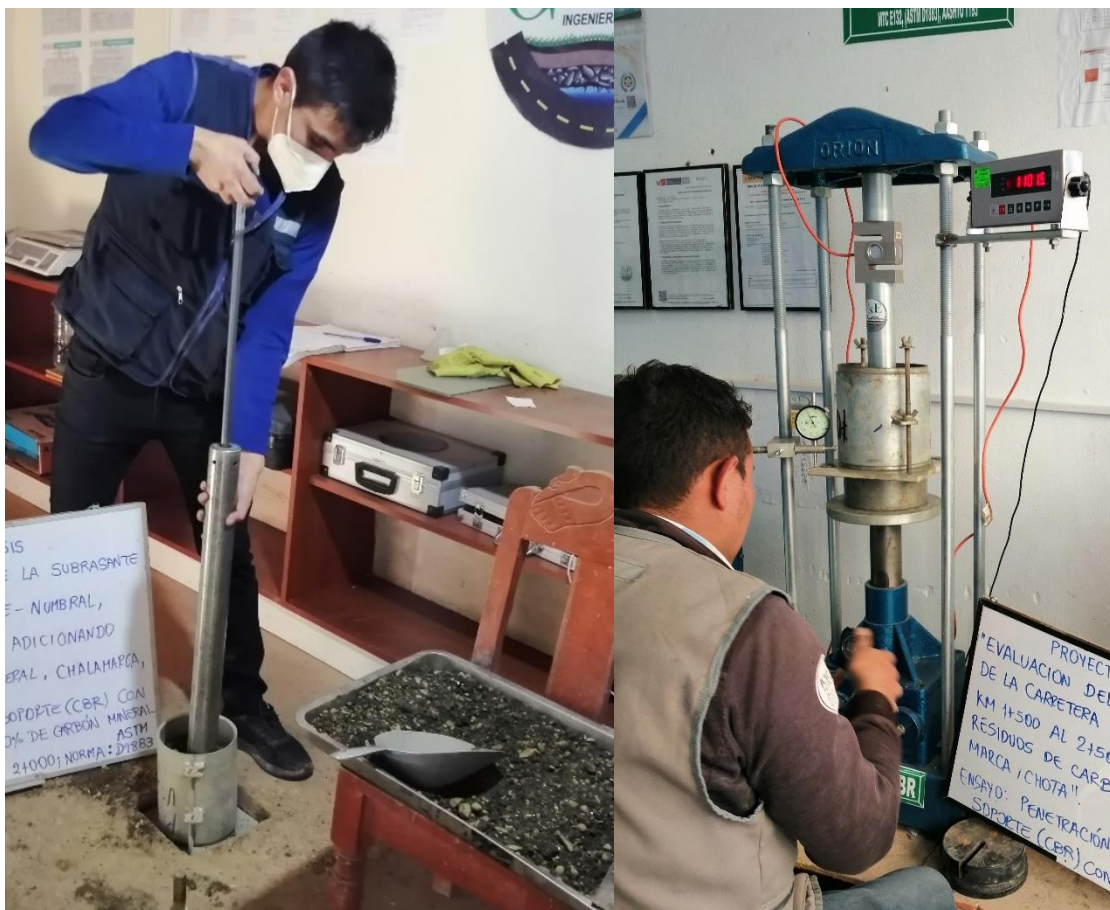
Fotografía 25. Ensayo de CBR suelo con residuos de carbón mineral, calicata 2
