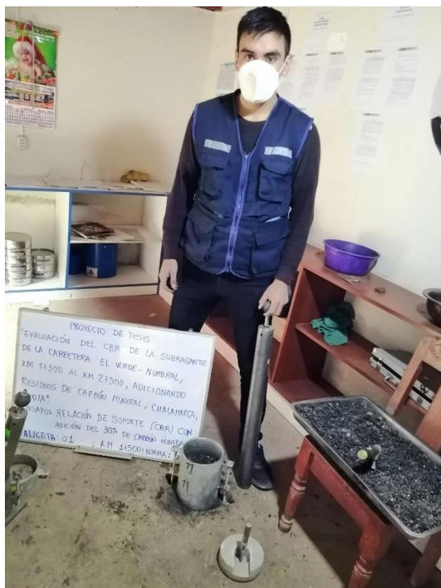
Fotografía 23. Ensayo de expansión suelo con residuos de carbón mineral
