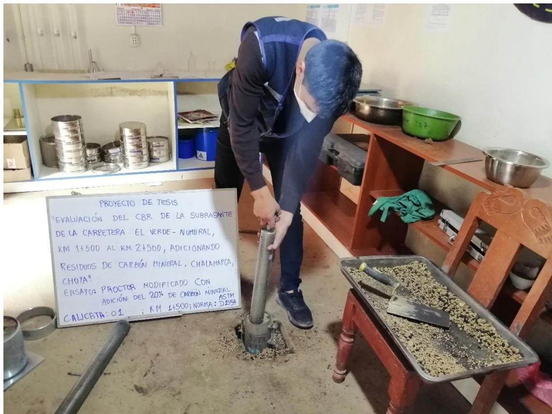
Fotografía 21. Ensayo de Proctor modificado suelo con residuos de carbón mineral
