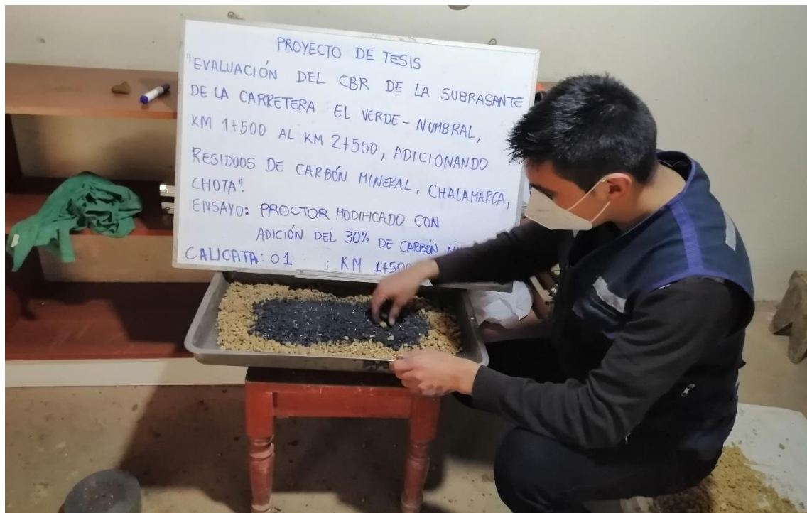
Fotografía 21. Ensayo de Proctor modificado suelo con residuos de carbón mineral
