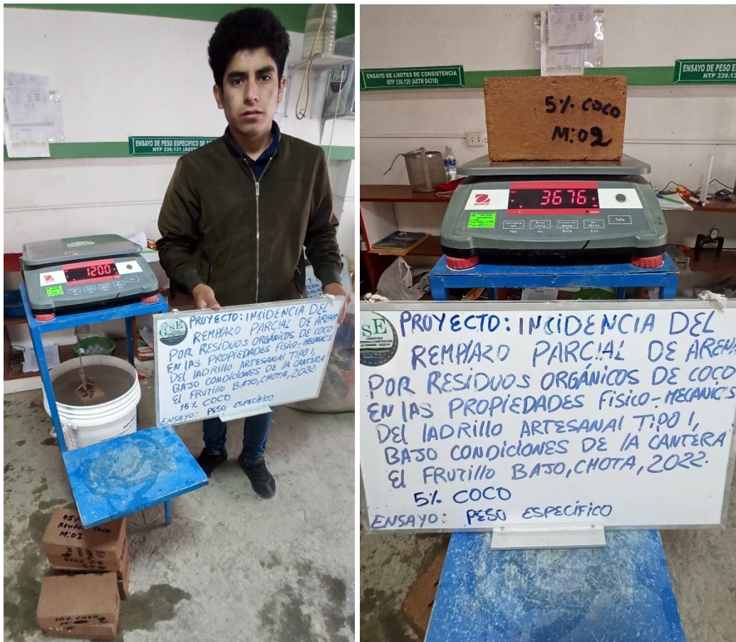
Fotografía 21. Ensayo de peso específico en ladrillos
