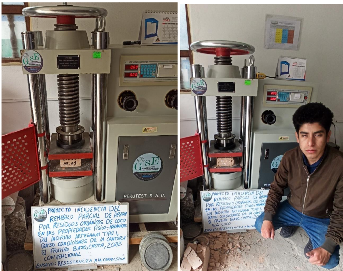
Fotografía 24. Ensayo de resistencia a compresión en ladrillos
