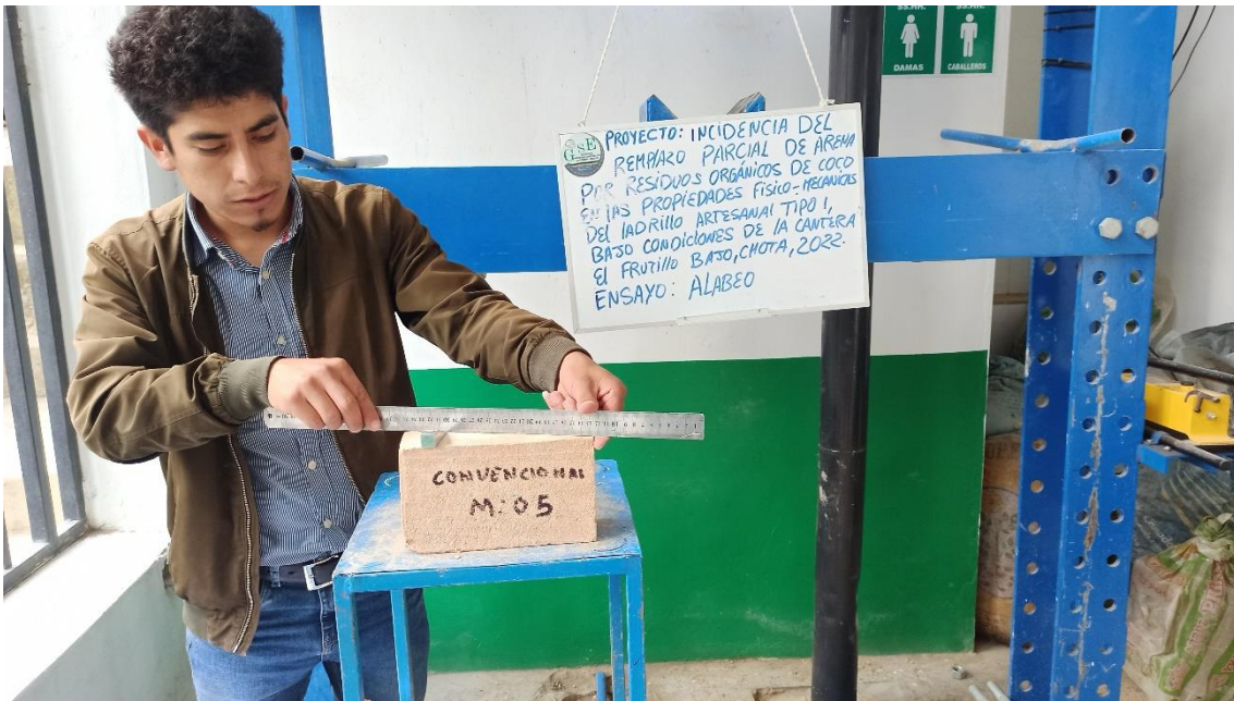
Fotografía 19. Ensayo de alabeo en ladrillos
