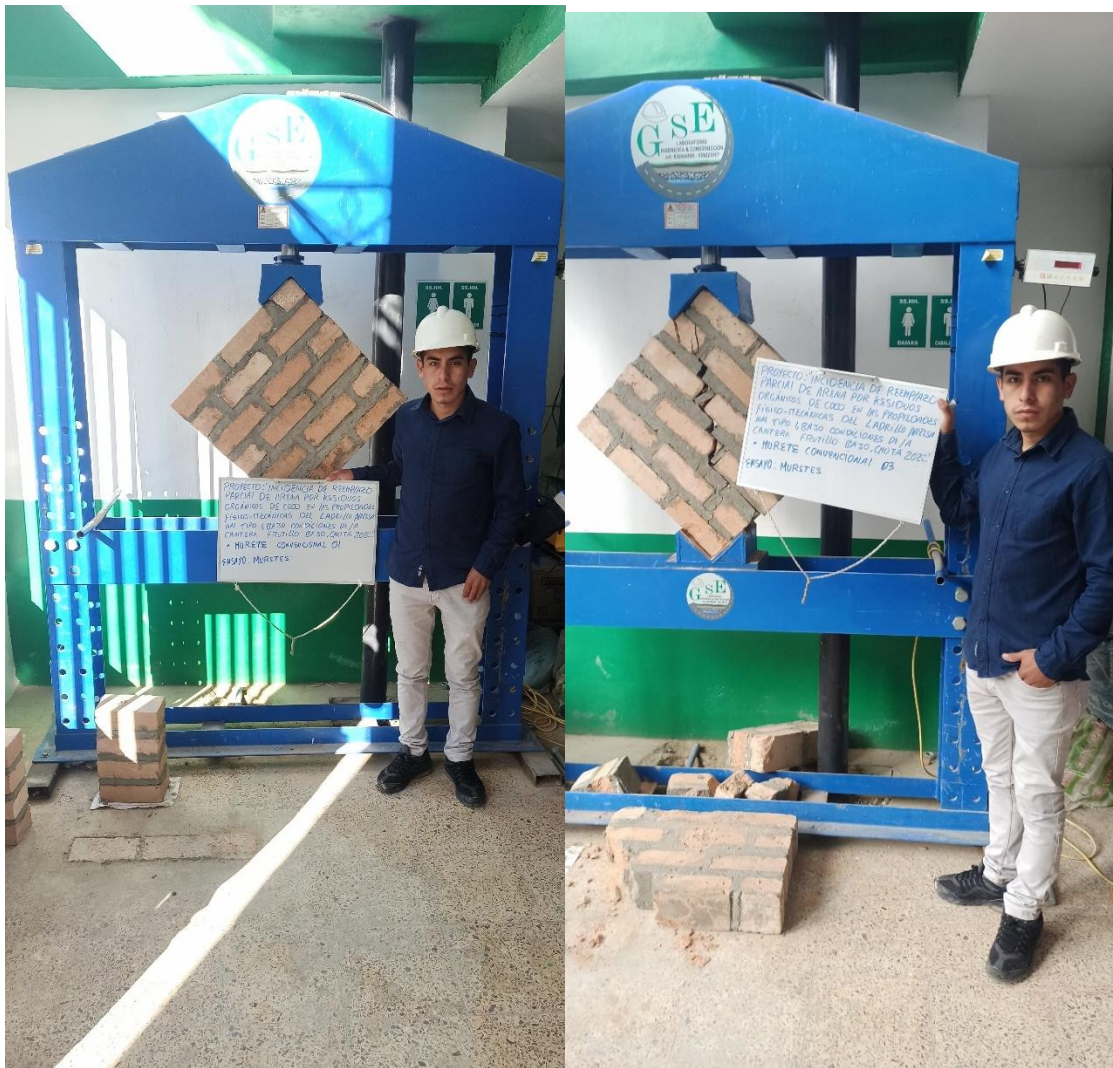
Fotografía 27. Ensayo de resistencia en muretes
