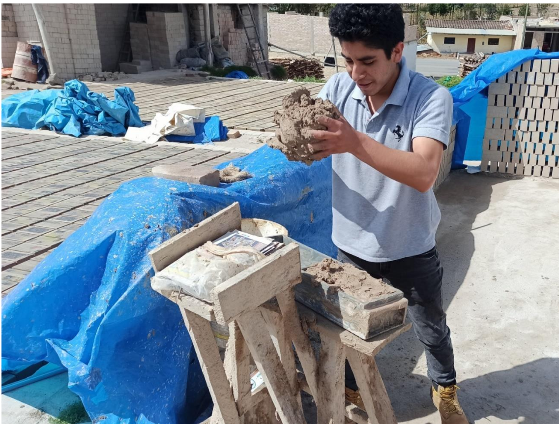
Fotografía 16. Moldeado de ladrillos
