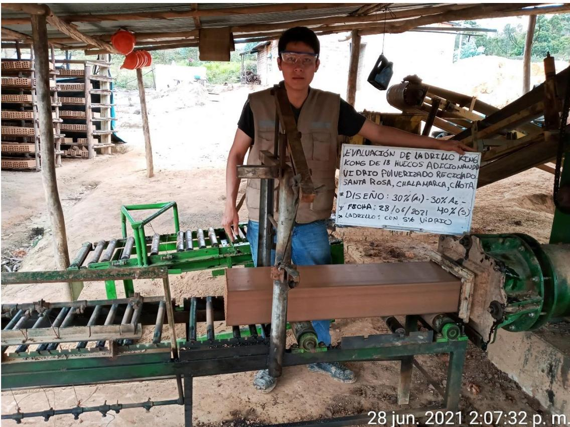
Figura 99. Ladrillos con 10% de vidrio pulverizado
