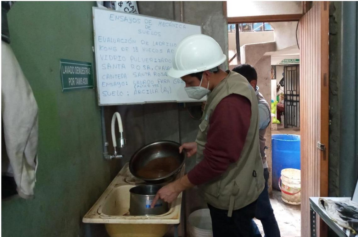
Figura 92. Análisis granulométrico
