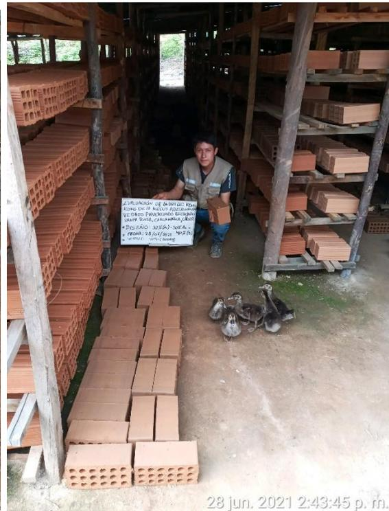
Figura 100. Ladrillos con 15% de vidrio pulverizado
