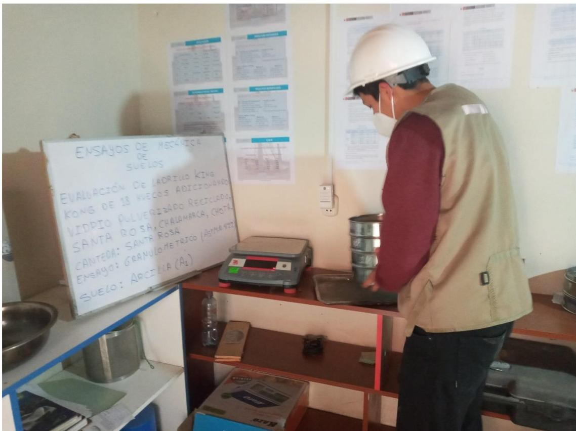
Figura 93. Muestras para ensayo de límite líquido
