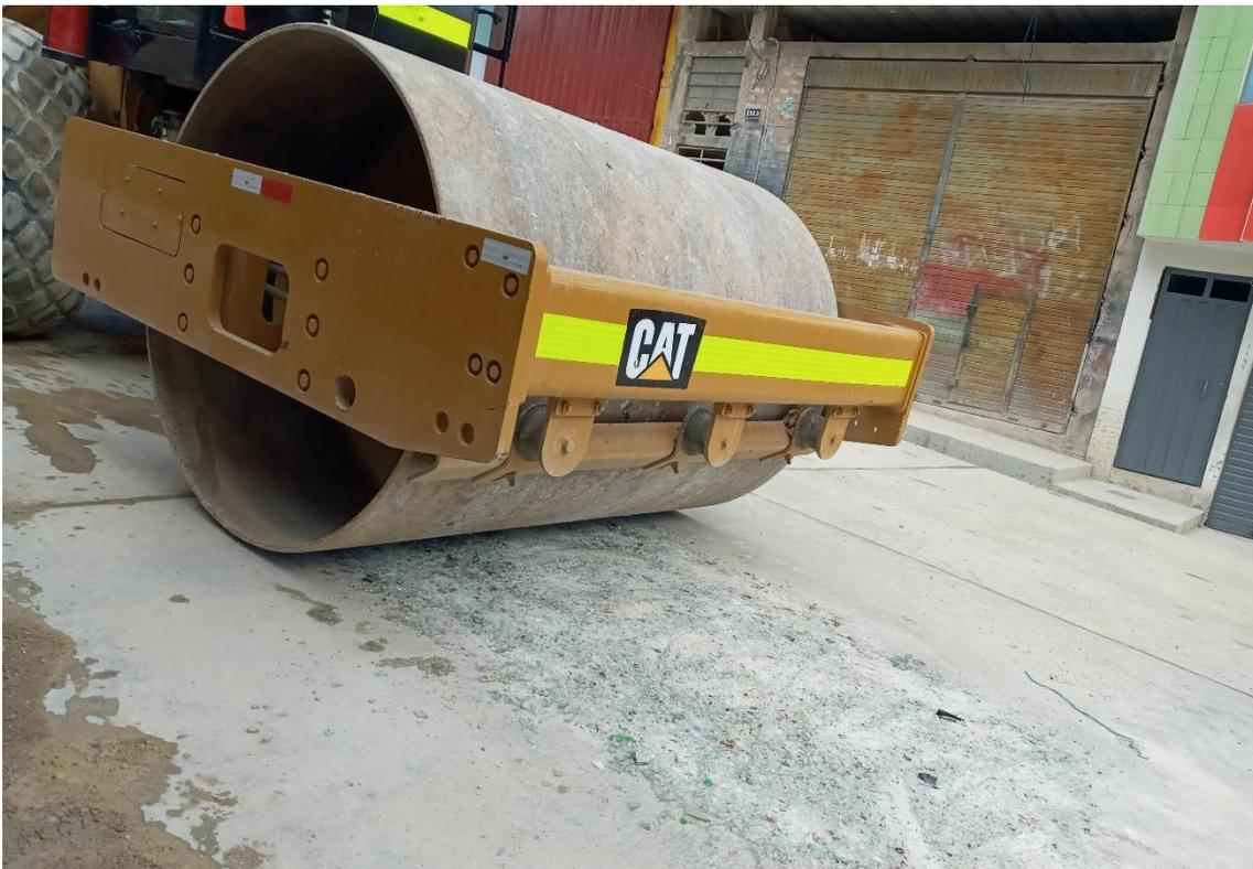
Figura 85. Recojo del vidrio después de trituración
