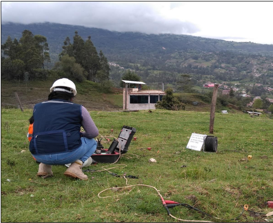
Fotografía 12. Disparo realizado para registro de ondas - Refracción Sísmica
