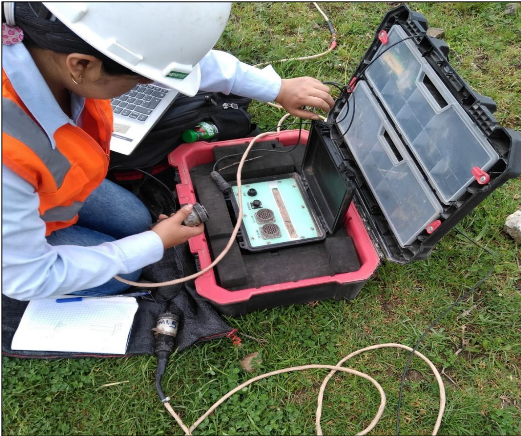
Fotografía 8. Instalación de la fuente sísmica, para realizar el disparo
