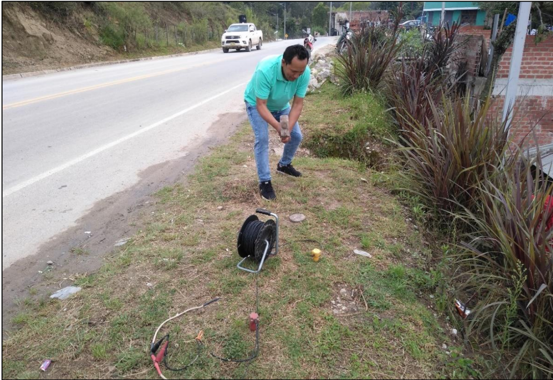
Fotografía 16. Disparo realizado para registro de ondas sondeo MASW-02
