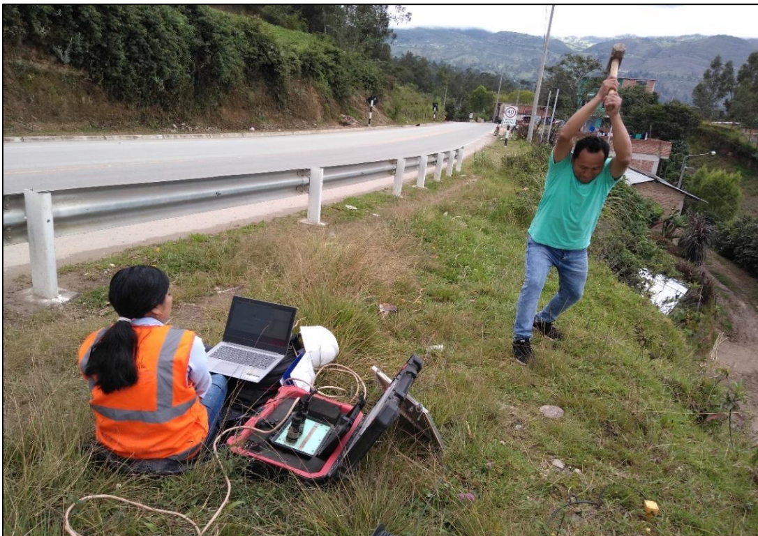
Fotografía 16. Disparo realizado para registro de ondas sondeo MASW-02
