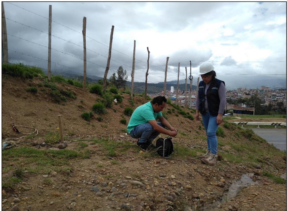
Fotografía 18. Conexión de receptor de tiempo cero a cable trigger
