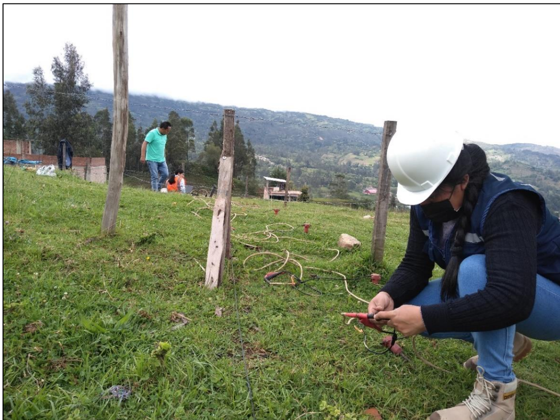
Fotografía 6. Colocación de pinzas de los geófonos al cable principal del arreglo
