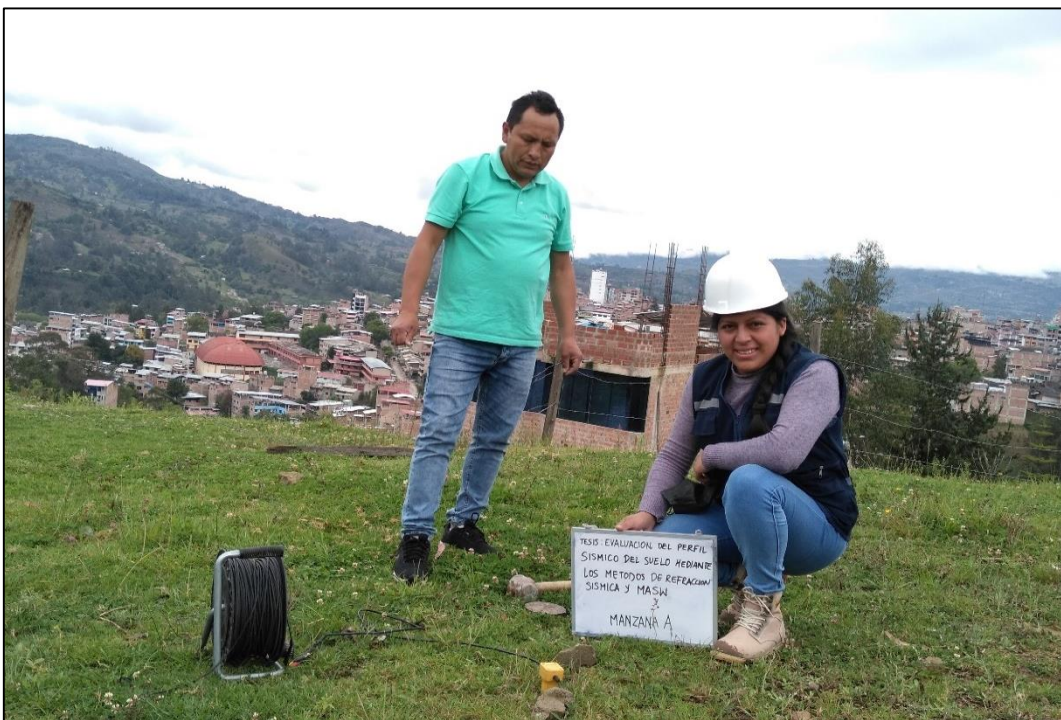
Fotografía 8. Instalación de la fuente sísmica, para realizar el disparo
