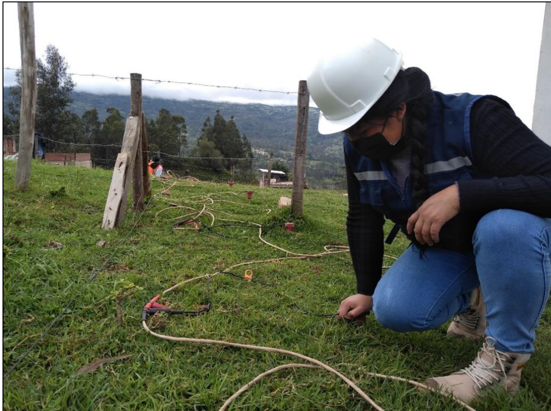
Fotografía 6. Colocación de pinzas de los geófonos al cable principal del arreglo
