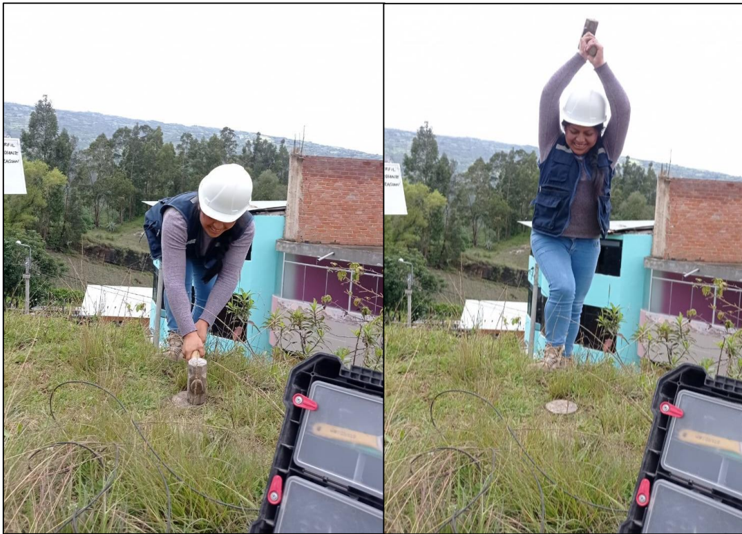
Fotografía 10. Disparo realizado para registro de ondas sondeo LRS-01B
