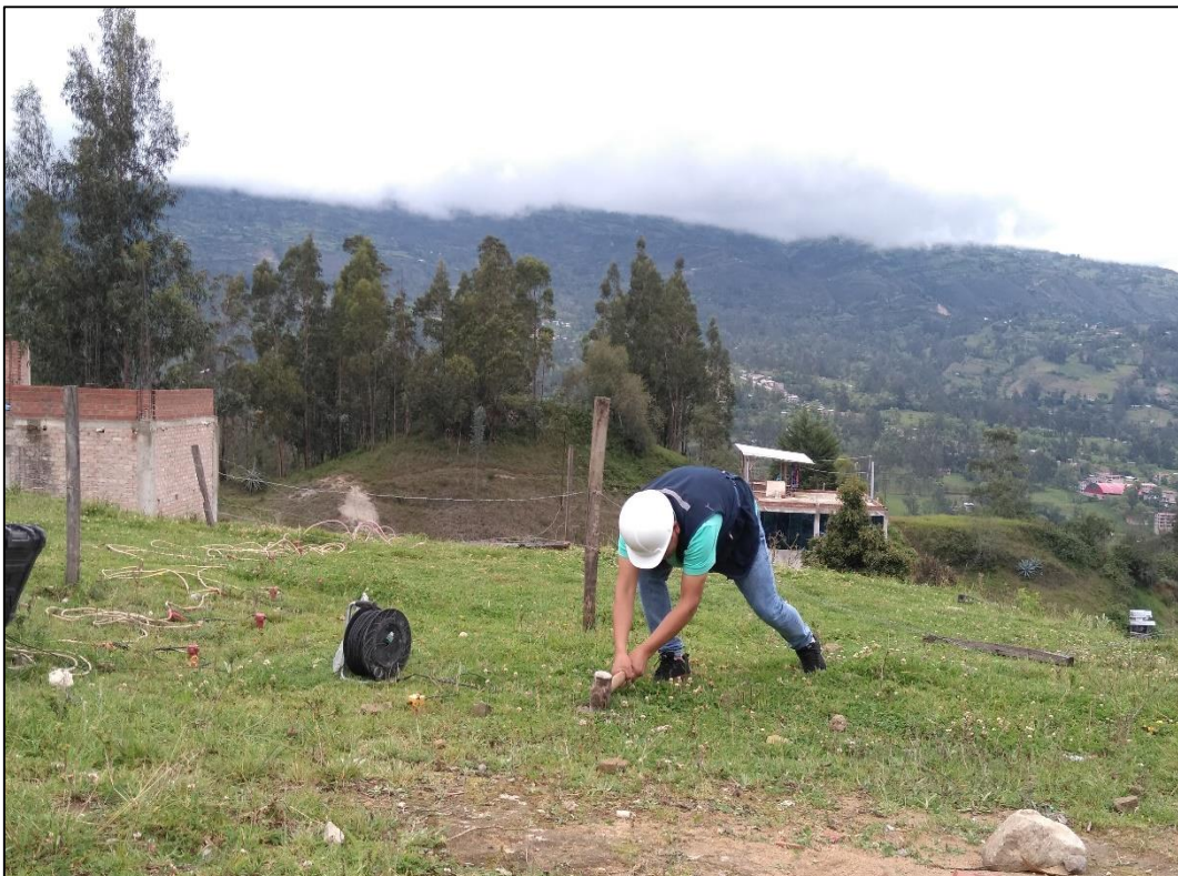
Fotografía 12. Disparo realizado para registro de ondas - Refracción Sísmica
