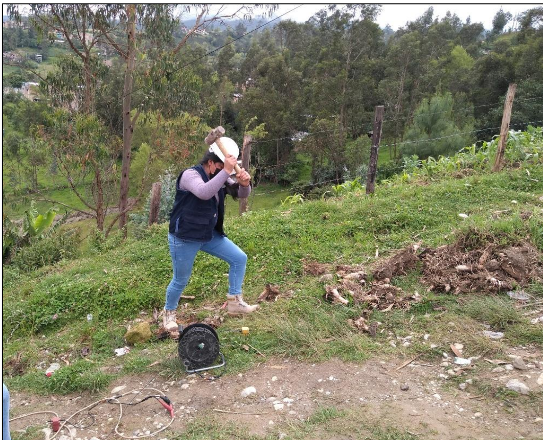
Fotografía 10. Disparo realizado para registro de ondas sondeo LRS-01B
