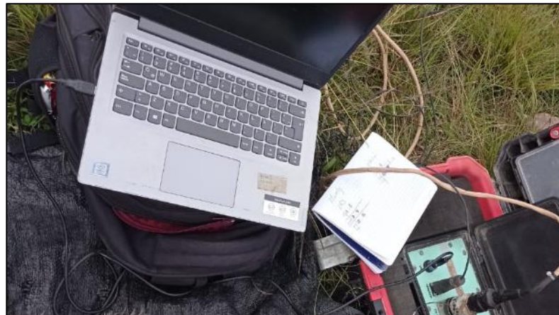
Figura 35. Conexión de sismógrafo y laptop
