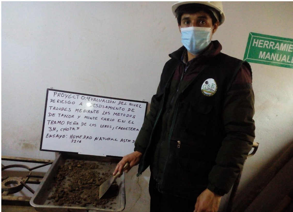
Fotografía 7. Ensayo de contenido de humedad del suelo
