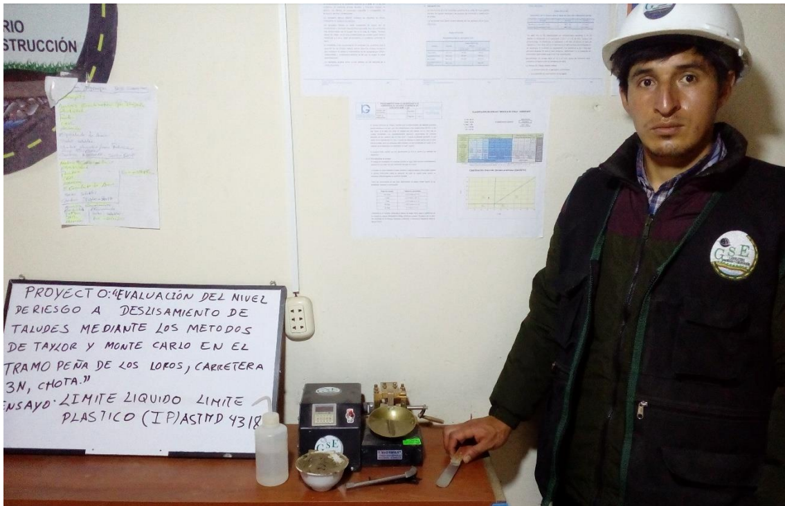
Fotografía 9. Ensayo de límites de consistencia
