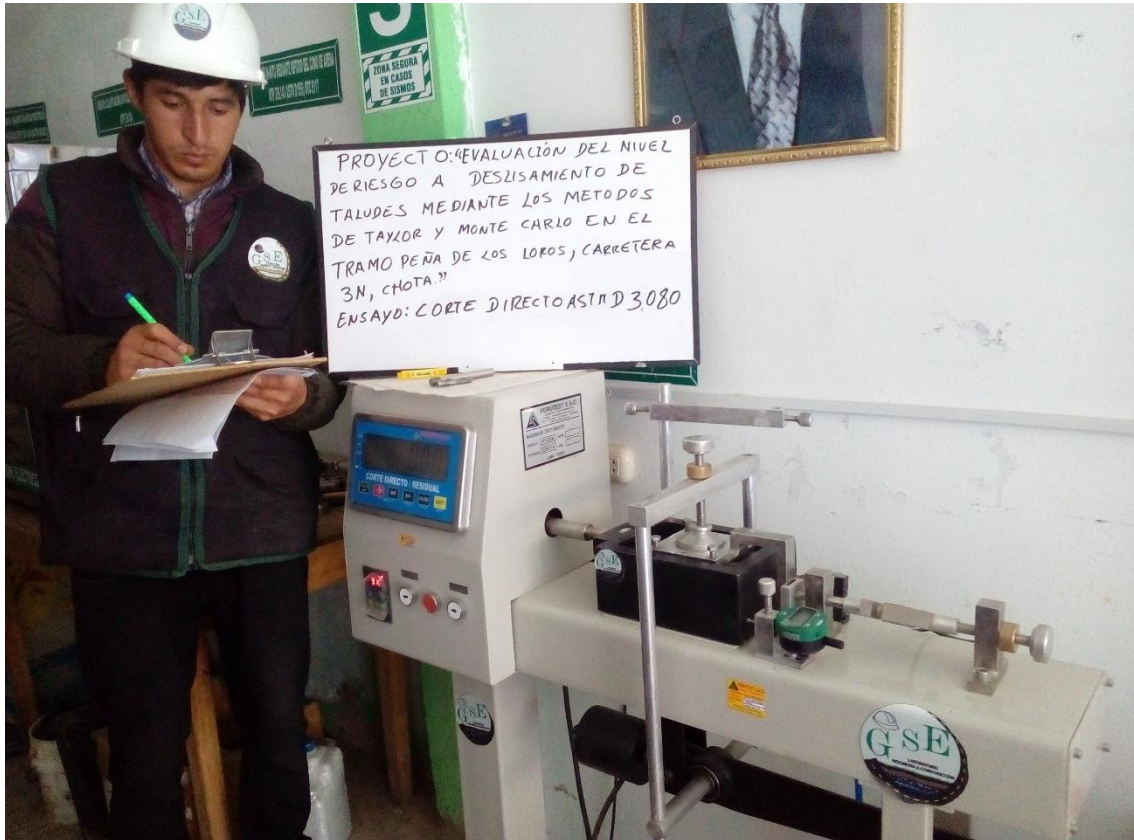
Fotografía 10. Ensayo de corte directo
