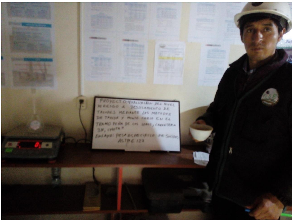
Fotografía 11. Ensayo de peso específico del suelo
