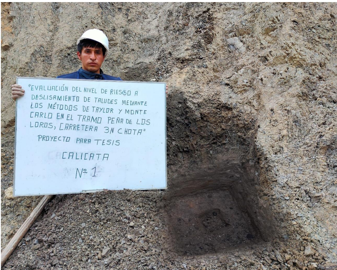
Fotografía 4. Calicata 1 en el talud Peña de los Loros
