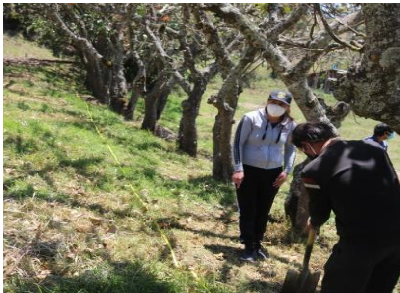
Figura 27 Obtención de la muestra de suelo de los 25 cm de profundidad.
