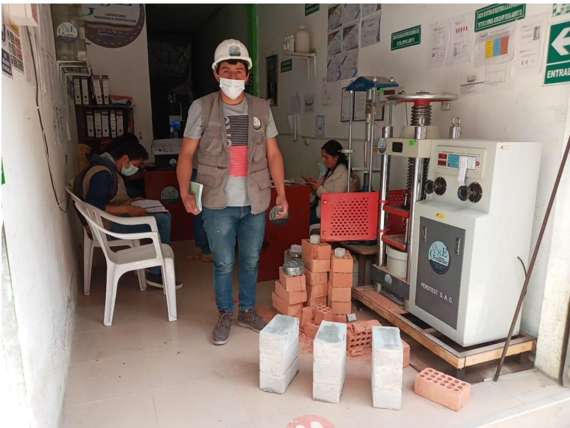
Fotografía 29. Ensayo de compresión axial en pilas
