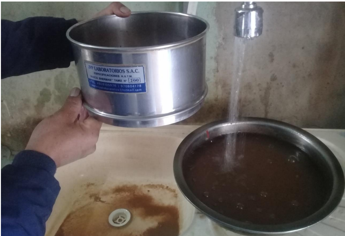
Fotografía 4. Ensayo de granulometría
