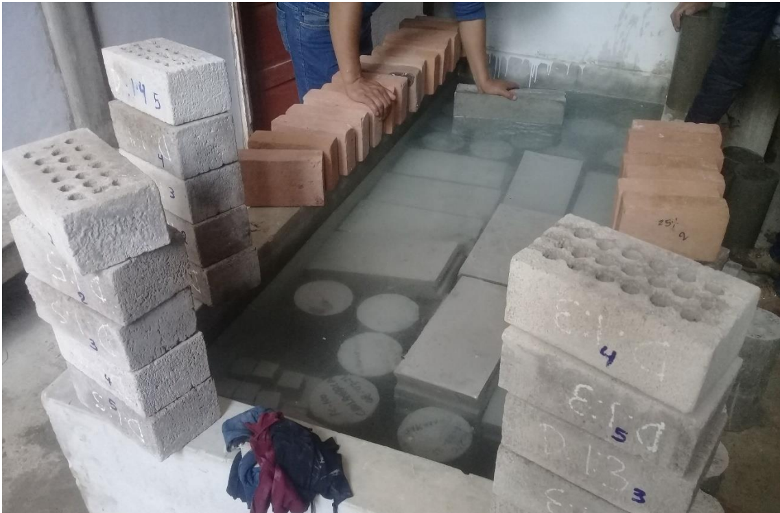
Fotografía 21. Ensayo de peso específico
