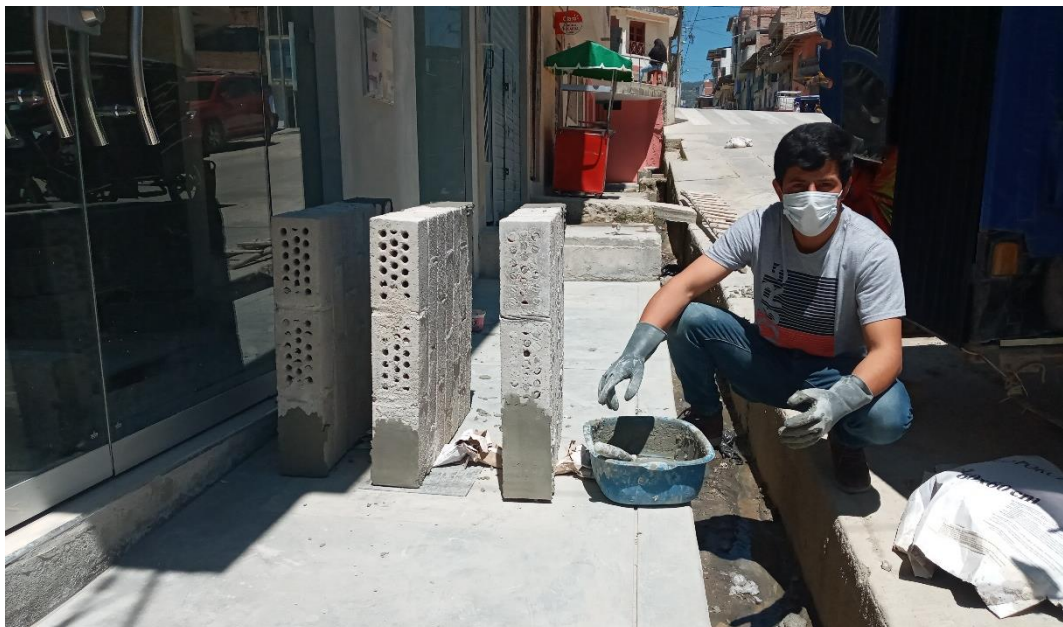
Elaboración de Muretes de Albañilería
