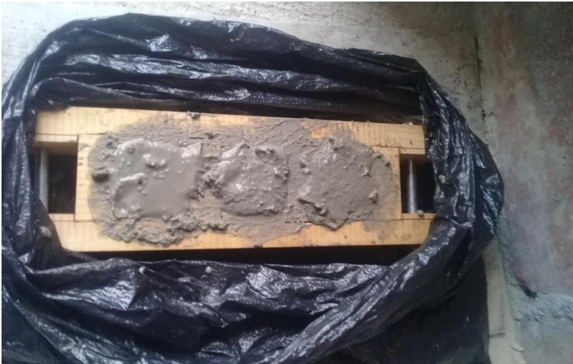
Fotografía 27. Ensayo de cubos de mortero de 50 mm
