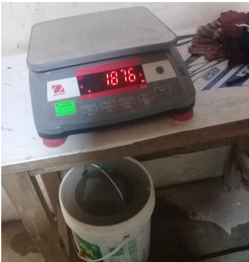
Fotografía 21. Ensayo de peso específico
