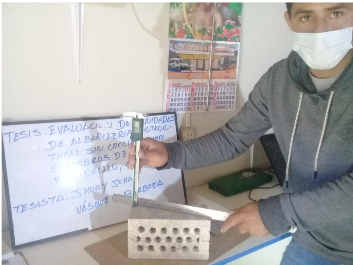
Fotografía 19. Ensayo de alabeo
