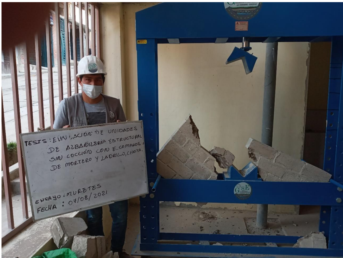
Fotografía 33. Rotura de muretes
