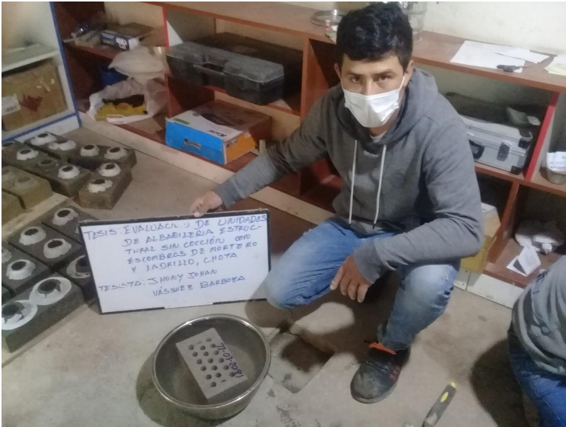
Fotografía 23. Ensayo de porcentaje de vacíos
