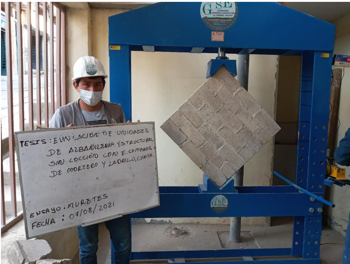
Fotografía 31. Ensayo de corte diagonal en muretes
