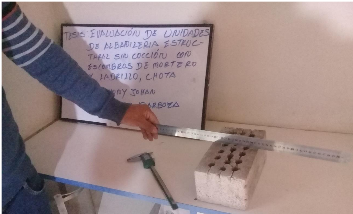
Fotografía 19. Ensayo de alabeo
