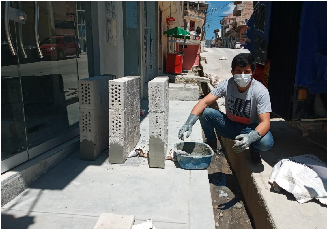
Fotografía 31. Ensayo de corte diagonal en muretes
