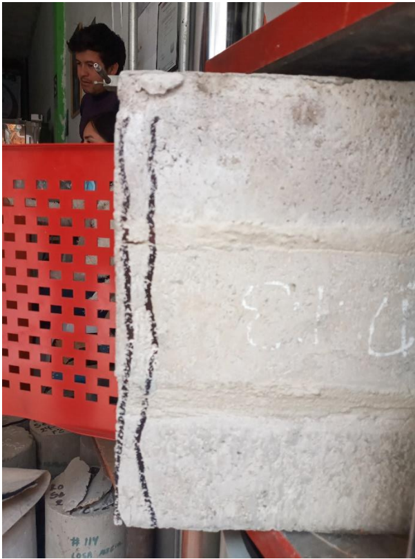
Fotografía 33. Rotura de muretes
