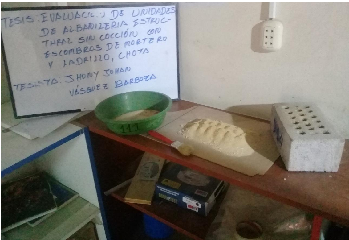
Fotografía 23. Ensayo de porcentaje de vacíos
