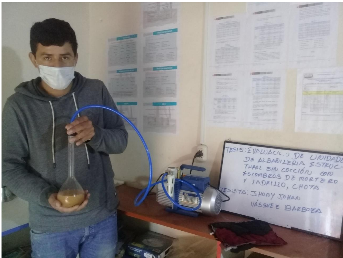
Fotografía 6. Ensayo de peso específico y absorción
