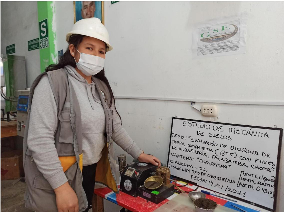
Fotografía 20. Ensayo de límite líquido, suelo de la cantera La Laguna
