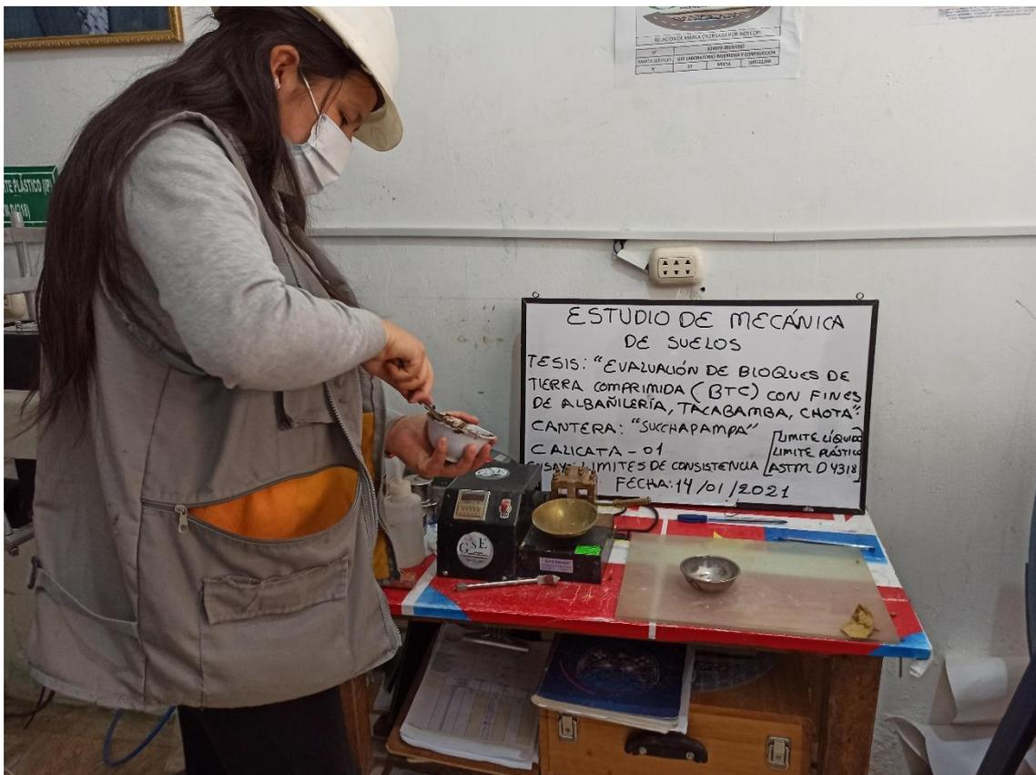
Fotografía 22. Ensayo de límite plástico, suelo de la cantera Cumpampa
