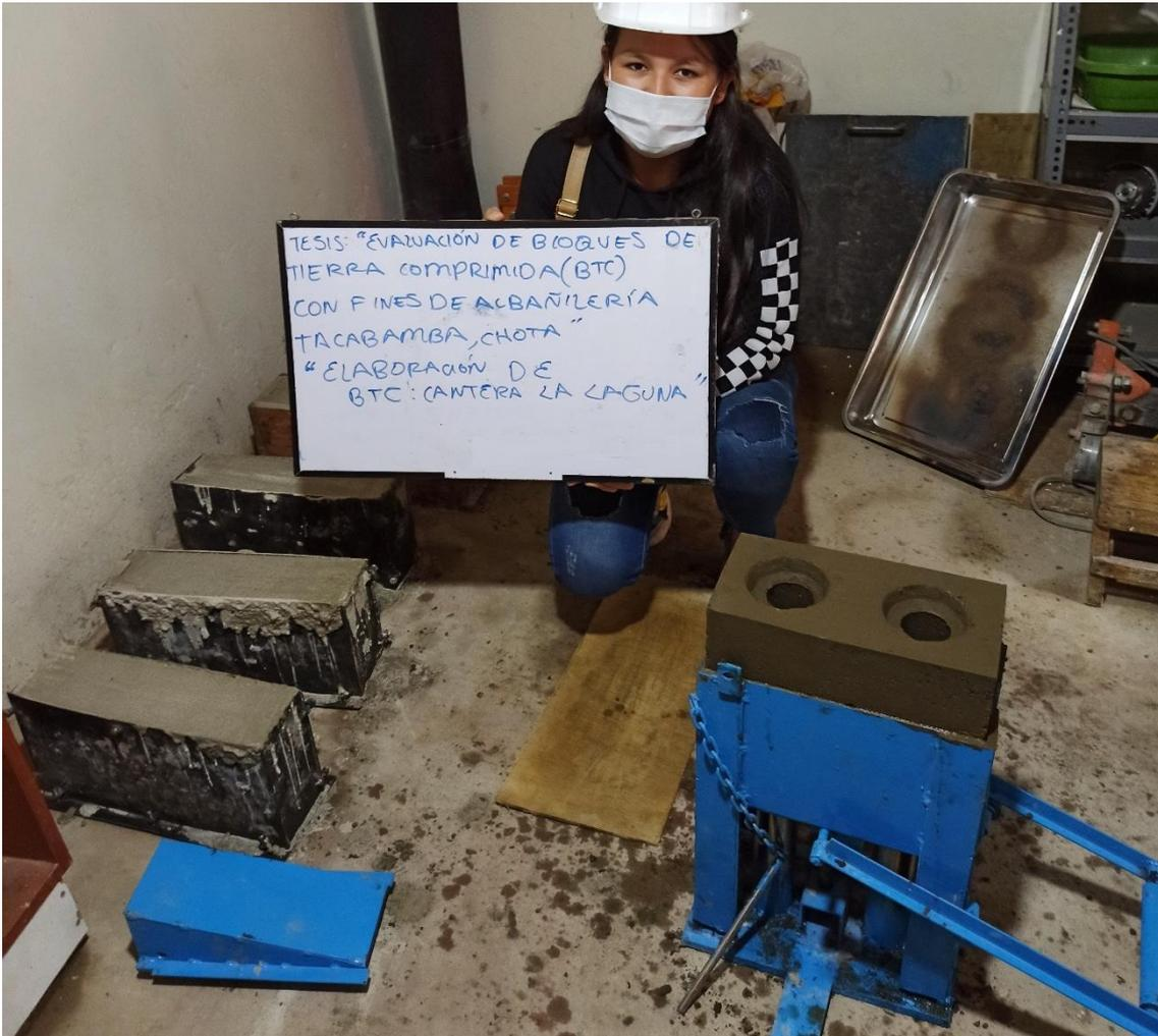
Fotografía 30. Secado de los BTC elaborados con suelo de la cantera La Laguna
