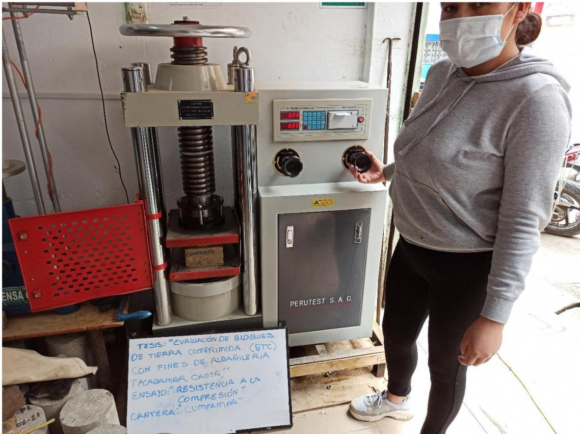
Fotografía 49. Resistencia a la compresión de los BTC La Laguna
