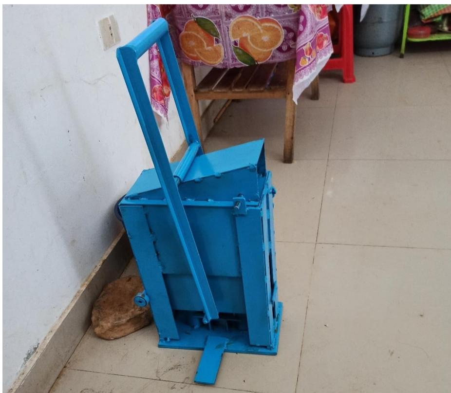
Fotografía 25. Proceso de elaboración de BTC con suelo de la cantera Succhapampa
