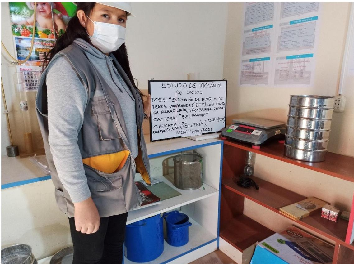
Fotografía 16. Ensayo de granulometría, suelo de la cantera Cumpampa
