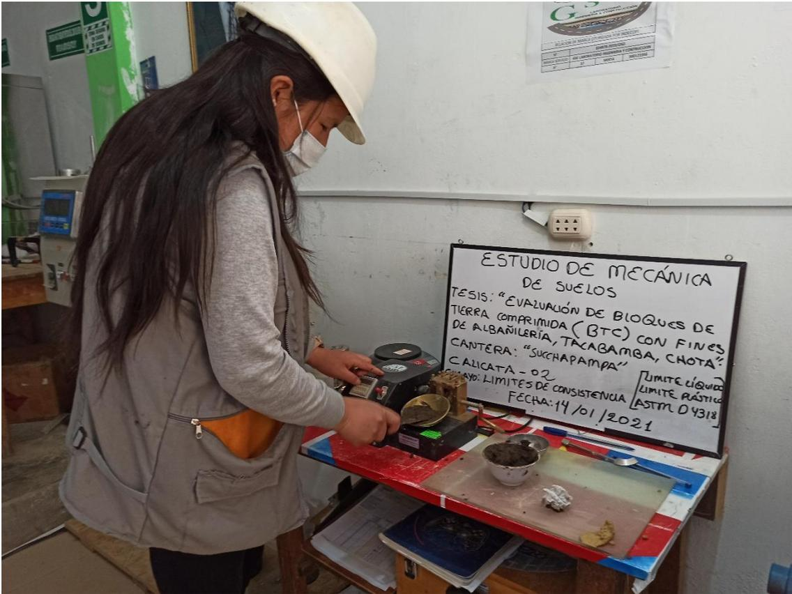
Fotografía 19. Ensayo de límite líquido, suelo de la cantera Cumpampa
