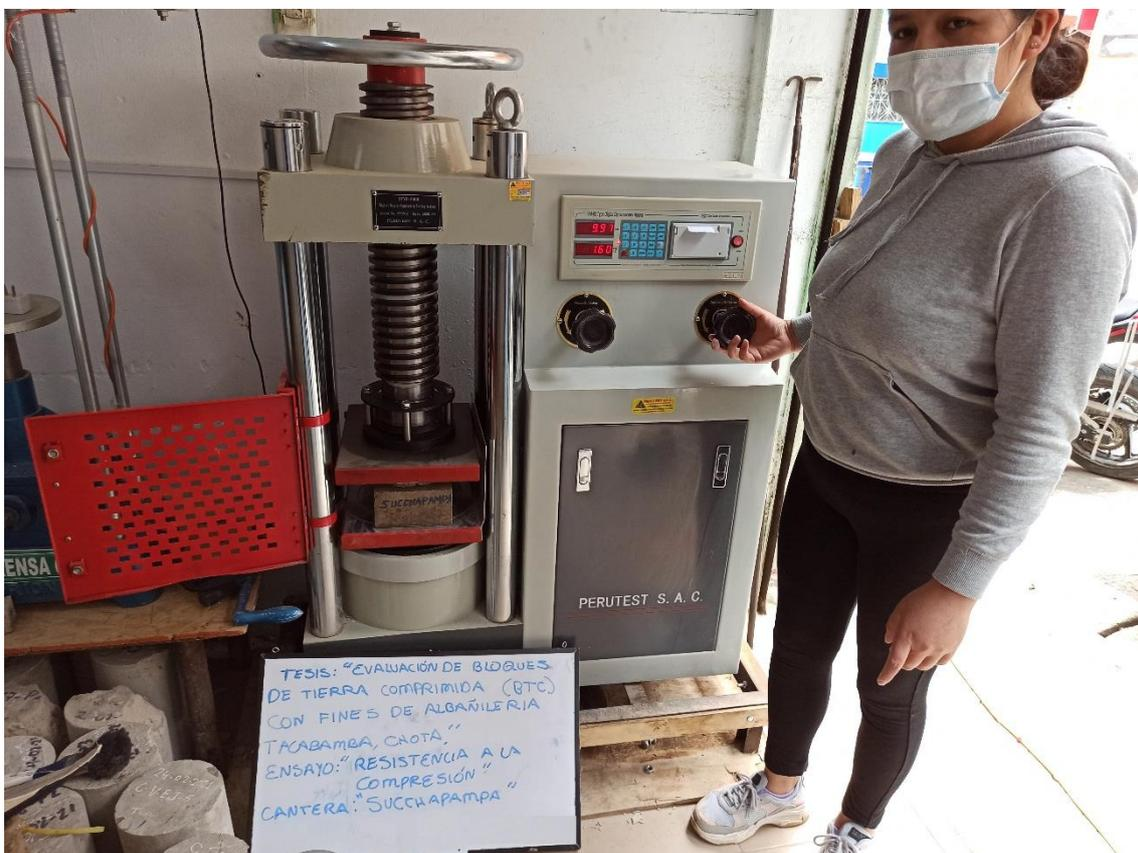
Fotografía 48. Resistencia a la compresión de los BTC, cantera Cumpampa
