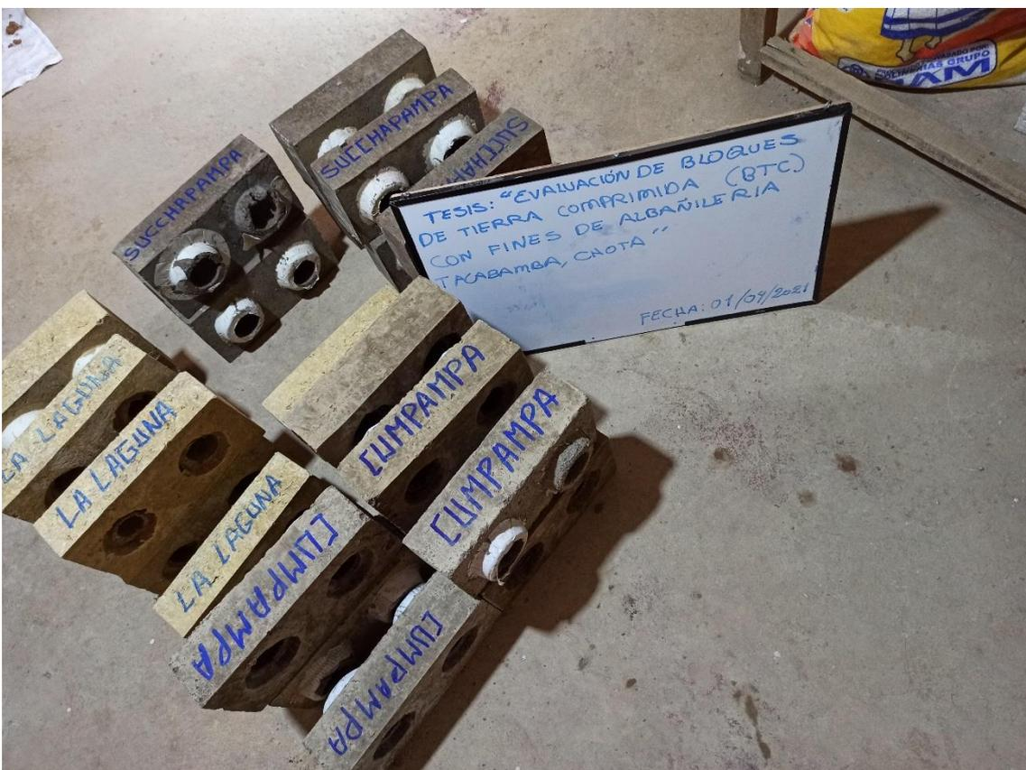
Fotografía 29. Proceso de elaboración de BTC con suelo de la cantera La Laguna
