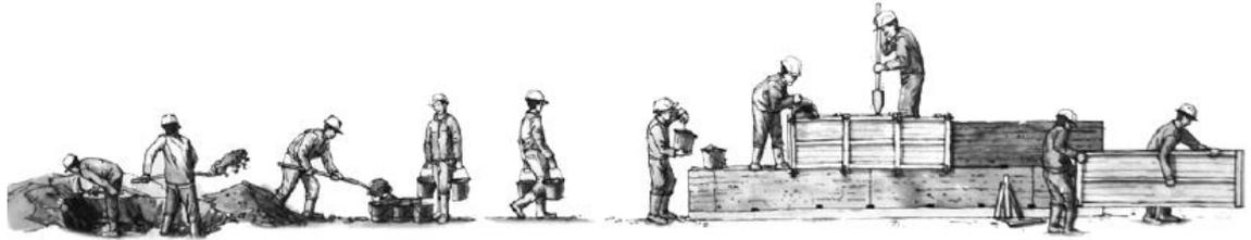
Se extrae la tierra del solar, se mezclan con tierra húmeda y polvorienta, se vierten en el encofrado.
