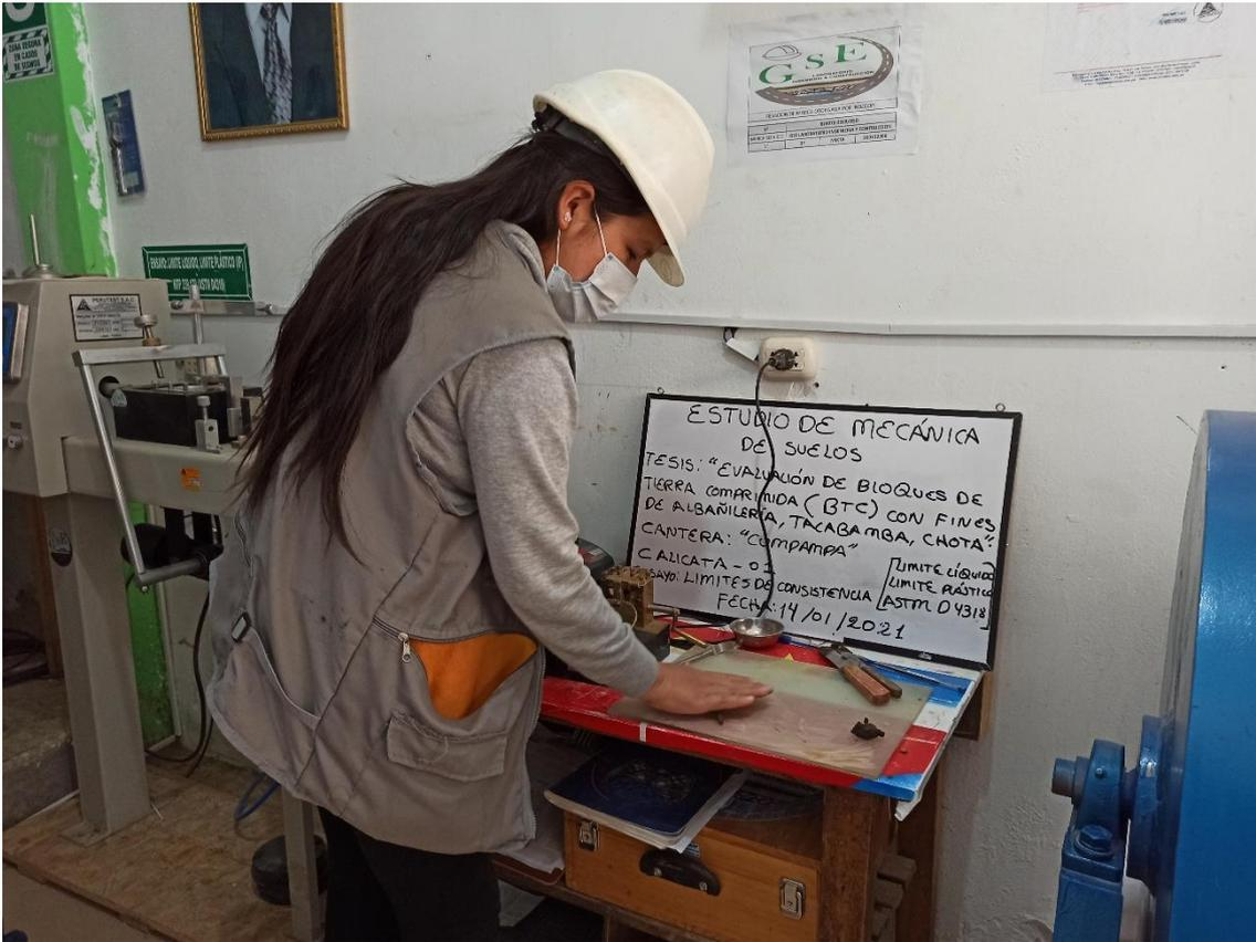
Fotografía 23. Ensayo de límite plástico, suelo de la cantera La Laguna
