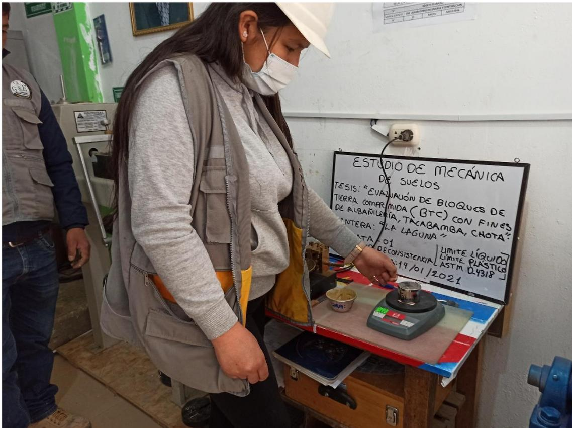
Fotografía 21. Ensayo de límite plástico, suelo de la cantera Succhapampa
