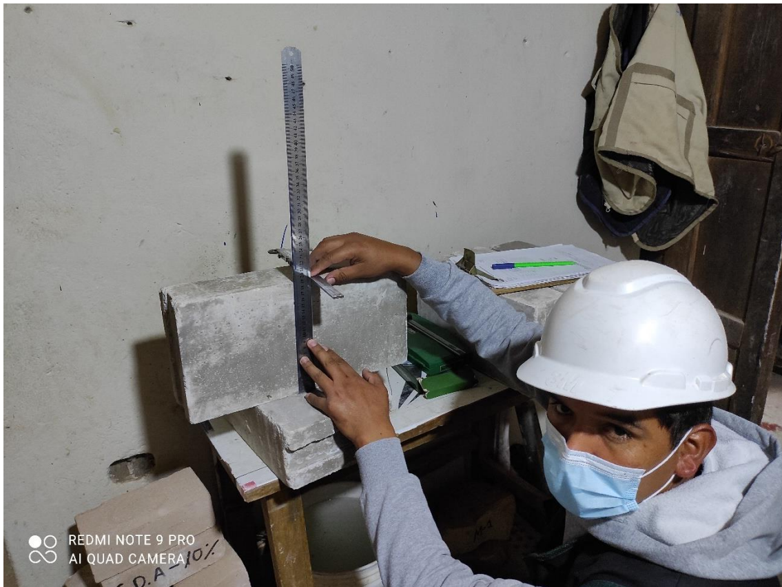
Fotografía 10. Ensayo de variación dimensional en bloques de concreto
