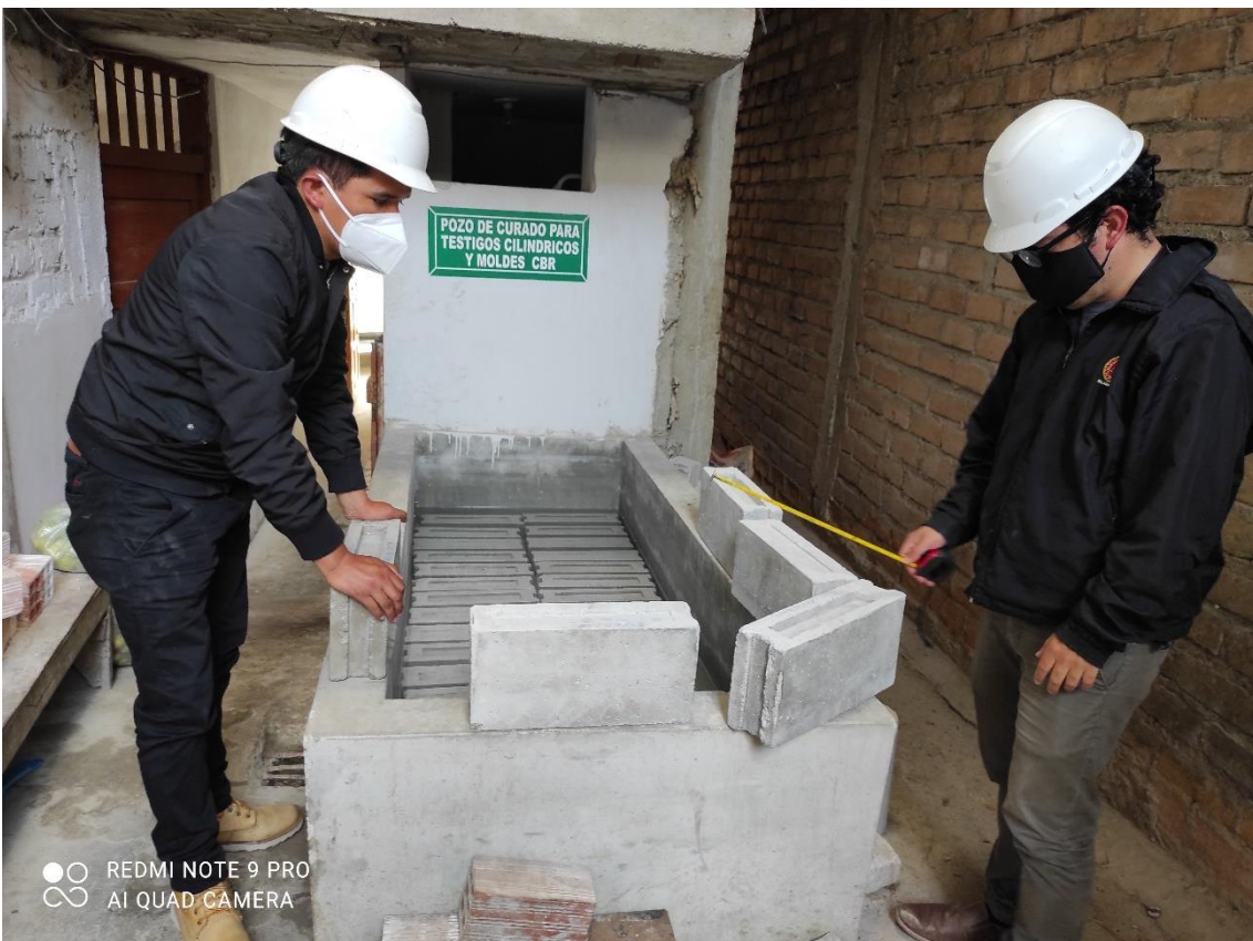
Fotografía 8. Curado de los bloques de concreto con perlas de poliestireno expandido
