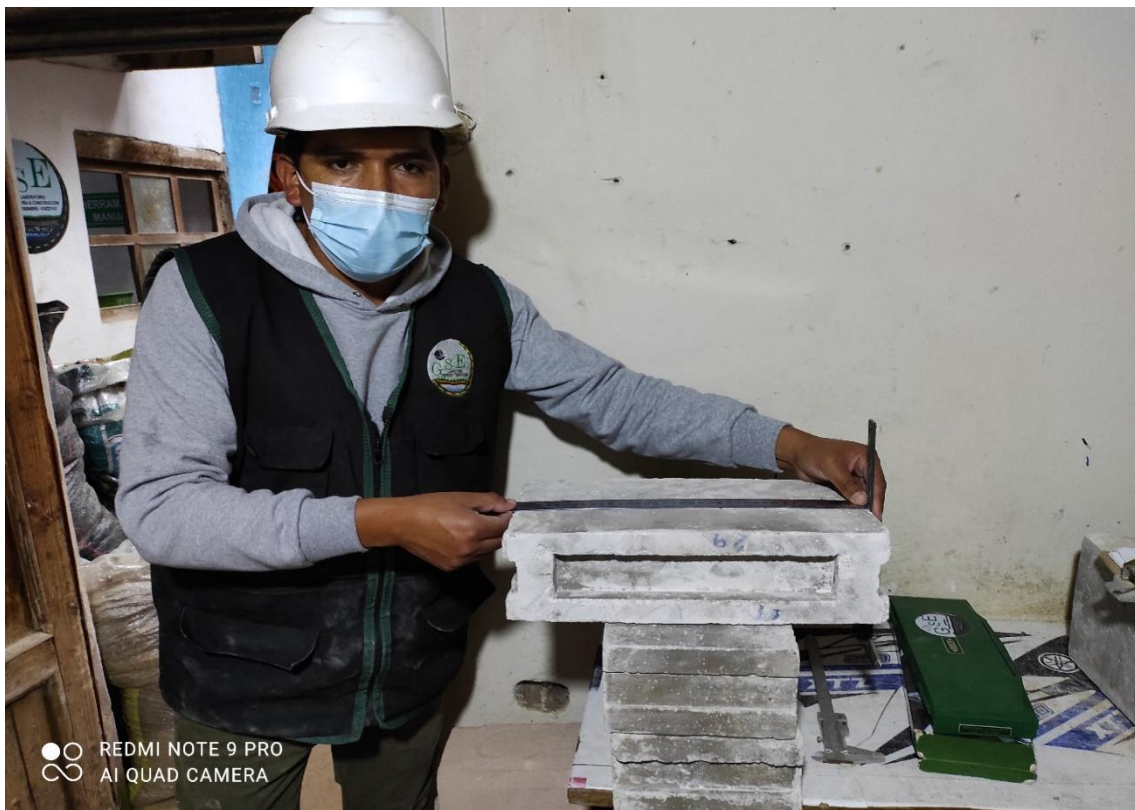
Fotografía 10. Ensayo de variación dimensional en bloques de concreto
