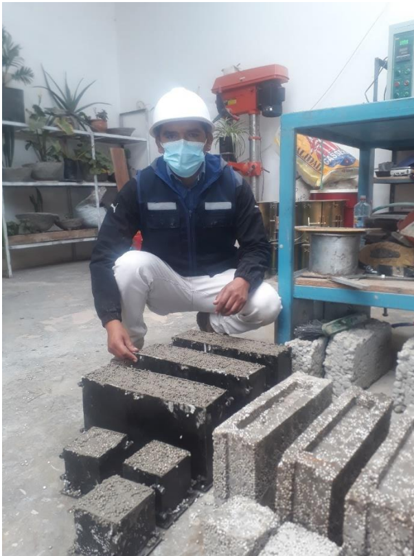
Fotografía 8. Curado de los bloques de concreto con perlas de poliestireno expandido
