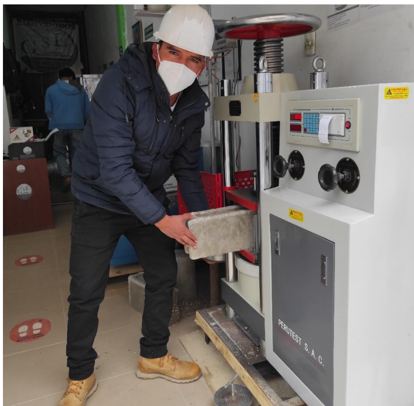
Fotografía 12. Ensayo de resistencia a compresión en unidad de albañilería de concreto
