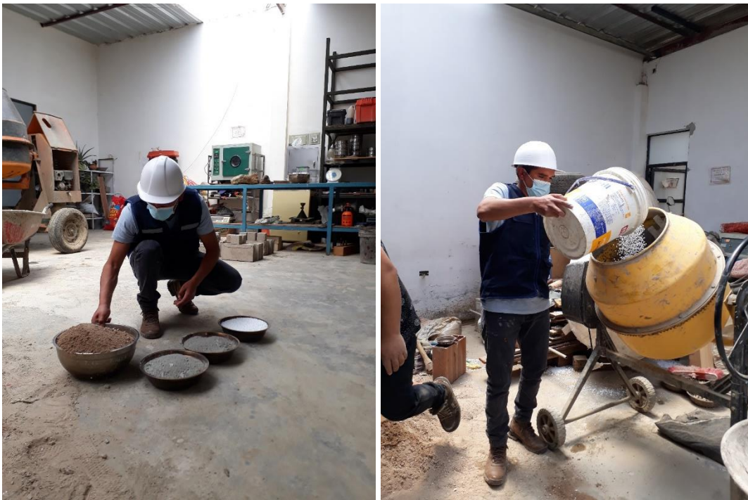
Fotografía 3. Materiales utilizados en la elaboración de la mezcla de concreto con perlas de poliestireno expandido
