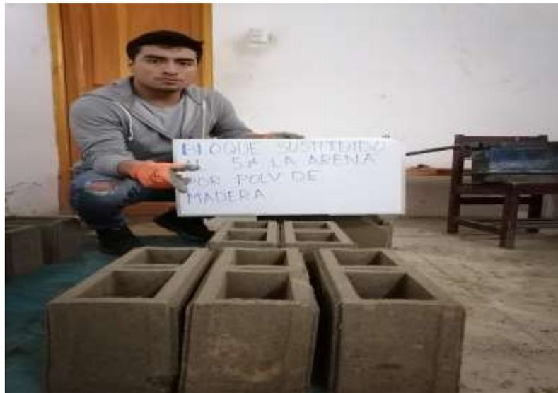
*Nota: Bloques con 5 % de sustitución de P.M. (2021).*
