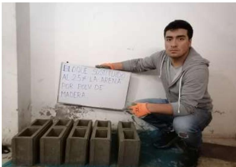
*Nota: Bloques con 2.5 % de sustitución de P.M. (2021).*
