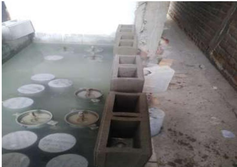
*Nota: puestos a curar después de 24 horas de desmoldados (2020).*
