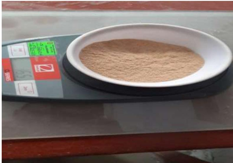
Nota: para el contenido de humedad se debe secar la muestra durante 24 horas (2021).
