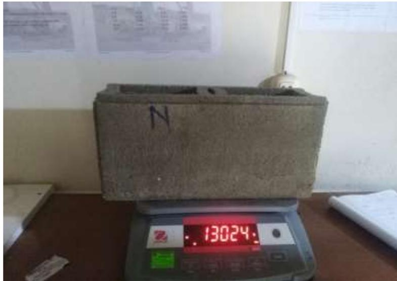
*Nota: Peso de los bloques con 0% sustitución de P.M. (2021).*
