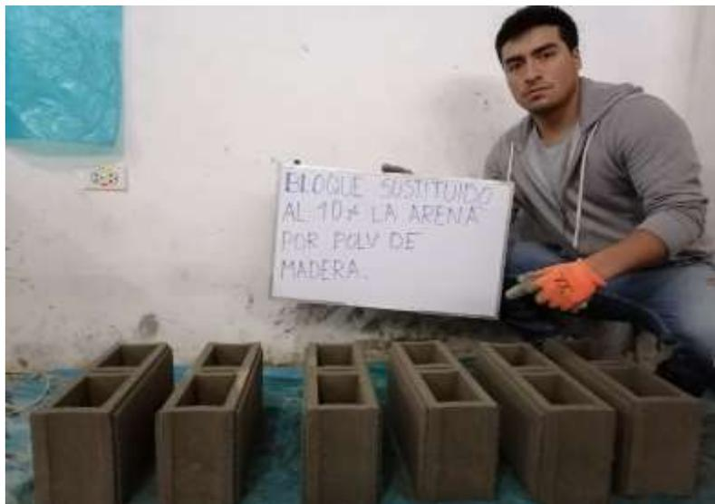
*Nota: Bloques con 10 % de sustitución de P.M. (2021).*
