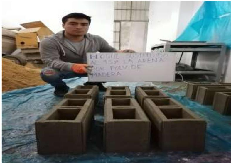
*Nota: Bloques con 15 % de sustitución de P.M. (2021).*
