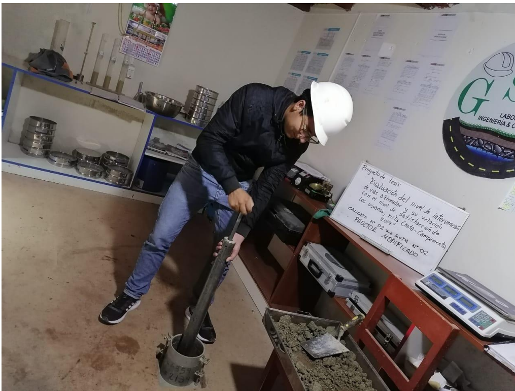
Figura 16. Ensayo de Proctor Modificado
