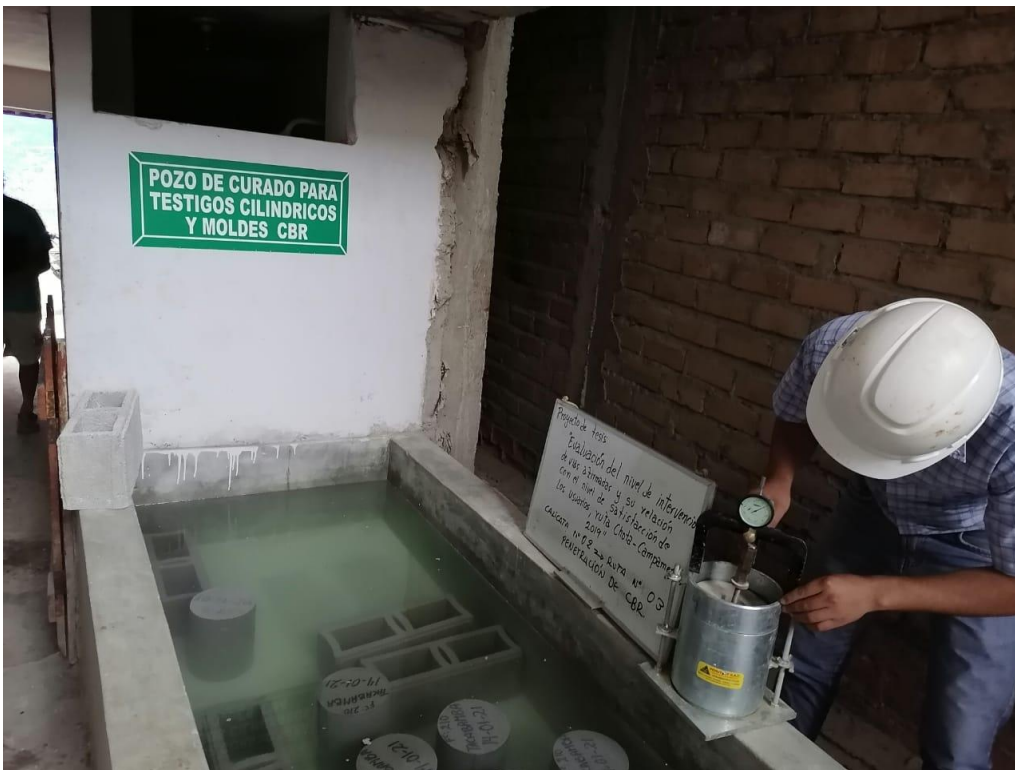
Figura 18. Preparación de Especímenes para Ensayo de Hinchamiento
