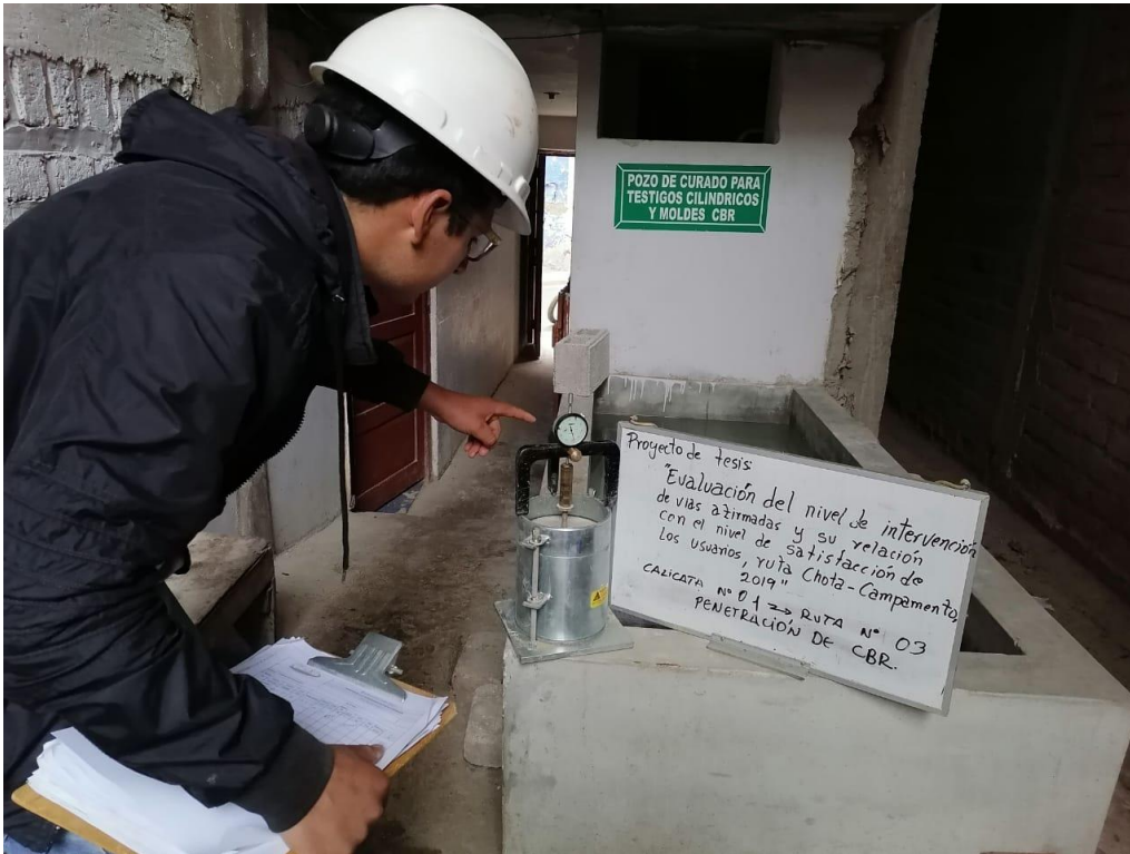
Figura 17. Preparación de Especímenes para Ensayo CBR
