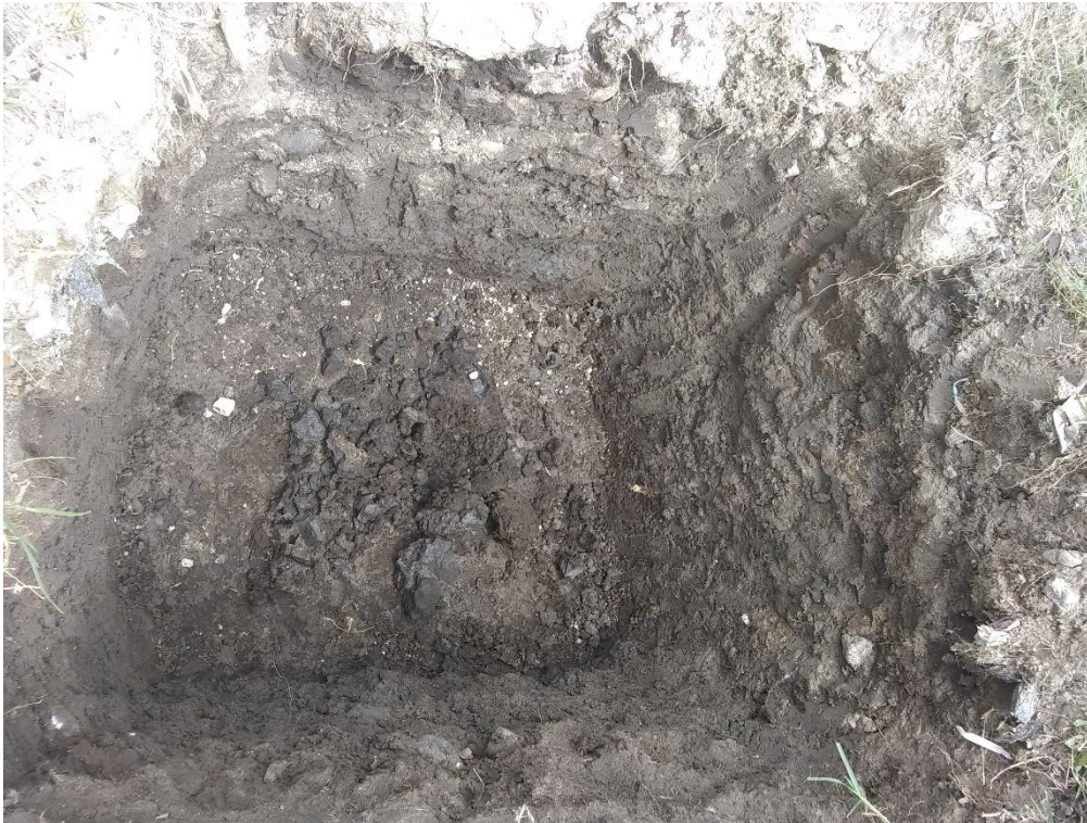
Figura 11. Muestreo de Suelos Calicata 3 Ruta 2 Chota – Campamento
