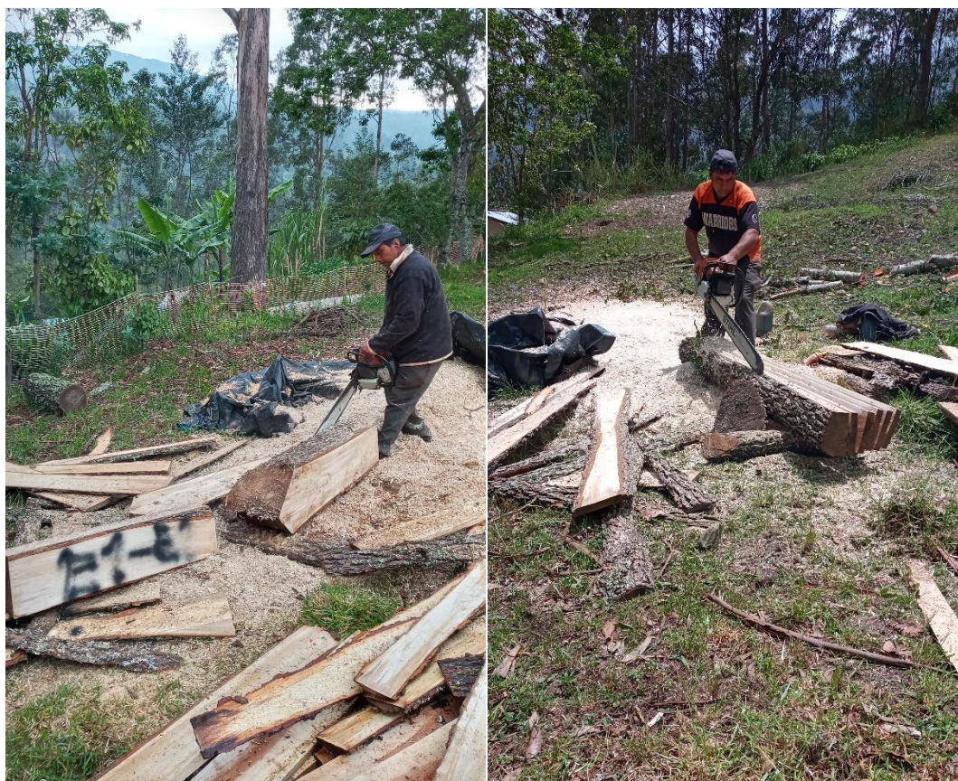
Fotografía 2. Proceso de aserrado de la madera sauce
