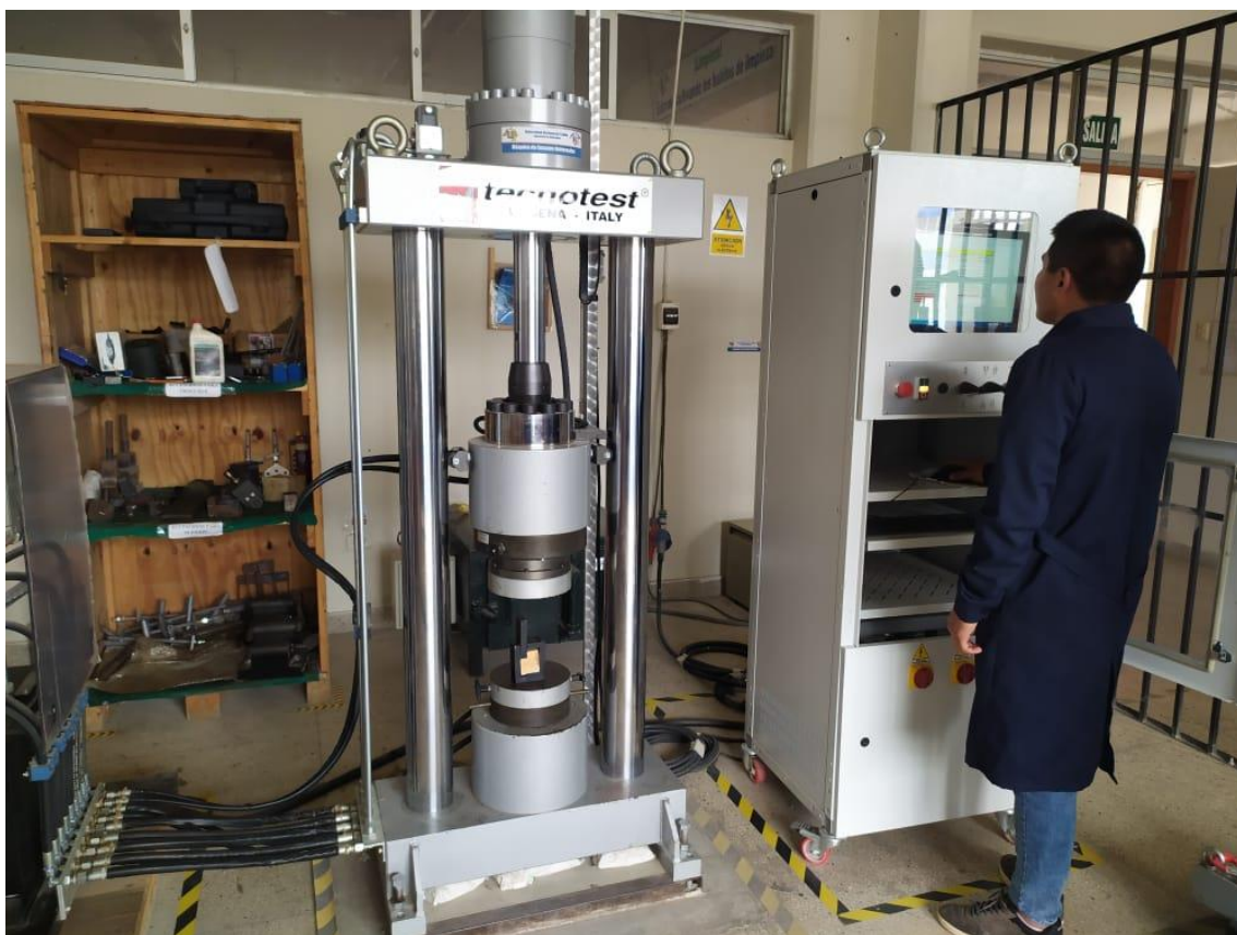
Fotografía 6. Realización de ensayos de laboratorio para madera en la Universidad Nacional de Trujillo
