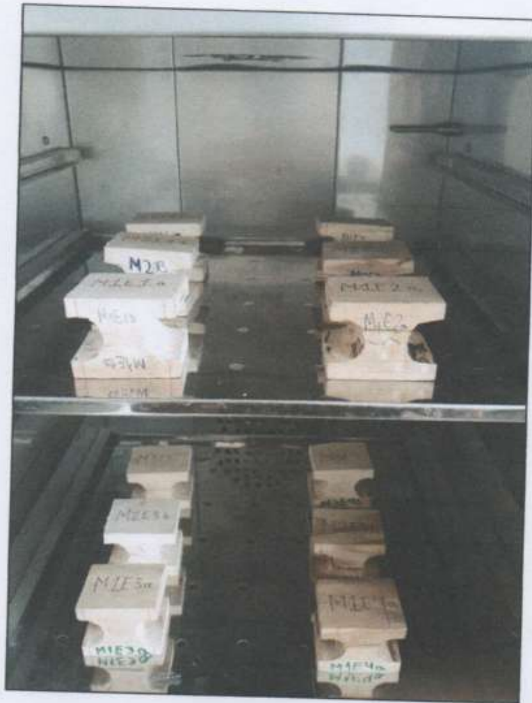
FIGURA N°20: Secado de las probetas según NTP. 251.010
