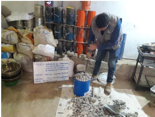
Ensayo peso unitario compactado del Ag. Grueso (Chuyabamba).
