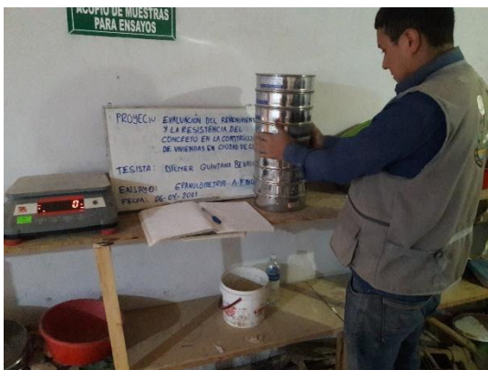
Ensayo de granulometría Ag. Fino en GSE laboratorio y construcción.
