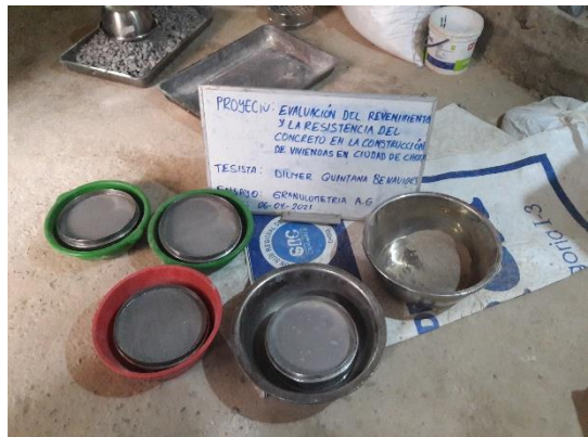
Ensayo granulometría de Ag. Grueso en GSE laboratorio y construcción.
