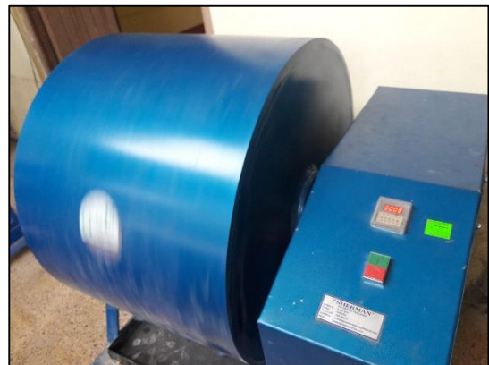
Abración del agregado grueso con la maquina de los angeles.
