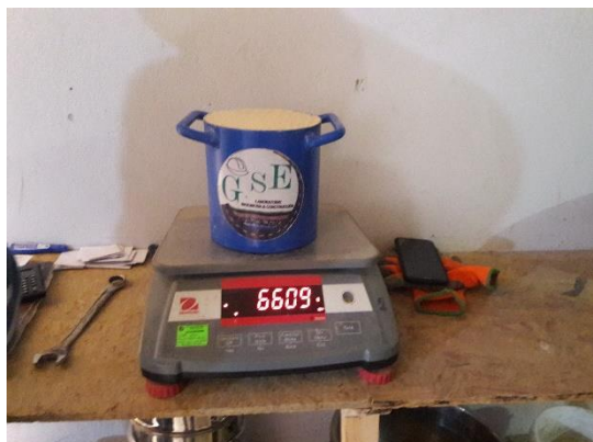
Ensayo peso unitario suelto Ag. Fino (Conchan).
