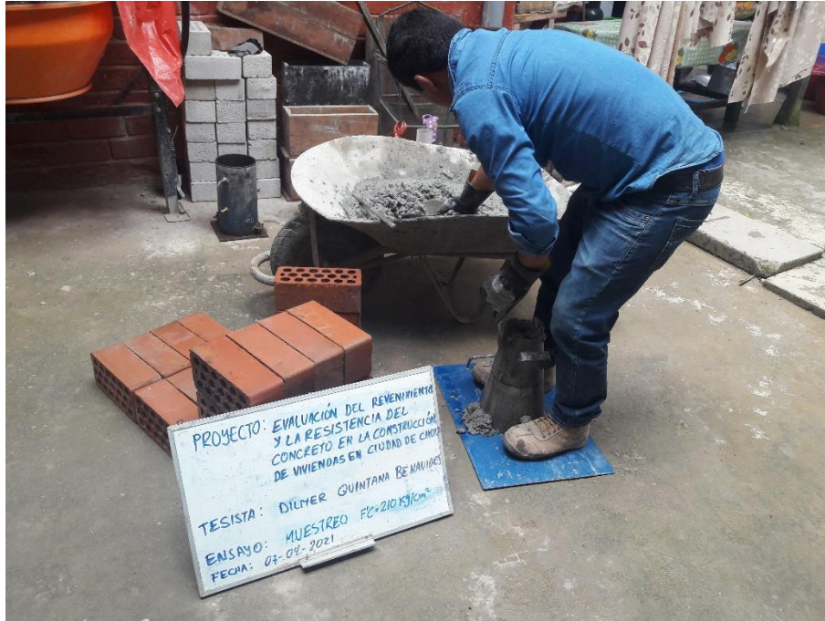
Proceso de ensayo de revenimiento del concreto del diseño de mezcla
