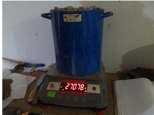
Ensayo peso unitario suelto Ag. Grueso (Chuyabamba).
