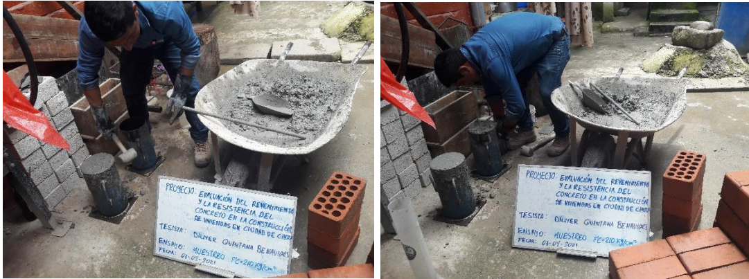
Moldeo de probetas con mezcla de diseño de mezcla.
