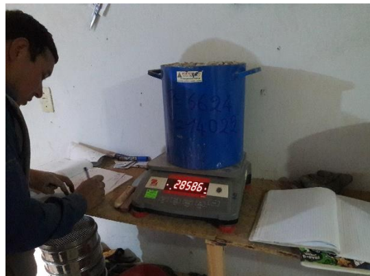
Ensayo peso unitario compactado del Ag. Grueso (Chuyabamba).
