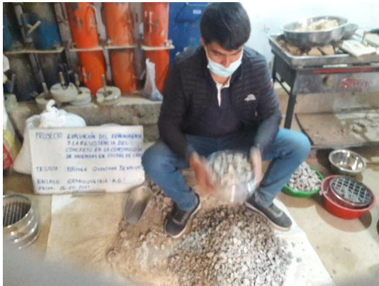
Ensayo granulometría de Ag. Grueso en GSE laboratorio y construcción.
