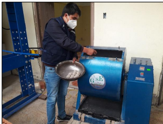
Abración del agregado grueso con la maquina de los angeles.
