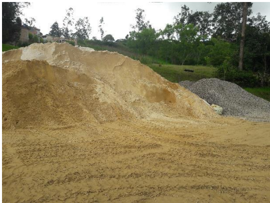
Agregados utilizados para diseño de mezcla Ag. Fino (Conchan), Ag. Grueso (Chuyabamba) almacén de distribuidores en Chota.
