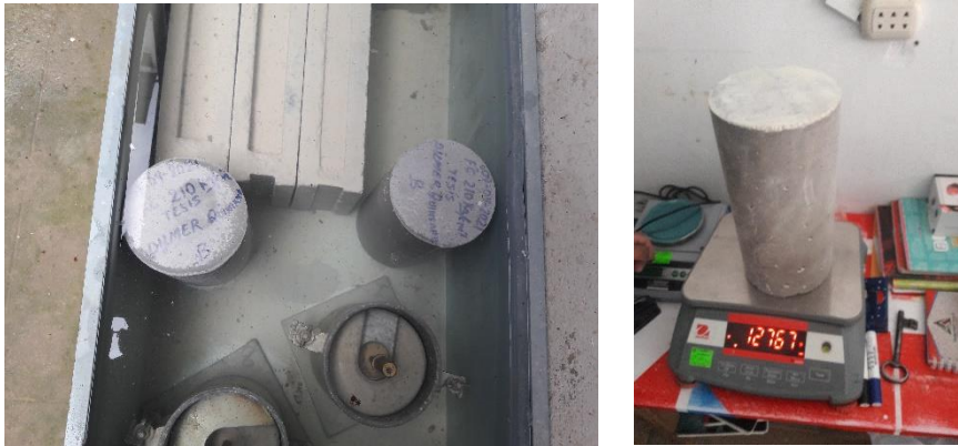
Curado de probetas de diseño de mezcla y pesado de probeta para el ensayo
