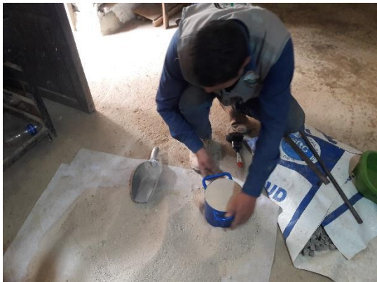
Ensayo peso unitario suelto Ag. Fino (Conchan).
