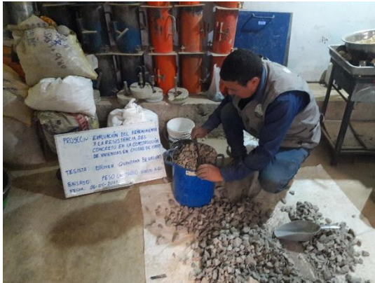
Ensayo peso unitario suelto Ag. Grueso (Chuyabamba).
