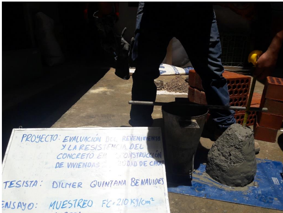
Asentamiento del concreto elaborado a través de diseño de mezcla.
