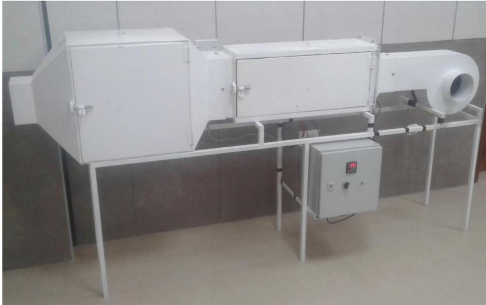
**Imagen 20.** Deshidratador por aire forzado instalado.
