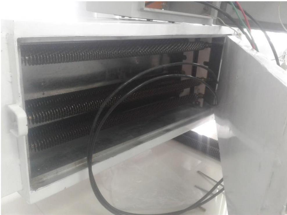
**Imagen 19.** Ensamblaje de las resistencias del deshidratador.
