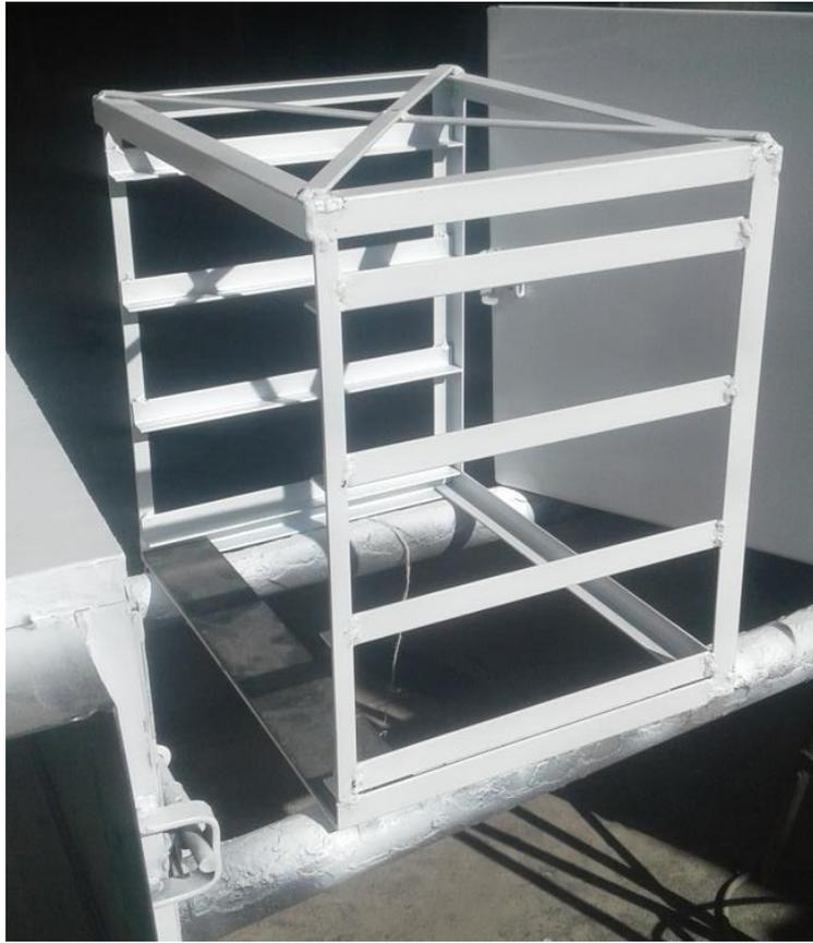
**Imagen 18,** Soporte de bandejas del deshidratador.
