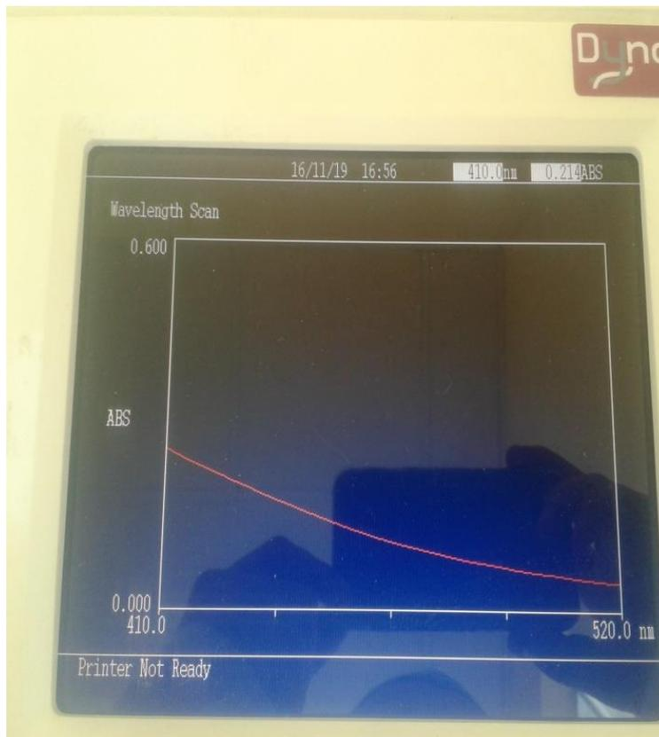
**Imagen 13.** Curva de absorción de un Espectrofotómetro UV, con longitud de onda de 410 a 520 nm.
