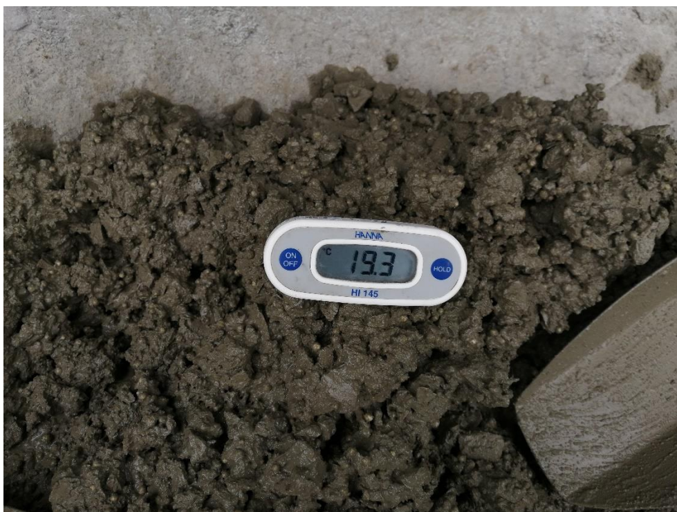
Fotografía 7. Medición de la temperatura en la mezcla de concreto con poliestireno
