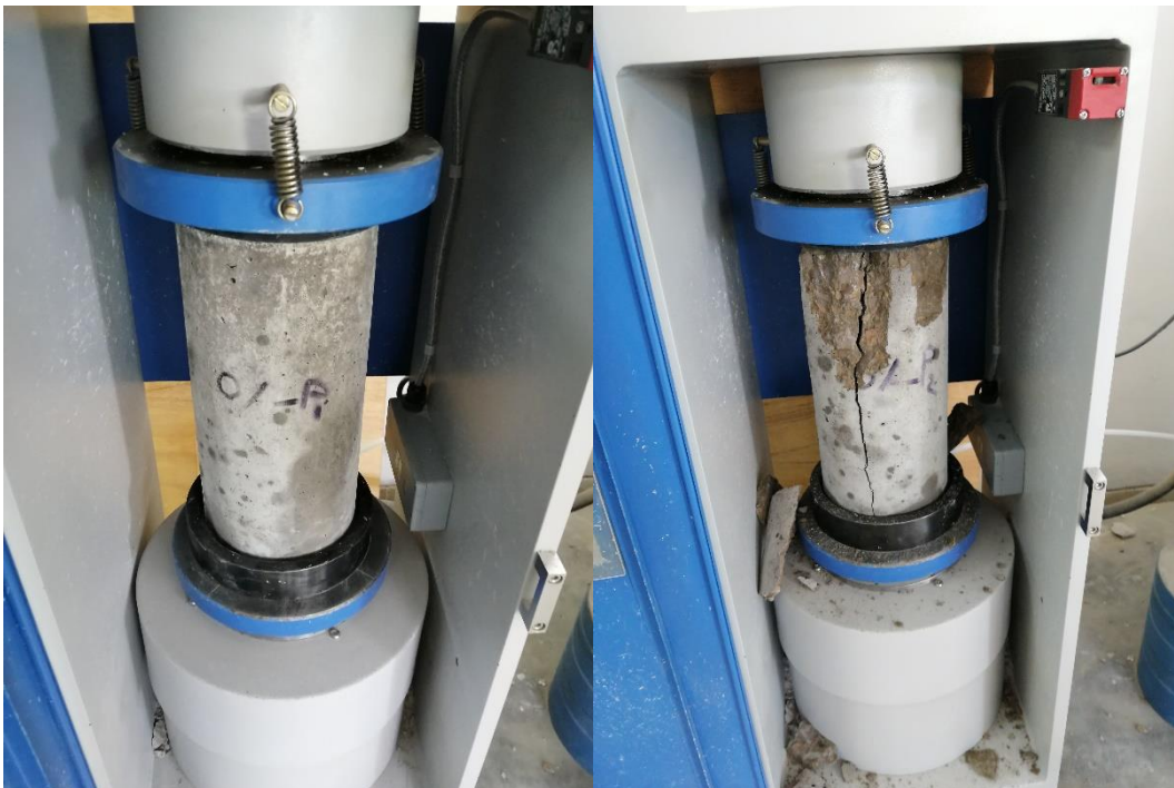
Fotografía 10. Ruptura de probetas cilíndricas a compresión
