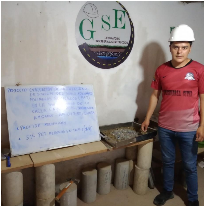
Fotografía 12. Ensayo CBR en el suelo con polímeros reciclados PET
