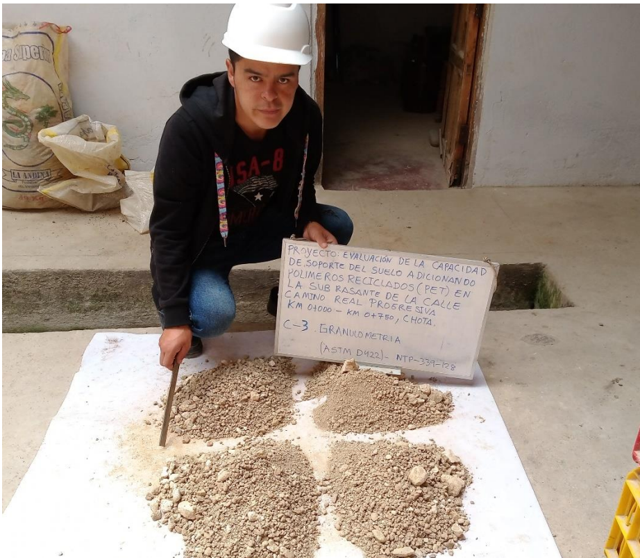
Fotografía 4. Ensayo granulométrico en las muestras de suelo
