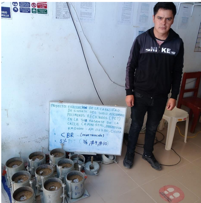
Fotografía 12. Ensayo CBR en el suelo con polímeros reciclados PET
