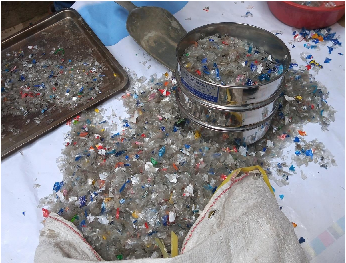
Fotografía 10. Gradaciones de polímeros reciclados PET
