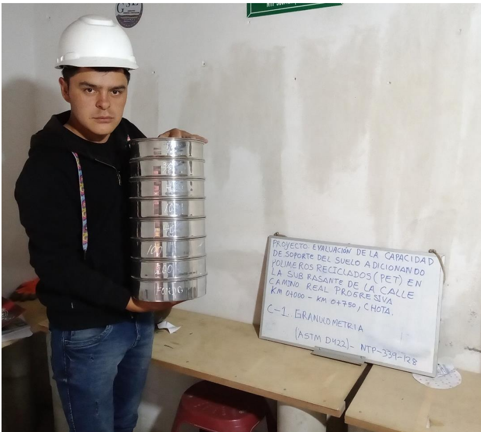
Fotografía 4. Ensayo granulométrico en las muestras de suelo
