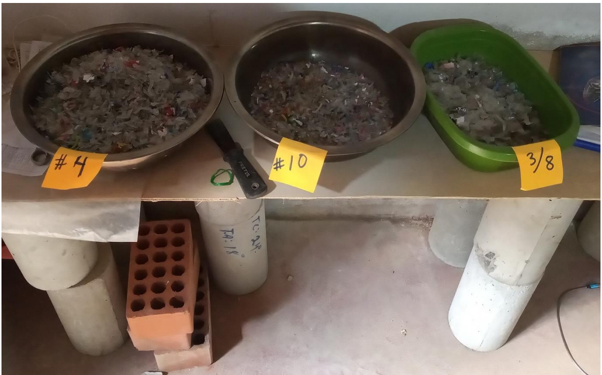
Fotografía 10. Gradaciones de polímeros reciclados PET
