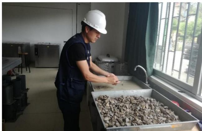
*Nota:* El agregado solo debe tener la superficie seca luego del secado con una franela (2019).
