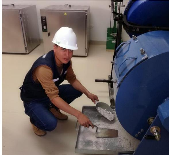
*Nota: Se realizó mediante el método B con 11 esferas (2019).*
