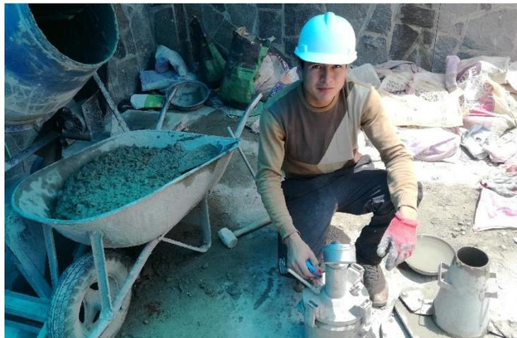
*Nota: ensayo para la obtención del contenido de aire (2019).*
