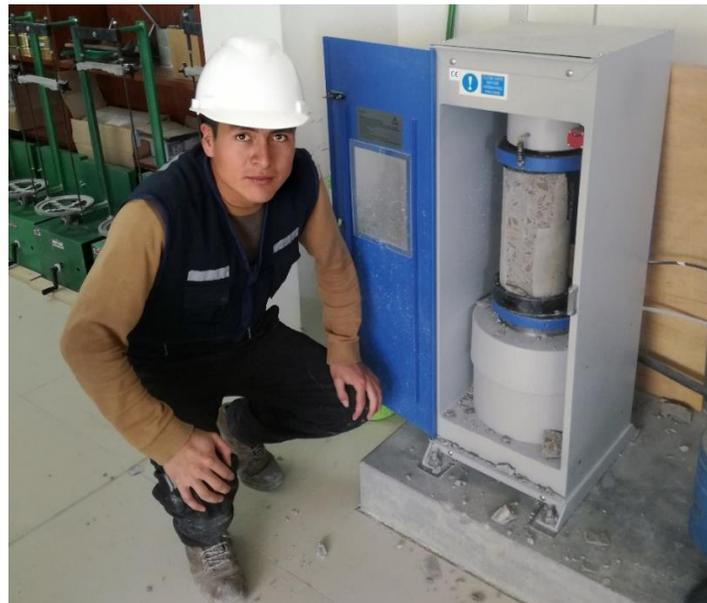
Nota: La carga debe ser distribuida en toda el área de la probeta (2019).
