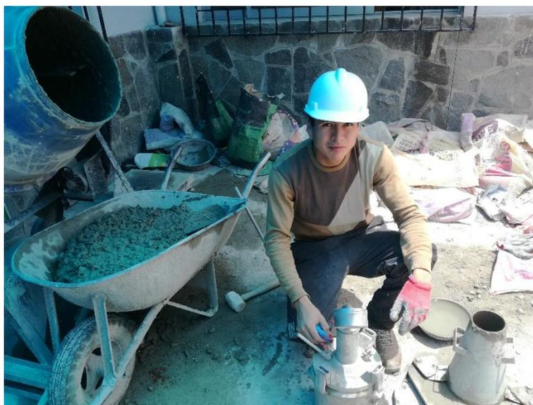
*Nota:* Llenado de agua con la pipeta para determinar el contenido de aire (2019).
