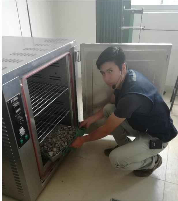
*Nota: Colocación de la muestra al horno (2019).*
