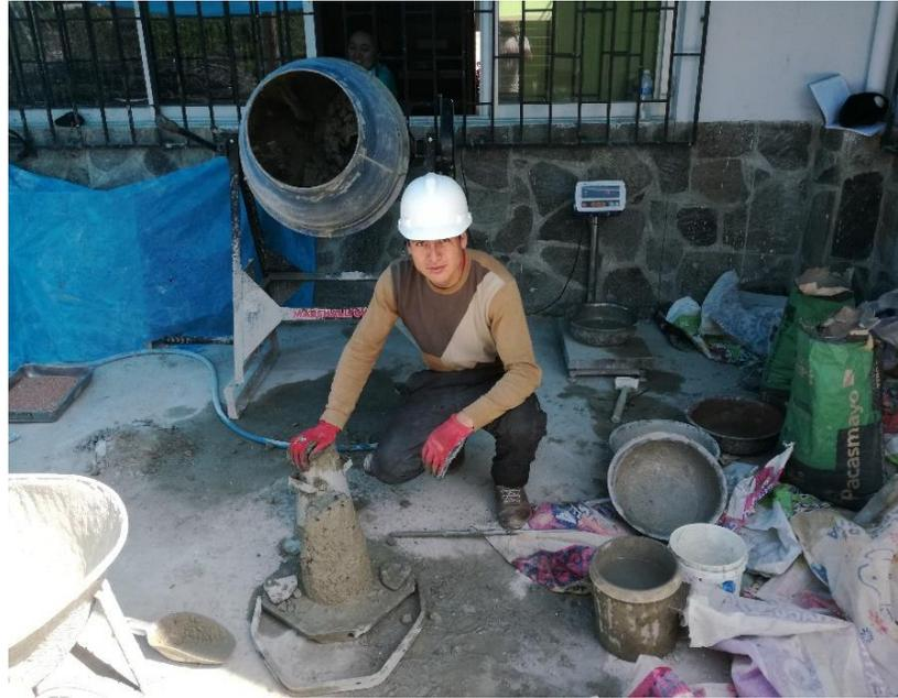
*Nota:* Extracción del cono para la respectiva medición de asentamiento (2019).
