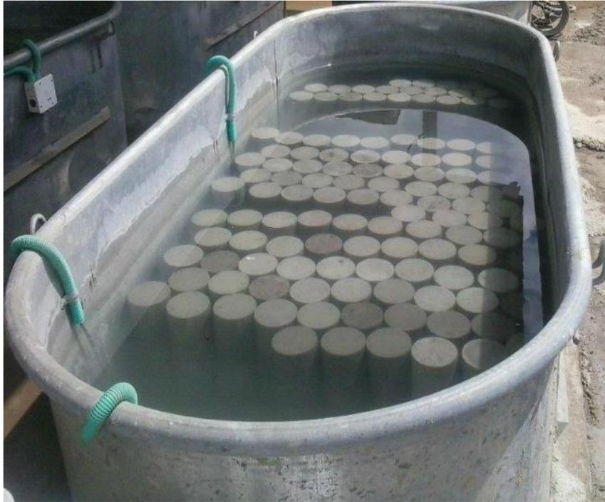
*Nota: Curado de las probetas luego del desencofrado (2019).*
