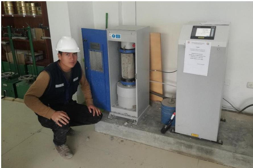
Nota: La carga debe ser distribuida en toda el área de la probeta (2019).
