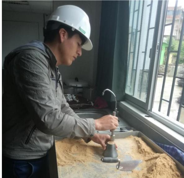
*Nota: Ensayo con el cono y pisón previo al ensayo de peso específico y absorción (2019).*
