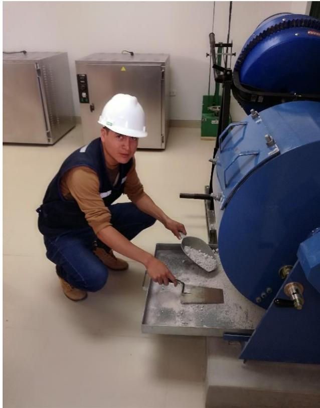
*Nota:* Extracción del agregado grueso de la Máquina de los Ángeles (2019).
