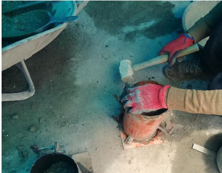
*Nota:* Desmolde de probetas (2019).
